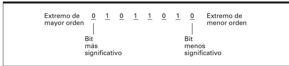
Figura 1.7 Organización de una celda de memoria de un byte.
