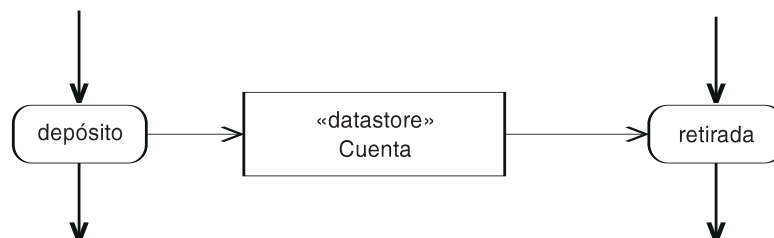
Figura 14.191 Nodo almacén de datos
