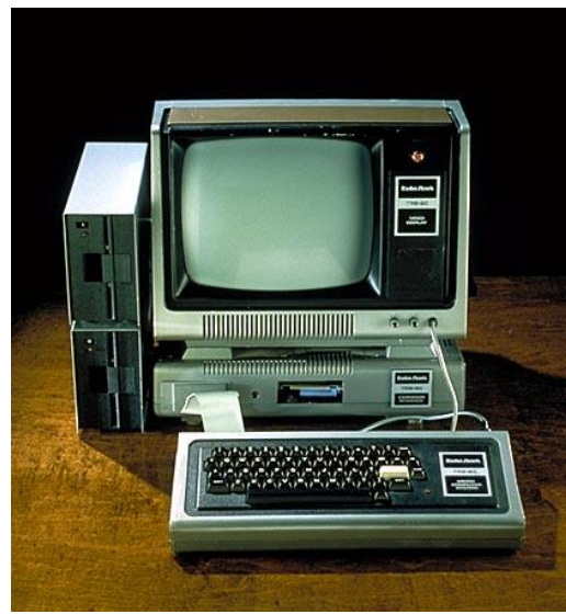
Computadora Tandy TRS-80 de finales de la década de 1970; utilizaba un microprocesador Zilog Z-80 de 8 bits. (Cortesía Radio Shack).
