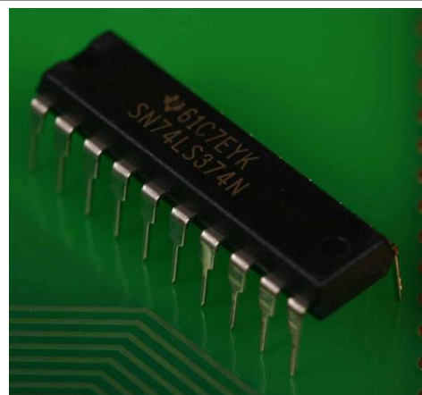
74LS374, chip adicional que se usará en las prácticas de comunicación.
