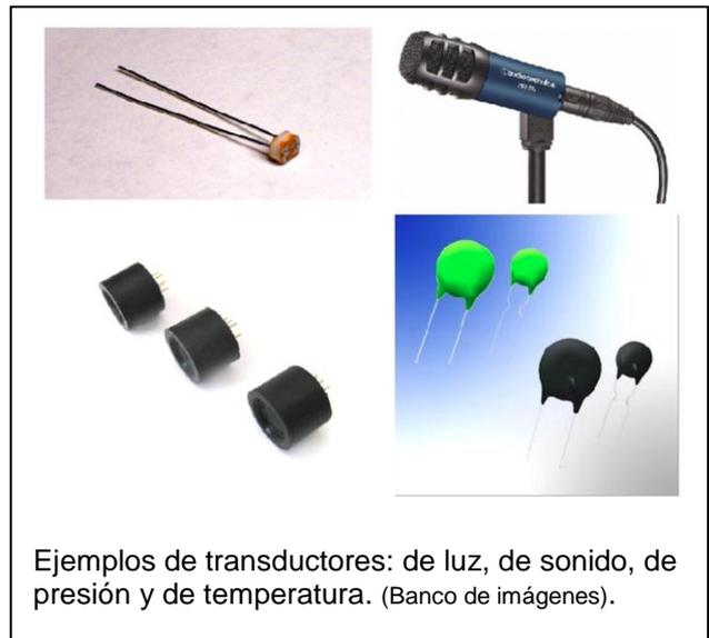
eléctrica que represente fielmente a ese sonido; en resumen, un transductor sirve para captar el fenómeno que se desea medir, y producir a su salida una señal eléctrica equivalente, misma que ya puede ser manejada como mejor convenga.
