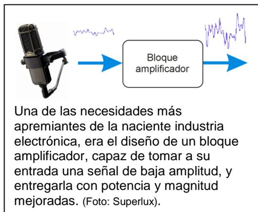
de proceso de audio. Cuando se recibe una estación de radio por medio de una antena, la magnitud de señal recibida también es minúscula, y es necesario amplificarla para poder finalmente captar el audio transmitido. Y como éstas, hay muchas más aplicaciones para un dispositivo capaz de amplificar una señal de entrada.
