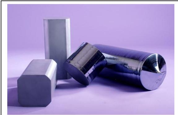
El silicio metálico normal (en lingotes) se comporta ligeramente distinto al silicio monocristalizado (en cilindros). (Foto: China Rectifier).
