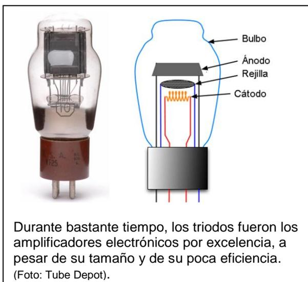
vacío o bulbos, específicamente uno denominado “triodo”. Estos dispositivos cumplían adecuadamente con su labor, pero tenían varios inconvenientes, como ser demasiado voluminosos y frágiles, además de gastar demasiada energía por la necesidad de contar con un filamento incandescente. Por
