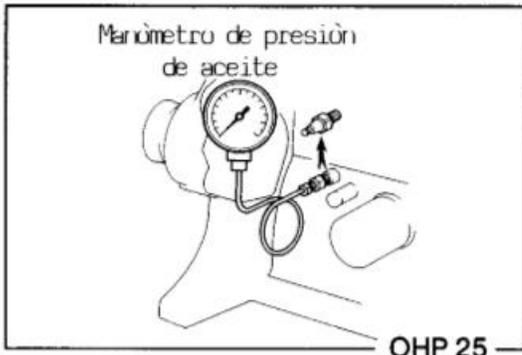
Al arrancar el motor nos encontraremos con una presión alta, ya que el aceite está frío y la bomba necesitará más potencia para moverlo. Una vez en marcha, el lubricante se calienta y resulta más sencillo moverlo, por lo que se reduce la presión en el manómetro de la bomba.
