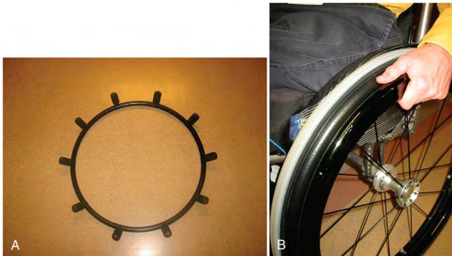
• **Figura 14.13** (A) Aro de propulsión con pivotes. (B) Aro de propulsión contorneado con gran área de superficie de agarre.
