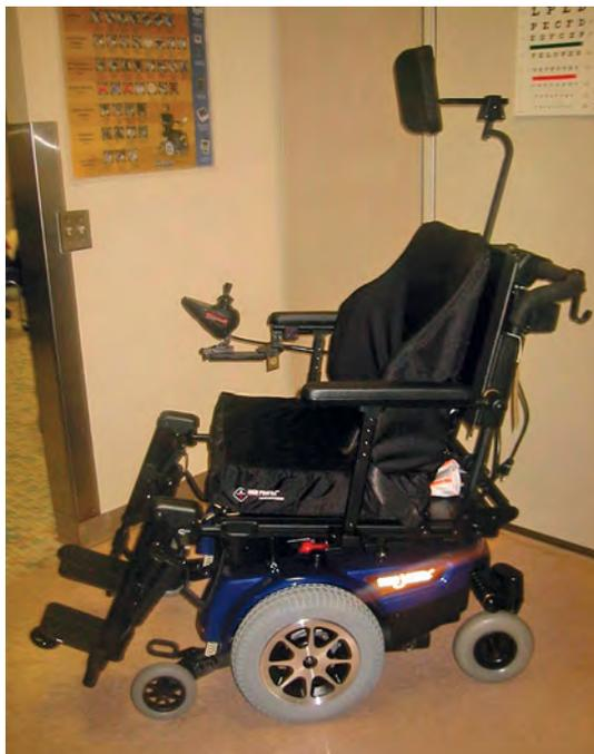
• **Figura 14.19** Se muestra la silla de ruedas eléctrica para interiores y exteriores con asiento de rehabilitación, un sistema de asiento de inclinación y reclinación eléctrico, reposacabezas y reposapiernas con elevación eléctrica.
