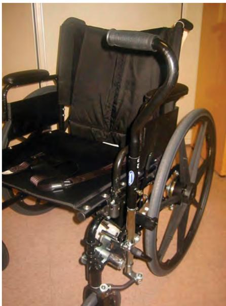
• **Figura 14.14** Sistema de propulsión de palanca de un brazo.
