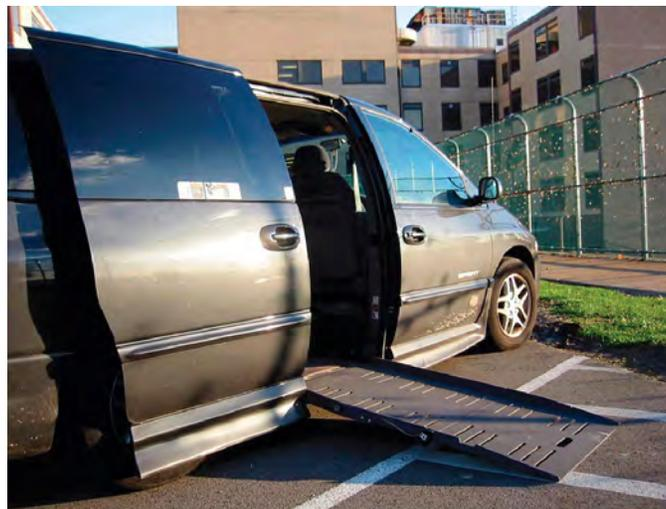
• **Figura 14.30** Monovolumen modificado con sistema de rampa motorizada.
