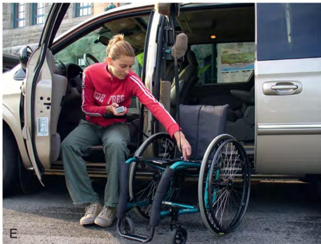
• **Figura 14.29 (Cont.) (E)** Sistema elevador de silla de ruedas superior de puerta lateral. (B, por cortesía de Braun Corp., Winamac, IN. C, por cortesía de St. Lambert, Quebec, Canadá.)
