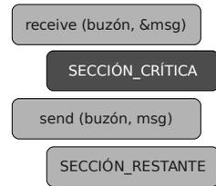
**Figura 3.6:** Mecanismo de exclusión mutua basado en el uso de paso de mensajes.
