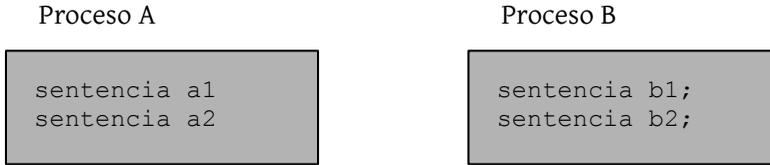
**Figura 2.18:** Patrón *rendezvous* para la sincronización de dos procesos en un determinado punto.
