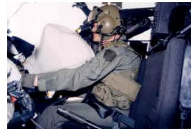
**Figura 1.21:** Probando un sistema de airbag en un helicóptero OH-58D (fuente Wikipedia).
