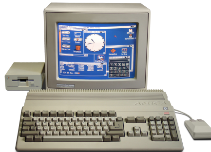
Figura 1.5: Commodore Amiga 500 (1987), la computadora más popular de la familia Amiga , con amplias capacidades multimedia y multitarea apropiativa; una verdadera maravilla para su momento (imagen de la Wikipedia: Amiga ).
