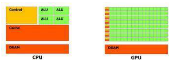
Figura 4.1: Arquitectura CPU vs Arquitectura GPU
