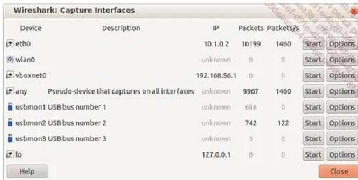
Para comenzar una captura, hay que hacer clic en el botón **Start** correspondiente a la tarjeta de red que se desea capturar. Para detener una captura, hay que ir a **Capture** y luego seleccionar **Stop**. Preste atención, una captura puede ocupar rápidamente bastante espacio en disco.
