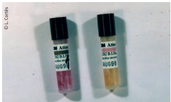
Imagen 2. A la derecha, espora esterilizada tras 12 h de cultivo. A la izquierda, la espora testigo
