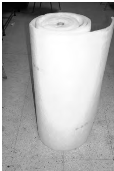
Figura 8.6. Filtro de fibra en rollo para la purificación del aire de inmisión.
