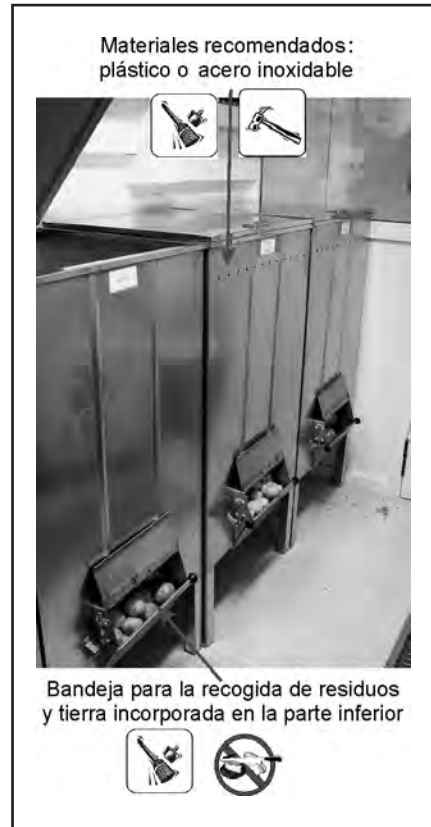
Figura 9.25. Detalle de tolvas.
