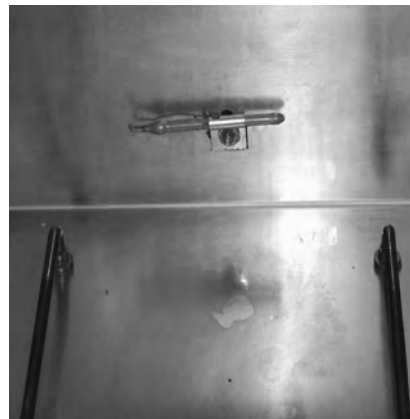
Figura 19.2. Sonda en una cuba de mantenimiento calorífico.
