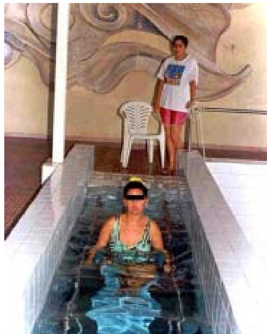
**Figura 8.6.** Tanque de marcha del Centro Nacional de Rehabilitación "Julio Díaz". Posee paralelas hasta las cuales se accede desde el sillón de ruedas. Luego el piso desciende progresivamente a la profundidad requerida. El terapeuta puede supervisar el proceso desde arriba o desde la banda lateral del tanque, cuyos cristales permiten una visibilidad adecuada del proceso de marcha. Cortesía de la profesora Nesfrán Valdés.
