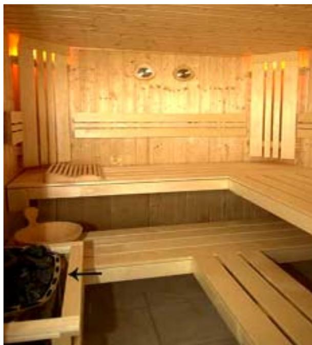
**Figura 13.1.** La sauna se construye con un revestimiento total en madera especial con gran resistencia a la temperatura. La estufa en su interior (marcada por la flecha) debe contar con un perímetro de protección en madera para evitar accidentes. Cortesía de la empresa BEKA.
