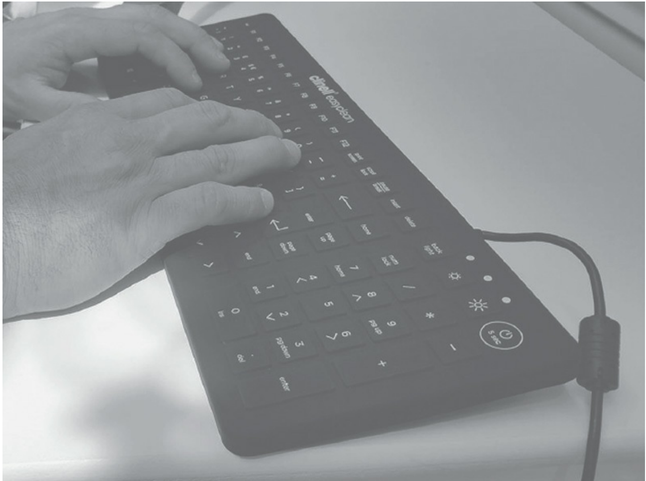
Figura 8-8. Un ejemplo de teclado lavable y completamente sumergible.
