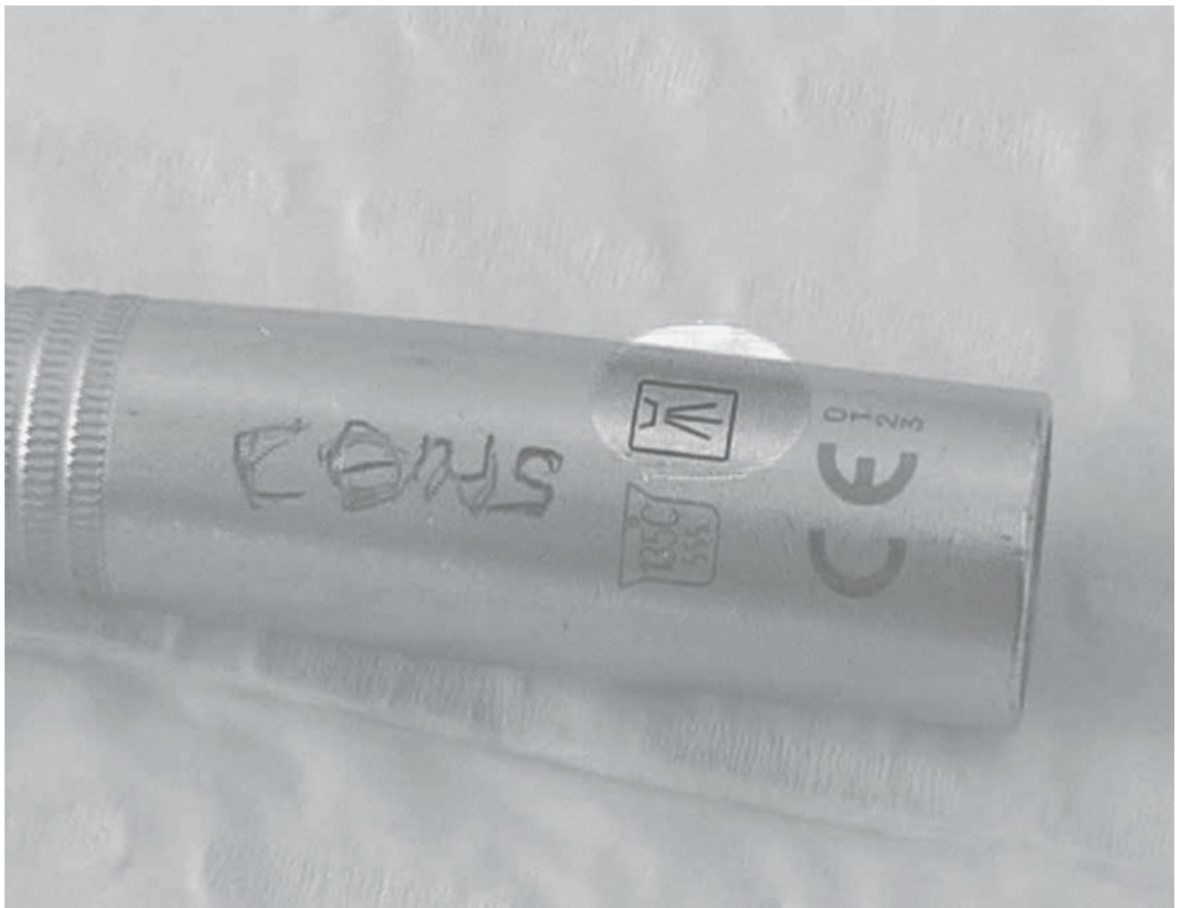
Figura 7-11. Símbolo en una pieza de mano dental que indica que el uso de una lavadora desinfectante térmica es seguro.
