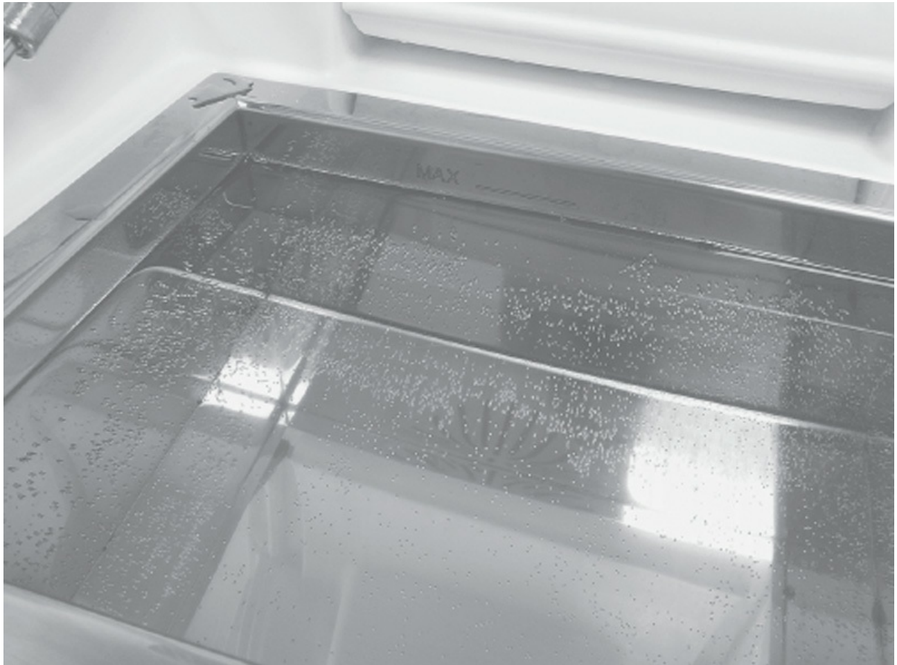
Figura 7-14. La figura muestra burbujas de oxígeno disuelto en un baño ultrasónico. Si no se eliminan, se acumulan en la superficie de instrumentos e interfieren con la acción de cavitación del baño. Se retiran mediante desgasificación del baño.
