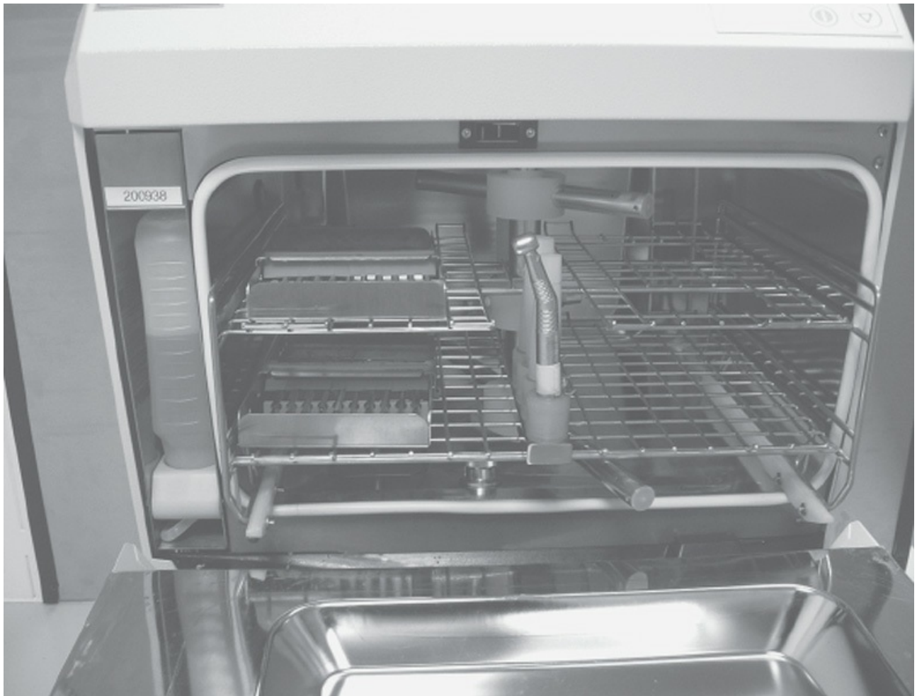
Figura 7-13. Conectores de pieza de mano en una lavadora desinfectante térmica. Si el conector cuenta con un filtro, éste requiere limpieza regular.
