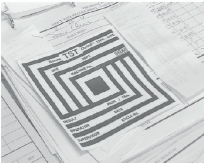
Figura 7-18. (A) Estuche de prueba de Bowie-Dick que muestra la hoja de prueba amarilla en el centro del paquete de papel. (B) Una prueba de penetración de vapor de Bowie-Dick que “pasa”, pegada a la bitácora del esterilizador. (C) Una prueba “fallada” de Bowie-Dick que indica la falta de eliminación de todo el aire del interior del paquete de prueba y su sustitución por vapor, como demuestra el cambio incompleto de color en la hoja indicadora.
