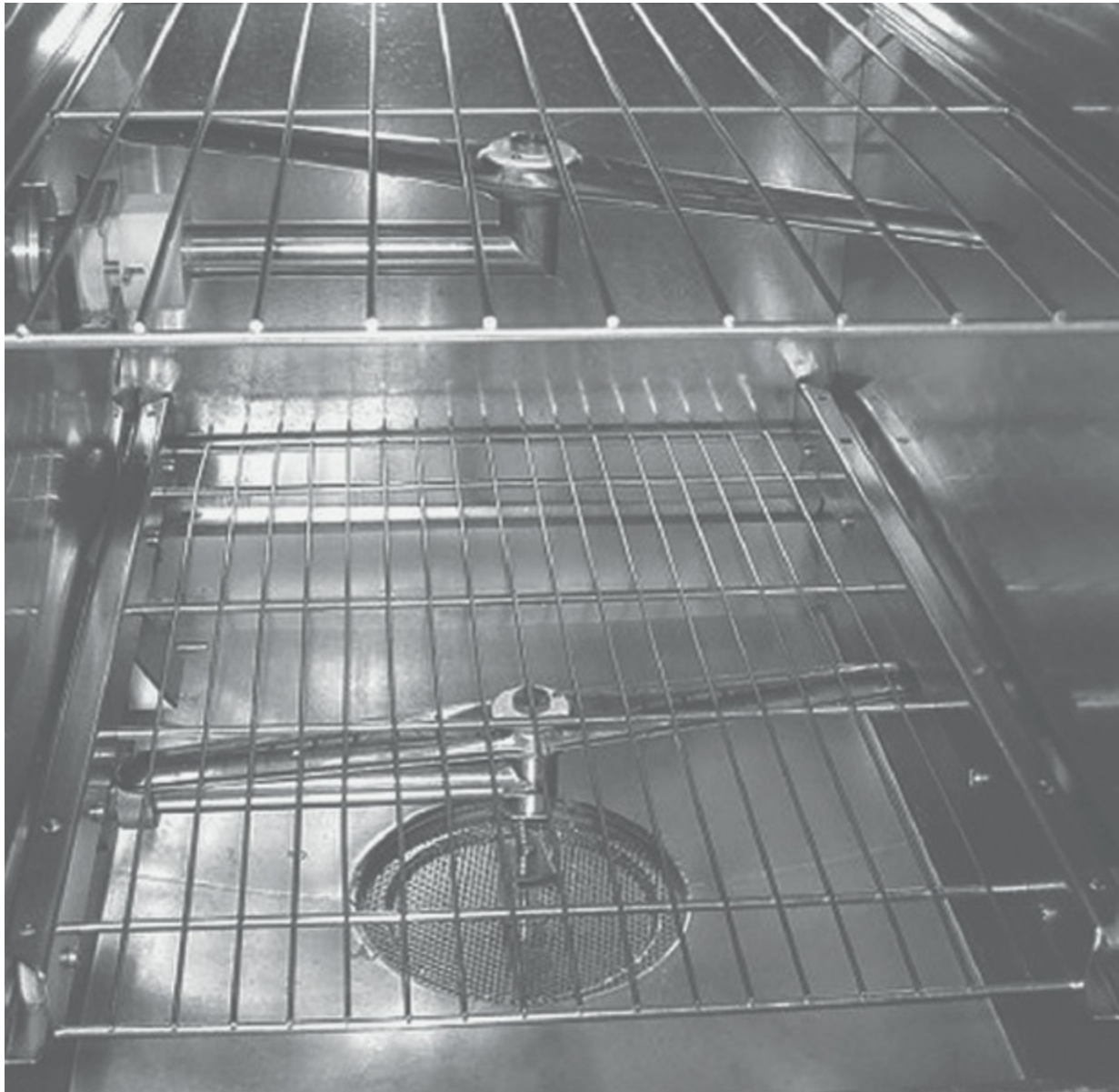
Figura 7-17. Incrustaciones y manchas en las paredes interiores y piso de una lavadora desinfectante térmica que se conectó con una fuente de agua inadecuada; comparar el brillo de la repisa horizontal con las manchas de las otras superficies. Fuente: por cortesía de Paul Jenkins.
