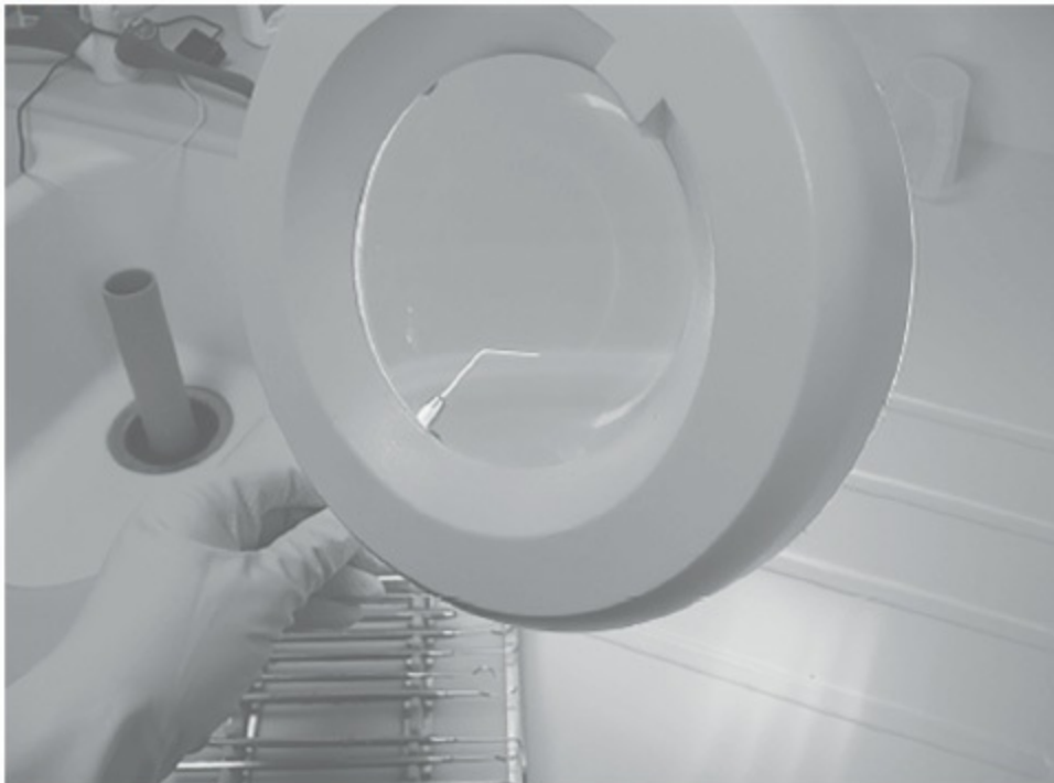
Figura 7-9. Limpieza manual de instrumentos. (A) Mantener los instrumentos sumergidos durante la limpieza. Nótese el uso de un tapón tubular que actúa como vertedero de sobreflujo, ya que las tarjas para lavar instrumentos, como las de lavado manual, no tienen vertederos. (B) Inspección de un instrumento en busca de detritos residuales o
