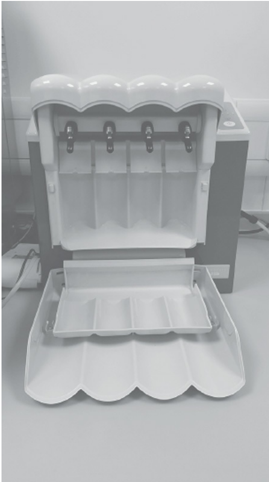
Figura 7-10. Máquina para limpieza y lubricación de piezas de mano dentales que limpia hasta cuatro piezas.
