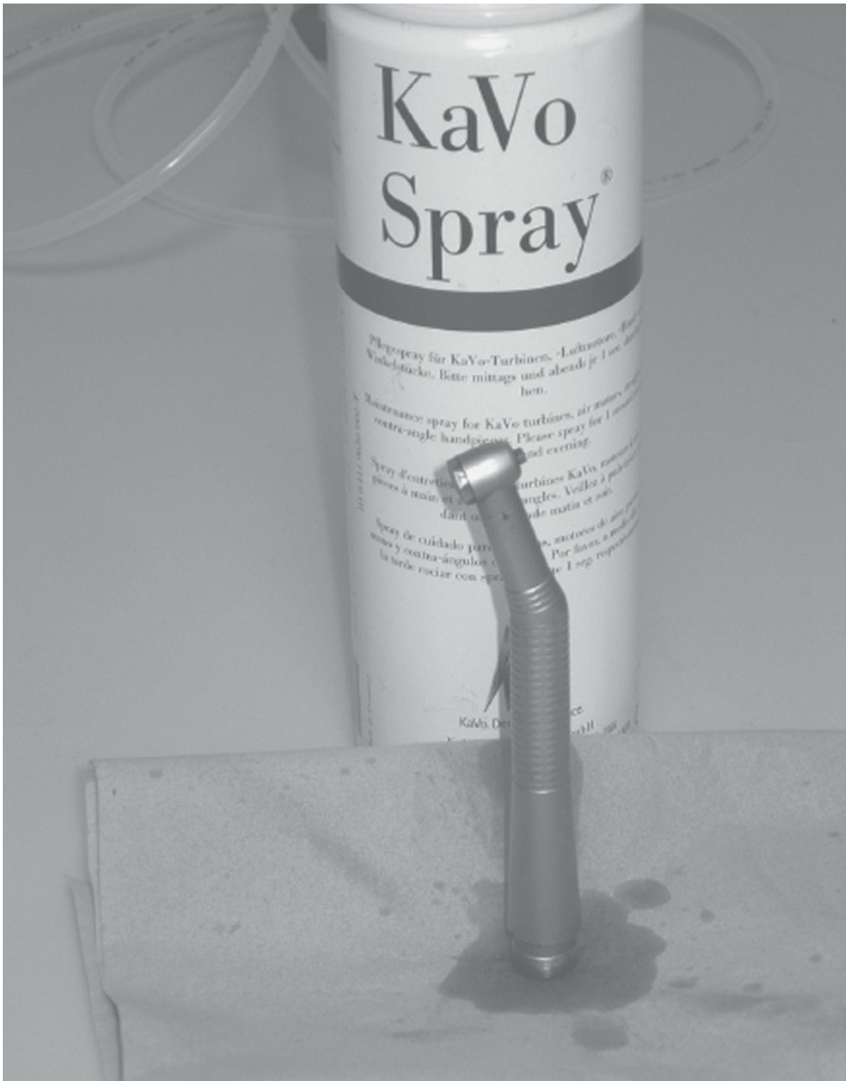
Figura 7-12. Se rocía aceite de servicio en la pieza de mano y se permite que el exceso drene.
