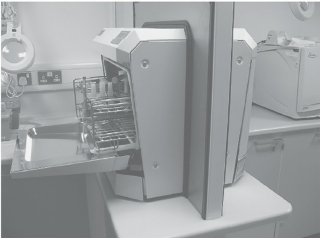
Figura 7-4. Demostración de dos métodos diferentes para demarcar con claridad las zonas limpia y sucia en una instalación de descontaminación con una habitación. (A) Mostrador de distinto color (blanco y gris) para demarcar las zonas sucia y limpia. La unión entre las zonas es la lavadora desinfectante térmica, (B) División simple de vidrio
