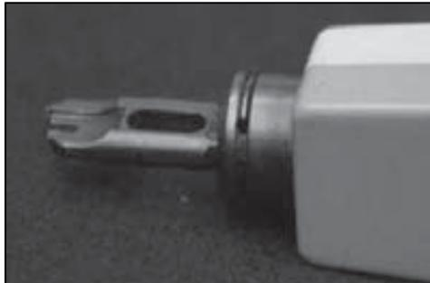
6. En la herramienta de impacto, la cuchilla que tiene en uno de sus lados es más larga y angulada. Este extremo tendrá que situarse en la parte exterior de cada uno de los contactos de la roseta, porque si se pone en el interior, lo que hará será cortar el hilo por la parte de la conexión y ésta dejará de funcionar.
