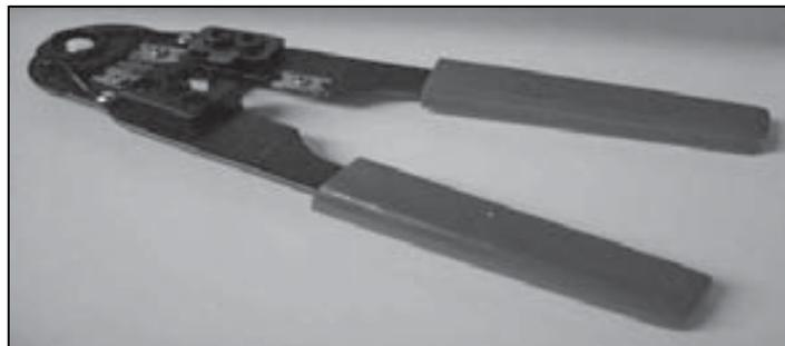
Figura 2.29. Crimpadora para engastar los cables en un conector RJ-45
