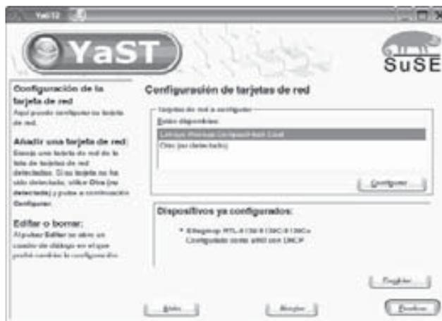
Figura A.10. Detección de un adaptador de red en YaST2
