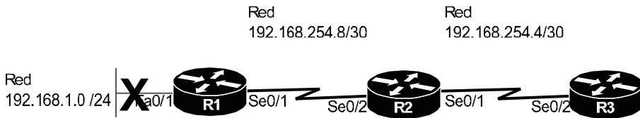
Fig. 6-3.2 Generación de un bucle en capa 3.
