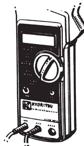
Figura 7.5. Conexión de los conductores de prueba al aparato a los puntos COM – OHMS.
