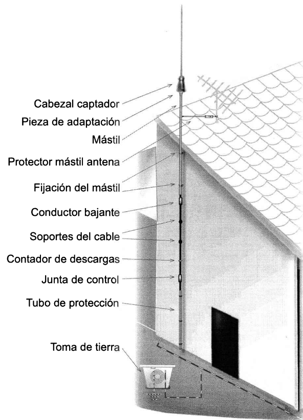
Esquema 4.36. Partes de que se compone la instalación de un pararrayos con dispositivo de cebado.
