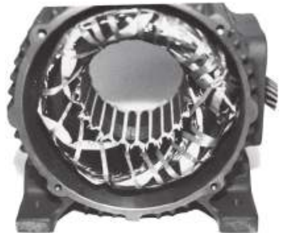
FIGURA 6-1 Estator de un motor de inducción típico que muestra los devanados del estator. (Cortesía de MagneTek, Inc.)
