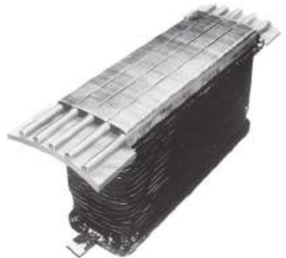
FIGURA 5-17 Polo del campo de un rotor de una máquina síncrona que muestra los devanados de amortiguamiento en la cara del polo. (Cortesía de General Electric Company.)
