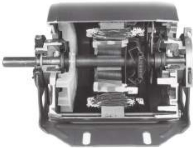
FIGURA 9-16 Vista transversal de un motor de fase partida que muestra los devanados principal y auxiliar y el interruptor centrífugo. (Cortesía de Westinghouse Electric Corporation.)
