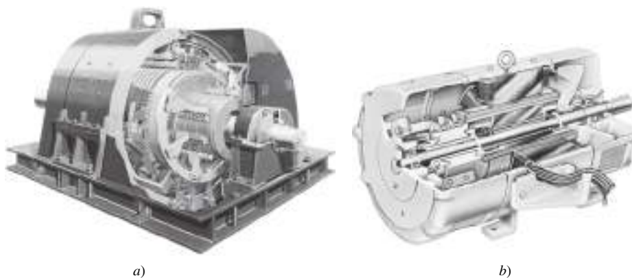
FIGURA 7-34 a) Corte transversal de una máquina de cd de 4 000 hp, 700 V y con 18 polos que muestra los devanados de compensación, los interpolos, el compensador y el conmutador. (Cortesía de General Electric Company.) b) Corte transversal de un motor de cd de cuatro polos más pequeño con interpolos, pero sin devanados de compensación. (Cortesía de MagneTek, Inc.)
