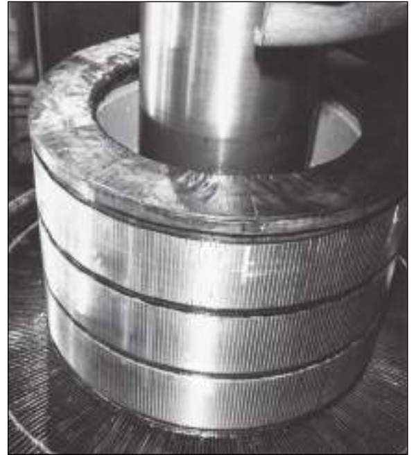
FIGURA 7-19 Vista de cerca del conmutador de una máquina de cd con devanado imbricado grande. Los compensadores están montados en el pequeño anillo, justo enfrente de los segmentos del conmutador. (Cortesía de General Electric Company.)
