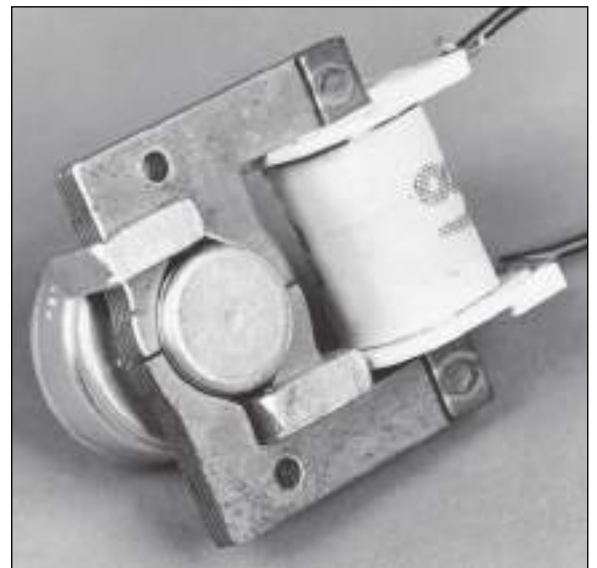
FIGURA 9-37 Pequeño motor de histéresis con estator de polos sombreados, adecuado para accionar un reloj eléctrico. Nótese los polos sombreados del estator. (Stephen J. Chapman.)
