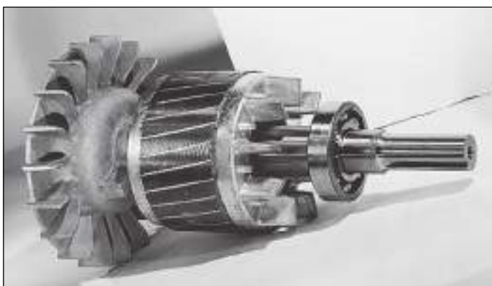
FIGURA B-11 Rotor del motor de inducción que muestra el sesgado del conductor. El sesgo de los conductores del rotor es igual a la distancia entre una ranura del estator y la siguiente. (Cortesía de MagneTek, Inc.)
