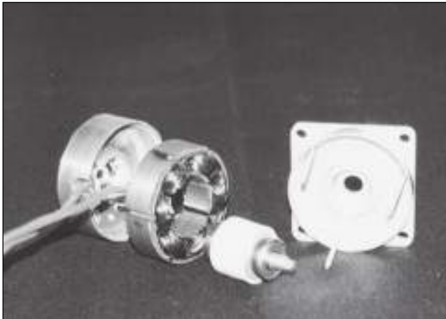
FIGURA 9-41 a) Típicos motores de cd sin escobillas. b) Motor desarmado que muestra el rotor de imán permanente y el estator trifásico (de 6 polos). (Cortesía de Carson Technologies, Inc.)
