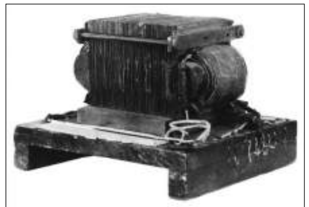
FIGURA 2-1 El primer transformador moderno práctico, construido por William Stanley en 1885. Nótese que el núcleo está elaborado con hojas individuales de metal (láminas). (Cortesía de General Electric Company.)
