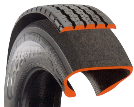
Fig. 8-17 Aplicación de una nueva banda
