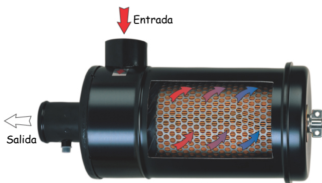
Fig. 3-4 Recorrido del aire en el filtro
