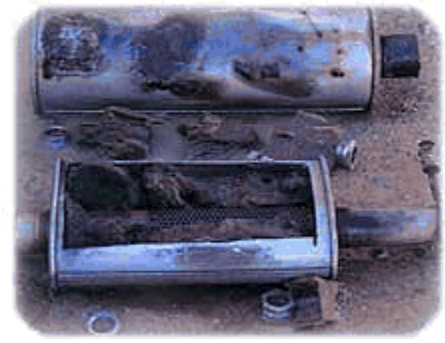
Fig. 4-10 Fusión del interior del catalizador
