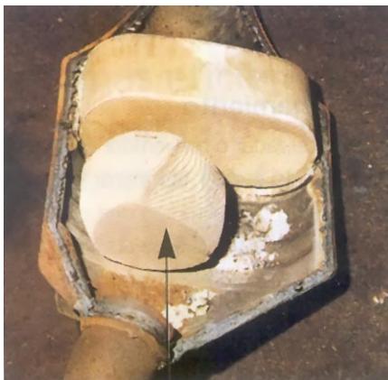
Fig. 4-11 Desgaste y rotura del catalizador
