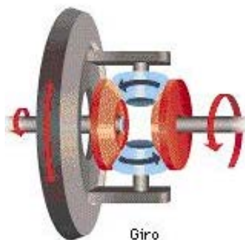
Fig. 7-26 Un planetario gira más que otro, a costa del giro que le transmiten los satélites
