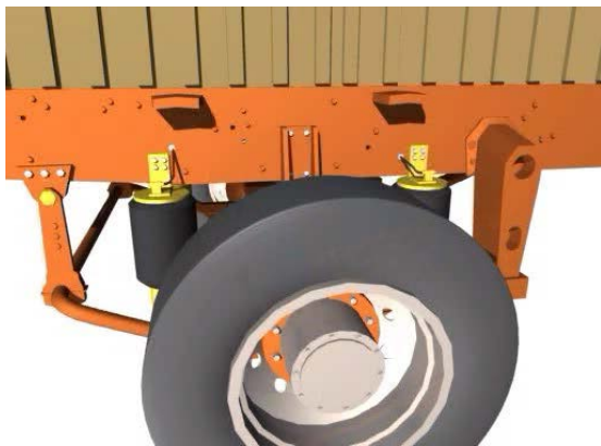
Fig. 9-17 Situación de los cojines neumáticos sobre el eje trasero
