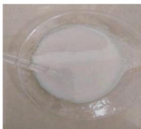
Figura 2: Nanocomposito de polisiloxano funcionalizado con nanopartículas de plata
