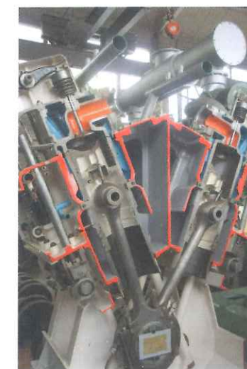
Figura 4.1 Carrera ascendente o descendente de un pistón.
