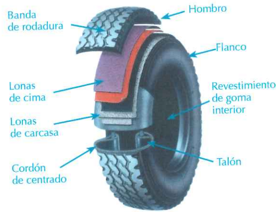
Figura 10.1 Partes de un neumático.
