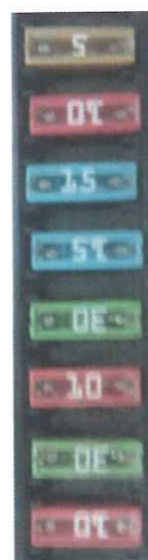
Figura 7.14 Imagen real de los fusibles.
