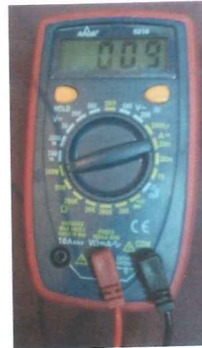
Figura 4.8 Multímetro en posición de ohmímetro.
