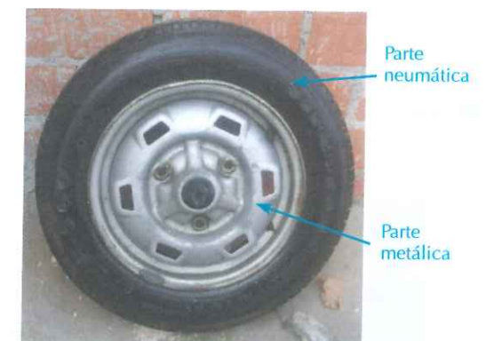
Figura 11.1 Rueda: parte metálica y neumática.
