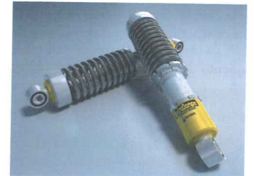
Figura 10.5 Amortiguador y muelle.
