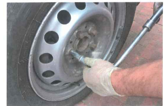
Figura 10.8 Sustitución de rueda.
