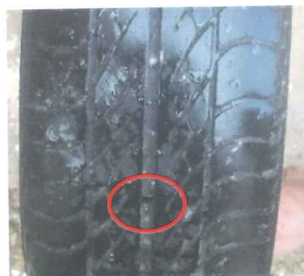
Figura 11.12 Indicador de desgaste de neumático.
