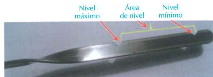
Figura 5.5 Marcas indicadoras de nivel óptimo de aceite en el motor.
