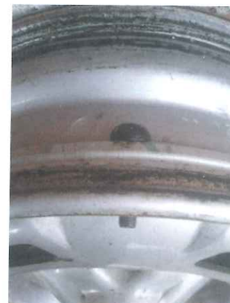
Figura 11.9 Vista ampliada de válvula en neumáticos sin cámara.
