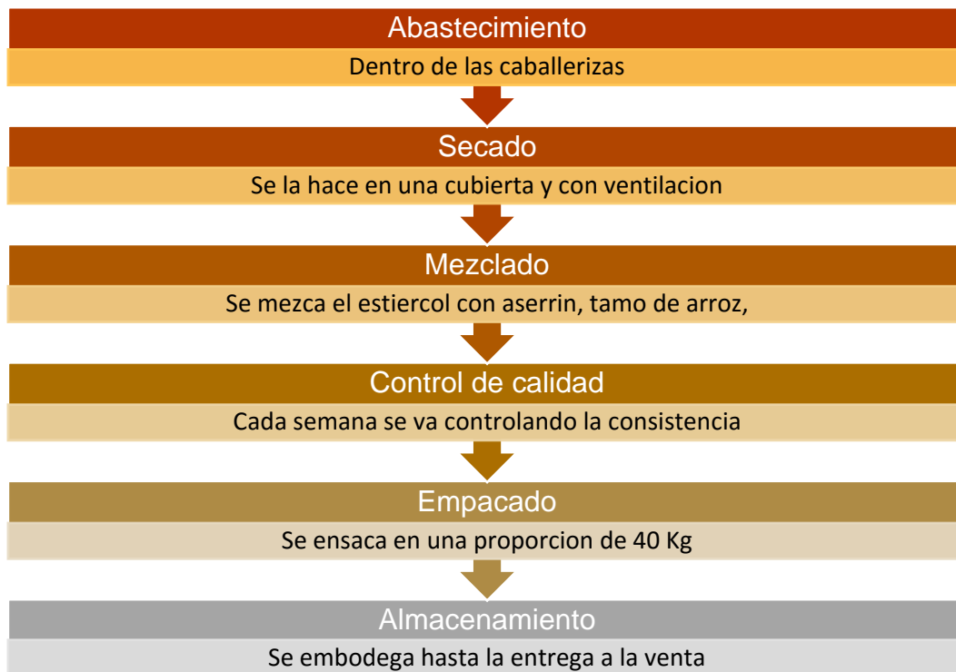
Figura.13 Proceso del abono. desglose del proceso de producción del ABORG Elaborado Tupuez León José Félix
