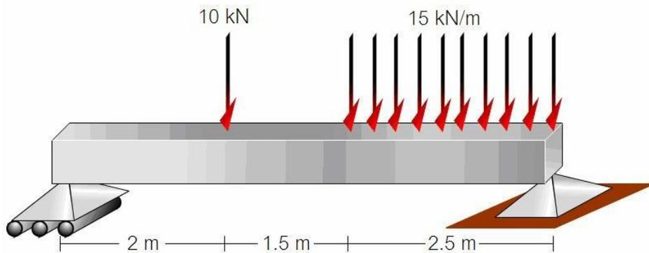
**Figura 4.9** Viga sometida a cargas
