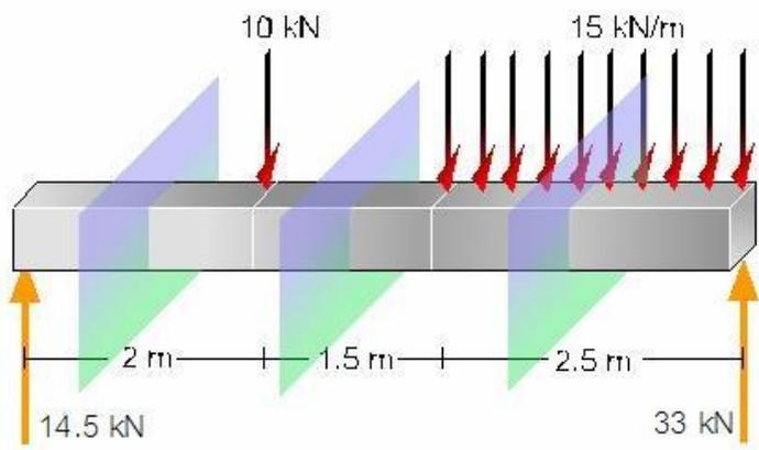
**Figura 4.15** Cortes necesarios para en análisis de la viga
