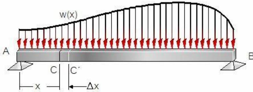
**Figura 4.27** Viga sujeta a cargas
