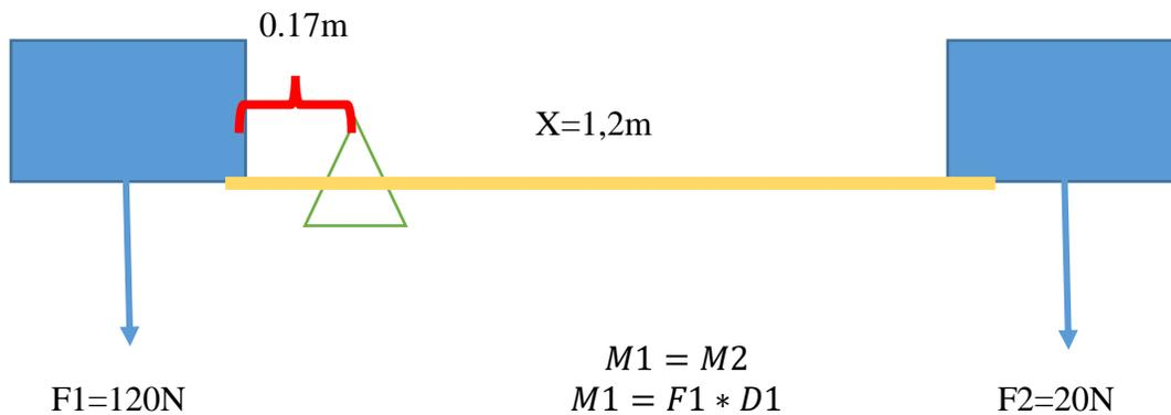
$$\begin{aligned}M1 &= M2 \\M1 &= F1 * D1 \\M2 &= F2 * D2 \\F1 * D1 &= F2 * D2 \\120N * D1 &= 20N * D2 \\ \frac{120N}{20N} &= \frac{D2}{D1} \\6 &= \frac{D2}{D1} \\D2 &= 6D1 \\D1 + D2 &= 1,2m \\D1 + 6D1 &= 1,2m \\7D1 &= 1,2m \\D1 &= \frac{1,2m}{7} \\D1 &= 0,17m \\D2 &= 1,03m\end{aligned}$$
