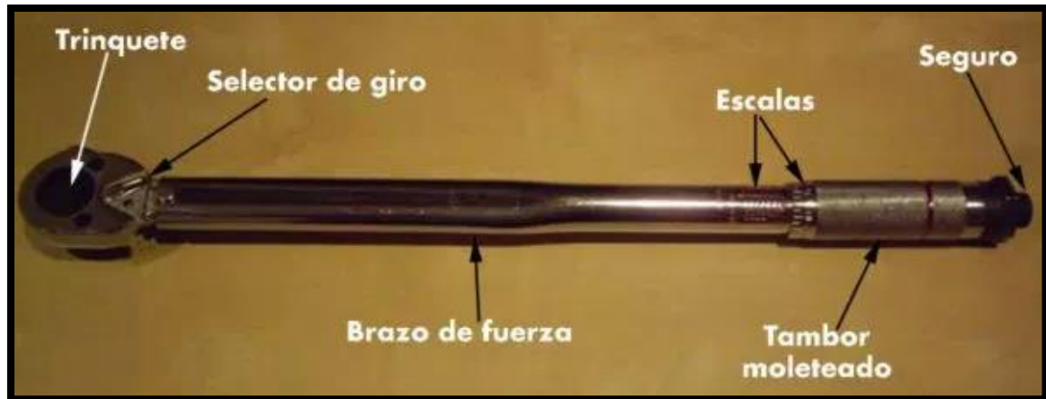
Figure 22. Partes del torquímetro.
