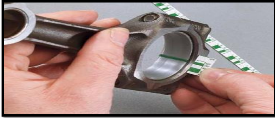
Figure 24. Verificación del ajuste con plastigage.
