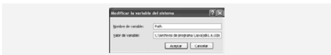
Figura 10 | Modificación de la variable PATH.
