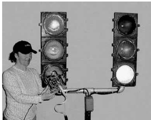
FIGURA B.2 Circuito de interfaz utilizado con las luces de los semáforos. Un circuito excita una luz.
