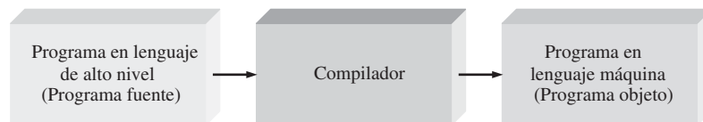
FIGURA 12.16 Conversión de un lenguaje de alto nivel a lenguaje máquina mediante un compilador.
