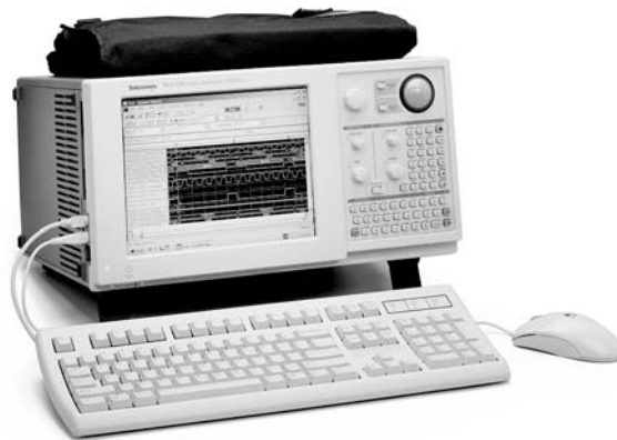
FIGURA 1.50 Analizador lógico típico. Fotografía utilizada con permiso de Tektronix, Inc.
