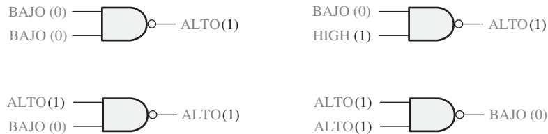
FIGURA 3.26 Funcionamiento de la puerta NAND de 2 entradas.
