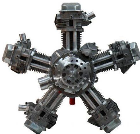
Los motores con **disposición radial de cilindros**, también conocidos como motores estrella, son un 'rara avis' en el mundo de las cuatro ruedas. En estos bloques, los cilindros van situados de **forma radial alrededor del cigüeñal**, como si se trataran de las puntas de una estrella. Por su diseño, son mucho más útiles en la aviación, donde se utilizan de forma bastante habitual.
