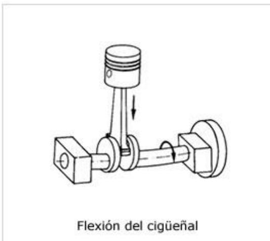
El volante de inercia es otro agente productor de vibraciones, ya que su peso retarda la propulsión del cigüeñal. La presión de trabajo produce un esfuerzo de torsión sobre el cigüeñal y, en la compresión, las resistencias en el cilindro actúan de nuevo, pero de forma antagónica. La alternancia de estas fuerzas ocasiona unas vibraciones llamadas vibraciones de torsión que aparecen especialmente en el momento de arranque y en el frenado.
