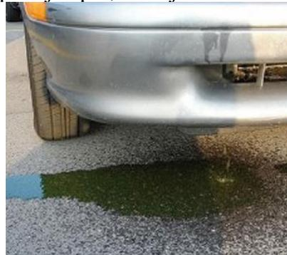
Son señales de una fuga: un indicador de aumento de temperatura, un charco de líquido refrigerante debajo del auto y una caída en el nivel del radiador. Por lo tanto habrán manchas de óxido en el compartimiento del motor.
