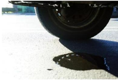
Las fugas de aceite del motor son una de las fugas automotrices más comunes. Usualmente ocurren en juntas de empaque rotas o gastadas alrededor del bloque del motor.
