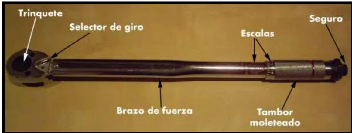
Figure 22. Partes del torquímetro.
