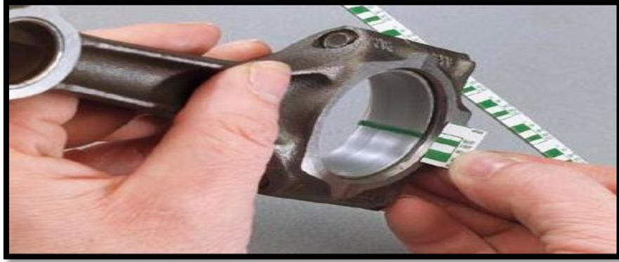
Figure 24. Verificación del ajuste con plastigage.
