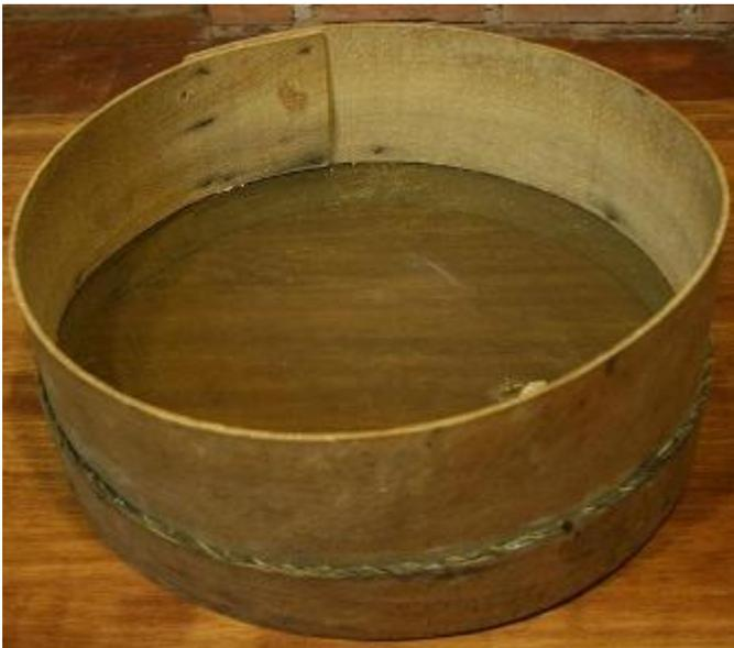
Empleado para separar sustancias sólidas que tengan distinto tamaño, como la arena de la grava cuando se desea preparar mortero en la construcción. Como la grava está formada por piedras de varios centímetros de tamaño y la arena por granos de apenas unos milímetros, empleando una criba, que tiene una red con agujeros de medio centímetro, los granos de arena
