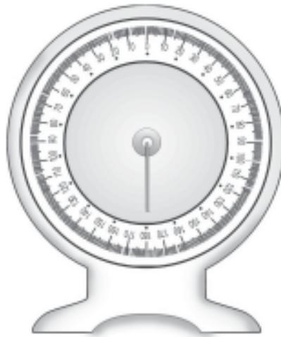
*Fig. 40: Inclinómetro de péndulo.*
