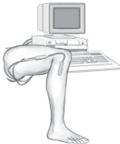
*Fig. 37: Electrogoniómetro.*
