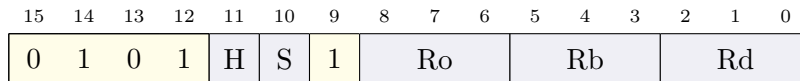
Figura 4.5: Formato A de las instrucciones de carga/almacenamiento con direccionamiento indirecto con registro de desplazamiento
