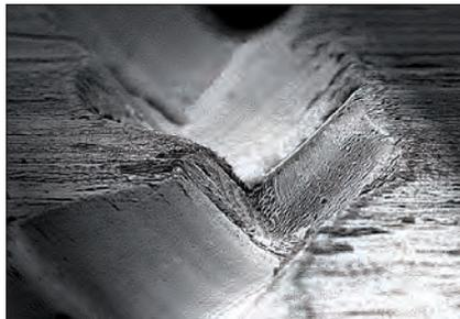
Surco en un disco de vinilo. Puede verse la forma variante y distinta a cada lado del surco, lo que representa respectivamente la onda de sonido en los canales derecho e izquierdo del estéreo. El ancho promedio de un surco es de  $40\ \mu\text{m}$  (micrómetros).<sup>20</sup>
