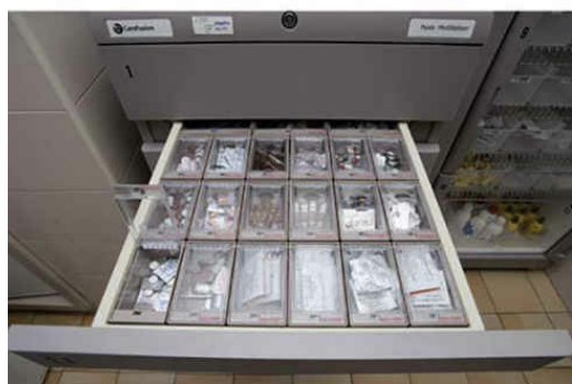
FIGURA 6.4 A. Mini Drawer: un mismo fármaco en compartimentos individuales. En la imagen de la derecha pueden verse varios fármacos en diferentes compartimentos de un mismo cajón. B. Matrix: varios fármacos en diferentes compartimentos. C. Cubie: un solo fármaco. D. Columna de diferentes fármacos.
