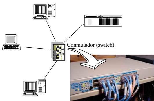
Figura 7.7: Esquema de una red Ethernet con conmutador.
