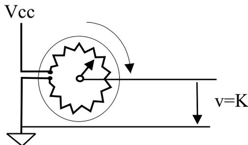
Figura 2.48: Transductor de posición angular mediante potenciómetro.
