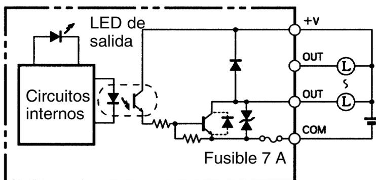
Figura 5.17: Circuito de salida digital del módulo OD211 del autómata CQM1 de Omron Electronics.
