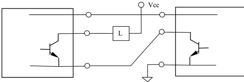
Figura 2.19: Conexión en serie de varios detectores NPN.
