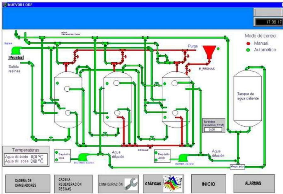
Figura 7.15: Ventana del sistema de regeneración de resinas.
