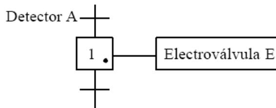
Figura 3.9: Modelado de Grafcet de nivel 2.
