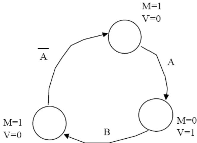
Figura 3.2: Diagrama de estados de la embotelladora.
