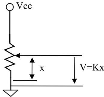
Figura 2.47: Transductor de posición lineal mediante potenciómetro.
