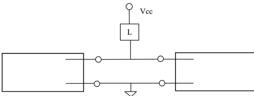
Figura 2.20: Conexión en paralelo de detectores de 2 hilos.
