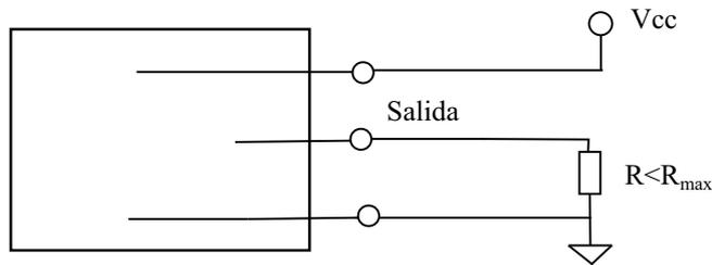
Figura 2.13: Detector con salida analógica de corriente.
