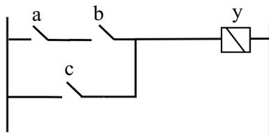
Figura 1.2: Función lógica  $y = a \cdot b + c$ .
