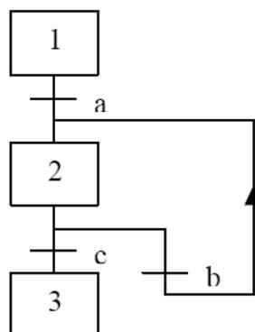
Figura 3.25: Ejemplo de prioridad de la activación.
