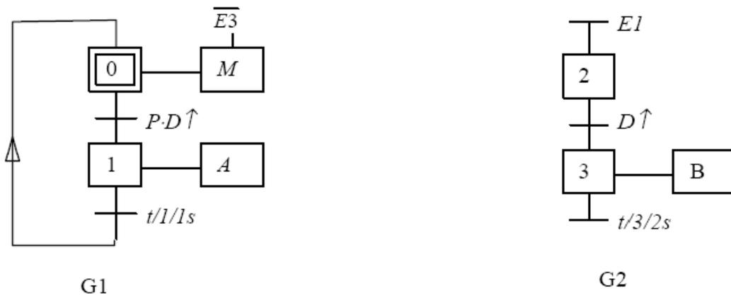
Figura 3.39: Solución C del ejemplo 4 utilizando varios Grafkets.
