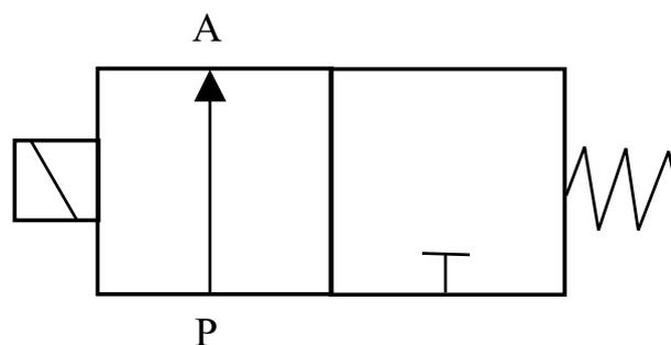
Figura 2.55: Esquema de una electroválvula 2/2 (2 vías y 2 posiciones).
