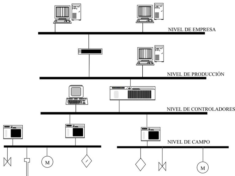
Figura 7.1: Niveles de un sistema de control distribuido.
