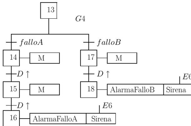
Figura 4.11: Diagrama de Grafcet para el Ejemplo 2: un automatismo con marcha por ciclo y parada por emergencia, con y sin diagnóstico de fallos.
