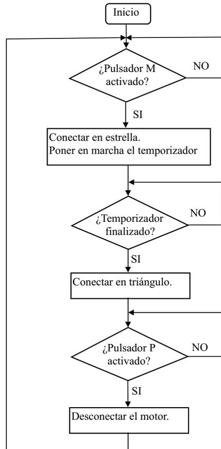
Figura 1.5: Diagrama de flujo del arrancador estrella triángulo.
