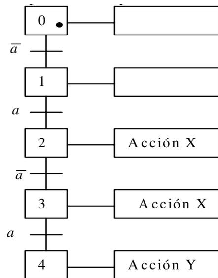
Figura 3.28: Grafcet equivalente al de la figura 3.27.
