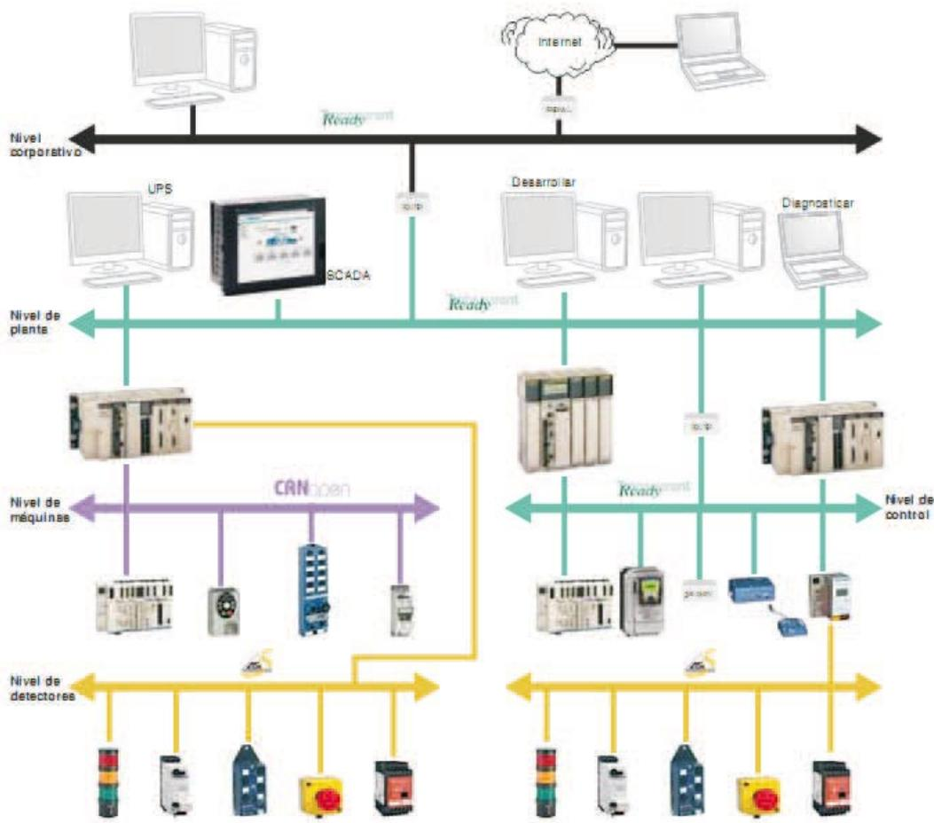
Figura 7.2: Ejemplo de sistema de control distribuido de Schneider Electric.
