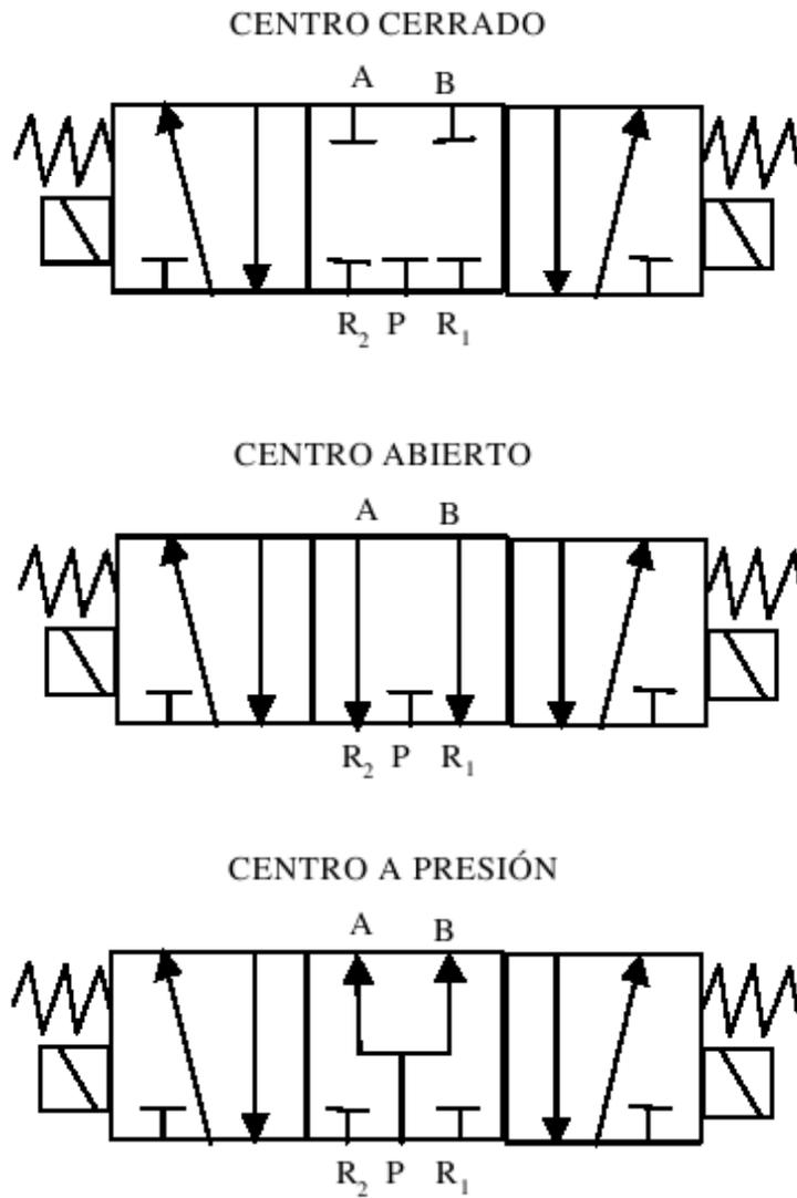
Figura 2.58: Esquema de una electroválvula 5/3 (5 vías y 3 posiciones).
