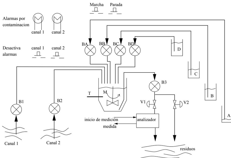
El funcionamiento es como a continuación se describe. Las bombas B1 y B2 toman agua de los canales 1 y 2 respectivamente. El análisis de cada canal se hace por separado, alternándose. Entre los análisis de los canales deben transcurrir 30 minutos.
