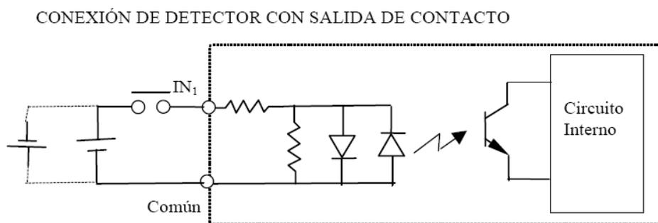
Figura 5.7: Conexión de un sensor con salida de relé a la entrada digital de un autómata.
