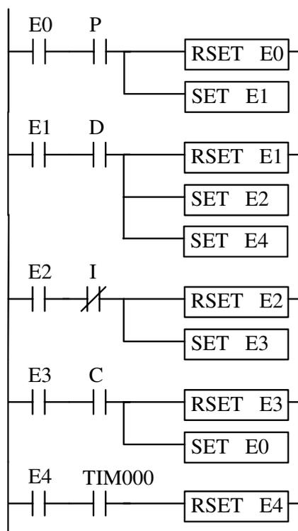
Figura 6.12: Implementación de las activaciones/desactivaciones del ejemplo 2 mediante el método 1.
