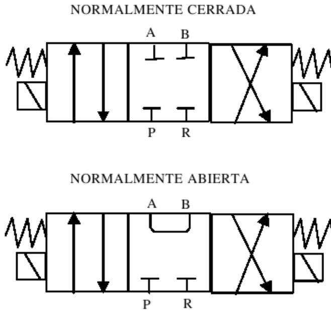
Figura 2.59: Esquema de una electroválvula 4/3 (4 vías y 3 posiciones).
