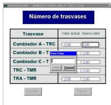
Figura 7.23: Ventana de configuración del número de trasvases. Entrada de nuevo valor.
