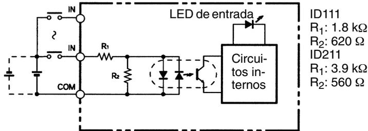
Figura 5.10: Circuito de entrada digital del módulo ID111/212 del autómata CQM1 de Omron Electronics.
