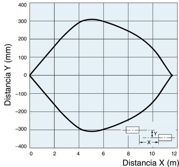
Figura 2.31: Curva de detección de una fotocélula de barrera de Omron Electronics.
