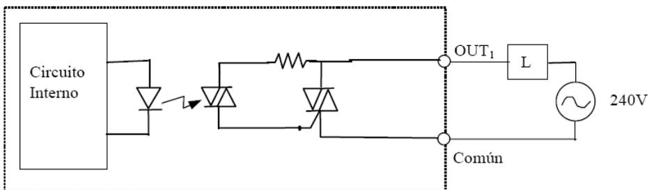
Figura 5.15: Circuito de salida digital a triac y su conexión a la carga.
