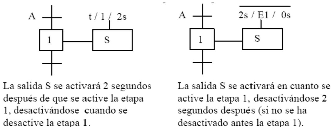
Figura 3.21: Uso de temporizaciones en las salidas condicionadas.
