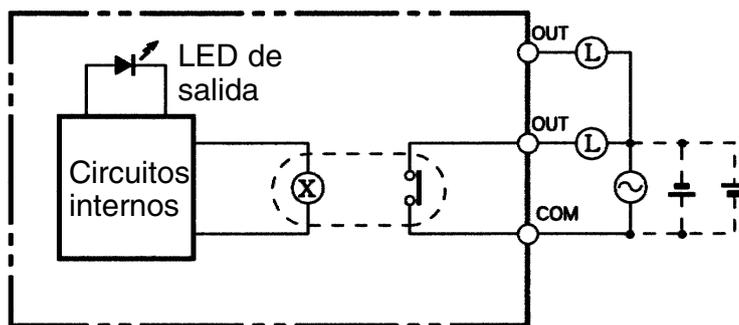
Figura 5.16: Circuito de salida digital del módulo OC222 del autómatas CQM1 de Omron Electronics.
