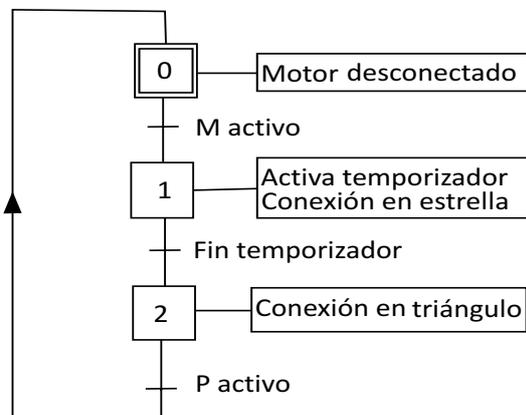
Figura 1.6: Diagrama Grafcet del arrancador estrella triángulo.
