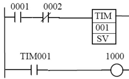
Figura 5.24: Uso de temporizadores en los autómatas Omron.
