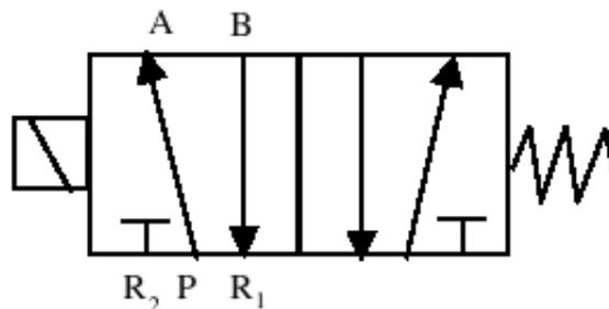
Figura 2.57: Esquema de una electroválvula 5/2 (5 vías y 2 posiciones).
