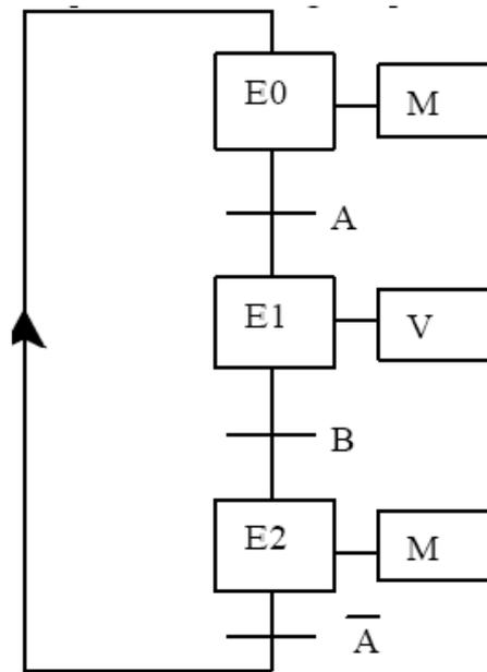
Figura 3.6: Grafcet que modela el ejemplo de la embotelladora.
