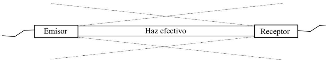
Figura 2.22: Funcionamiento de un detector de barrera y definición del haz efectivo.
