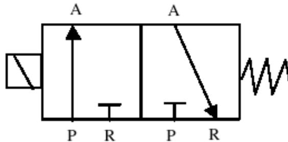
Figura 2.56: Esquema de una electroválvula 3/2 (3 vías y 2 posiciones).
