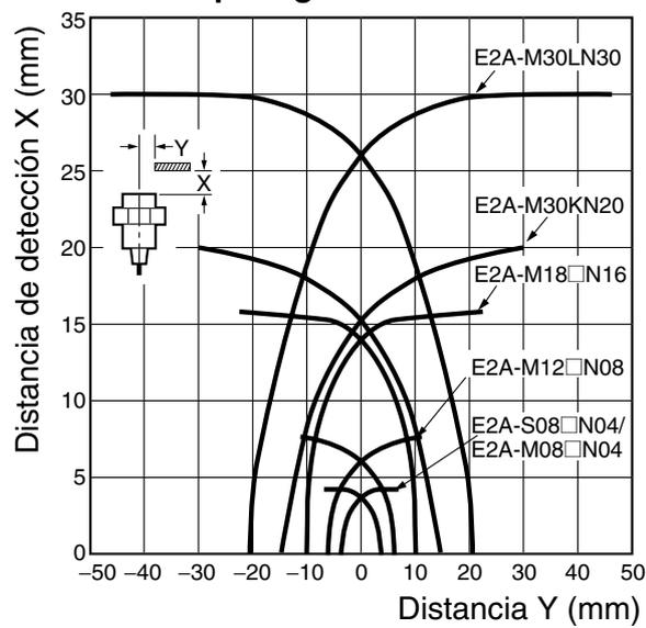
Figura 2.43: Curva de detección de sensores inductivos E2A de Omron Electronics.
