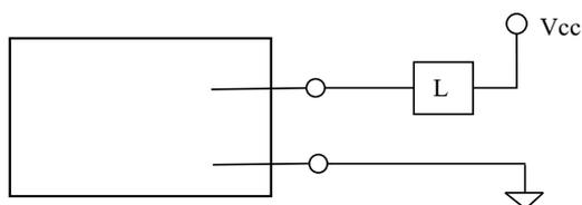
Figura 2.9: Detector con salida de 2 hilos.
