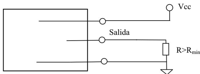
Figura 2.12: Detector con salida analógica de tensión.
