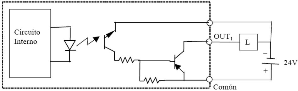
Figura 5.14: Circuito de salida digital a transistor PNP y su conexión a la carga.
