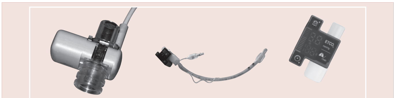
Figura 6.1. Capnómetro. A la izquierda se observa la cubeta (adaptador de vía aérea); en el centro, la cubeta de medición, y a la derecha, la pantalla de registro del dispositivo
