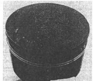
Figura 18.17 Efecto de la combustión con autoinflamación en un pistón.
