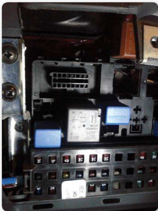
Figura 7. Conector OBDII en el Fiat Uno Fire ubicado al lado izquierdo del volante, junto a la caja de fusibles.
