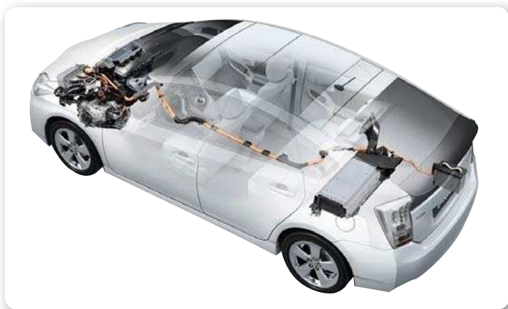
Figura 2. Vista interna de las partes que componen un auto híbrido. En este caso corresponden al modelo Prius , fabricado por Toyota .
