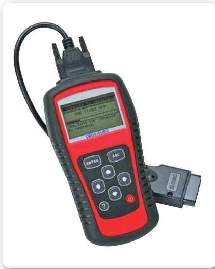
Figura 3. Lector portátil para diagnóstico electrónico OBDII. A diferencia de las interfaces que se conectan a nuestra notebook o celular, solo muestra el código de error y su posible solución.
