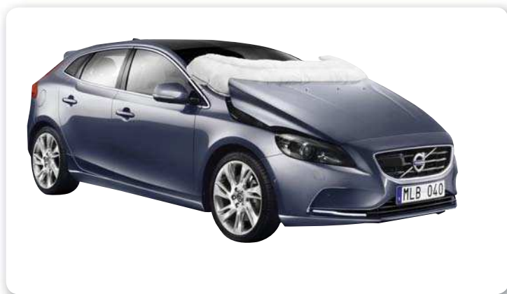
Figura 19. La automotriz Volvo incorporó en su modelo V40 el sistema de airbag para peatones.
