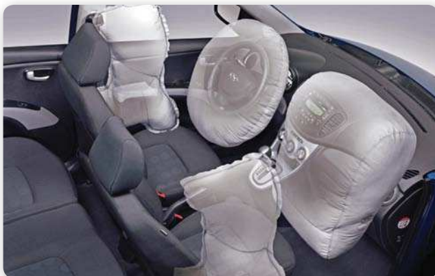
Figura 17. Este modelo de bolsas de aire de seguridad incluye un airbag lateral de cada lado para proteger la cabeza ante un vuelco.
