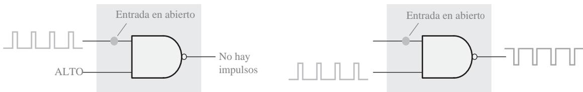
(a) Si se aplican impulsos en una entrada en abierto no se generan impulsos a la salida.
