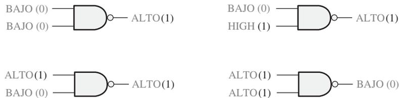
FIGURA 3.26 Funcionamiento de la puerta NAND de 2 entradas.
