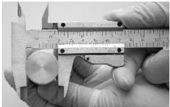
Figura 2.10 a) Forma incorrecta de colocar un objeto en el vernier. b) Forma correcta de colocar un objeto en el vernier.
