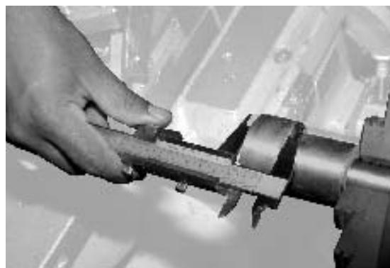
Figura 2.20 No mida un objeto mientras esté en movimiento.
