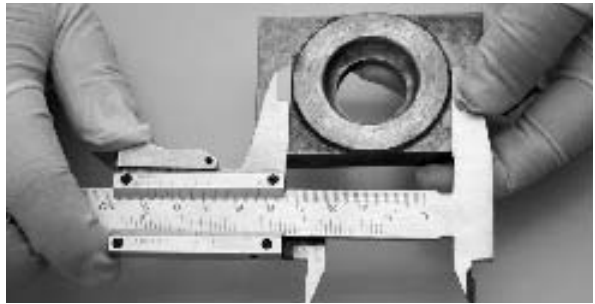
Figura 2.9 Método correcto de manejar los calibradores.
