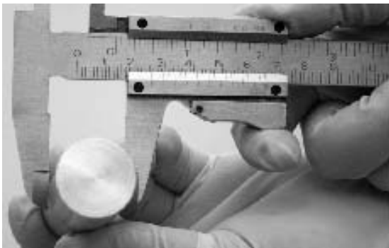
Figura 2.10 a) Forma incorrecta de colocar un objeto en el vernier. b) Forma correcta de colocar un objeto en el vernier.
