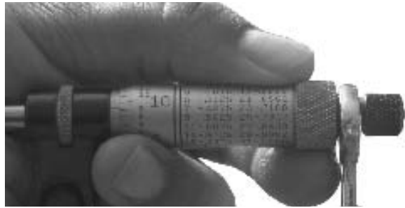
Figura 2.46 Atornille toda la rosca del trinquete y apriétela con la llave.
