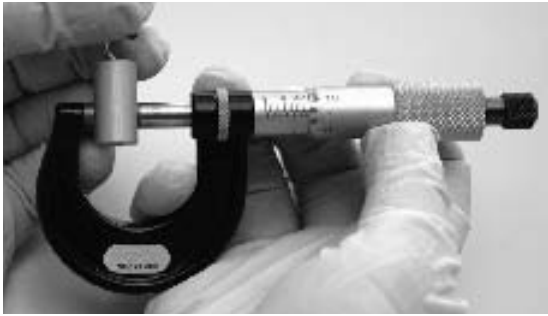
Figura 2.37 Método correcto para sostener el micrómetro con las manos.
