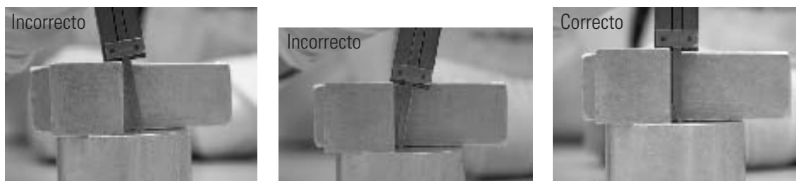
Figura 2.17 Ejemplos de métodos de medición, incorrectos y correctos.
