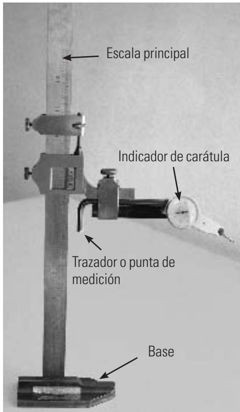
Figura 2.60 Medidor de altura con indicador de carátula.
