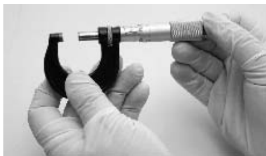
Figura 2.36 Método correcto para sujetar el micrómetro con las manos.
