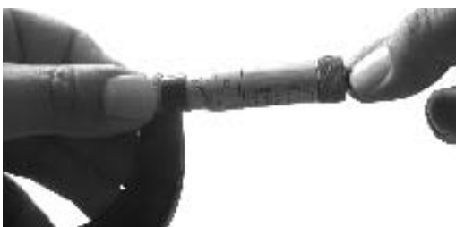
Figura 2.45 Gire el manguito en sentido contrario a las manecillas del reloj.
