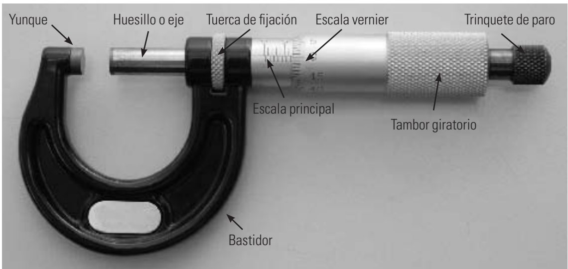
Figura 2.29 Partes de un micrómetro.
