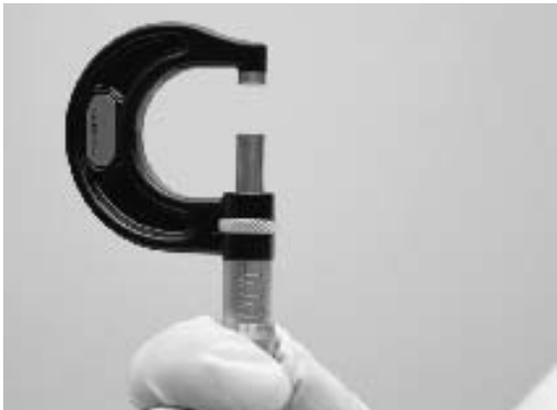
Figura 2.43 No gire el manguito hasta el límite de su rotación.
