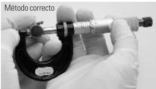
Figura 2.38 Métodos correcto e incorrecto de medición.
