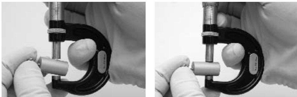
Figura 2.41 Contacto correcto con el objeto a medir.
