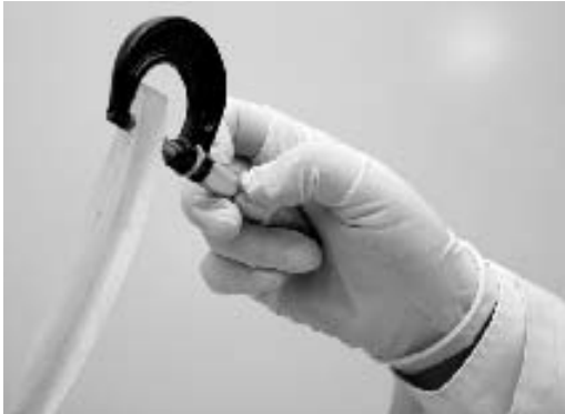
Figura 2.42 No levante un objeto con el micrómetro.
