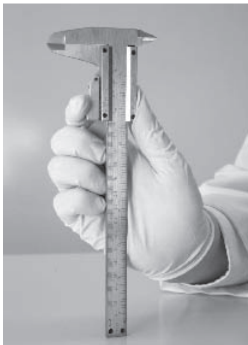
Figura 2.8 Verificando el medidor de profundidad.
