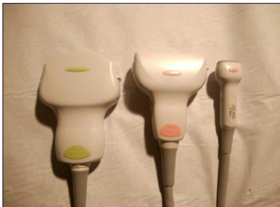
IMAGEN 1 - Tipos de sondas más utilizadas (convex, lineal y sectorial)
