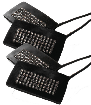
FIGURA 16.13 Aplicadores de luz con matriz de LED. (Cortesía de Anodyne Therapy, Tampa, FL).
