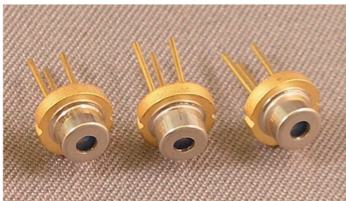
FIGURA 16.9 Fotodiodos. (Cortesía de LaserMate Group, Pomona, CA.).
