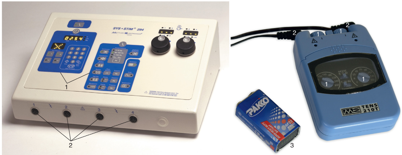
FIGURA 11.1 Dispositivo de estimulación eléctrica. (1) Controles para ajustar los parámetros. (2) Enchufes para los electrodos. (3) Fuente de alimentación. Nota: en las unidades clínicas la energía procede de un enchufe conectado a una toma de corriente, mientras que en las unidades portátiles la energía habitualmente es suministrada por una pila de 9 V. (Cortesía de Mettler Electronics, Anaheim, CA.)
