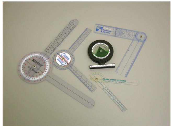
FIGURA 6.7 Instrumentos utilizados para medir el arco de movilidad: goniómetros y un inclinómetro.
