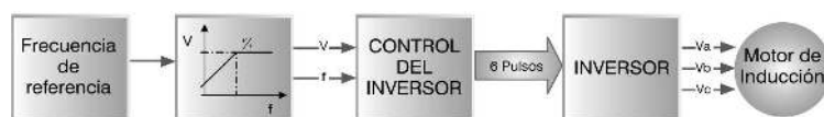
Figura 13.50 Esquema de control escalar ( v/f ), usando una estrategia PWM con vectores espaciales.
