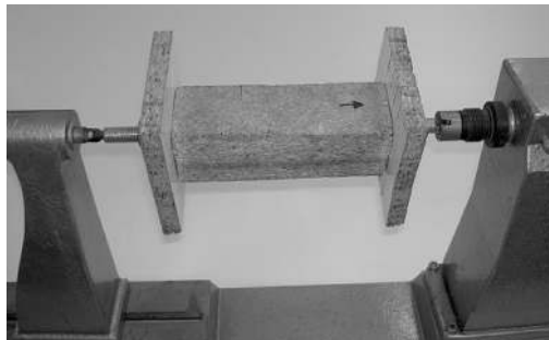
Figura 199. Núcleo de madera montado en la bobinadora, falta el carrete de plástico.
