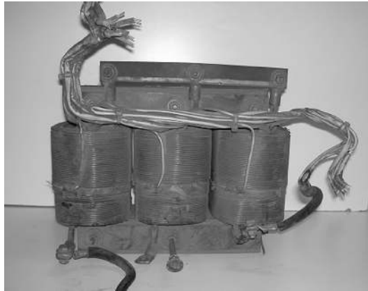
Figura 89. Transformador de soldadura trifásica, observar los terminales del devanado primario que se conectan al conmutador estrella-triángulo para adaptar el transformador a la tensión de red.
