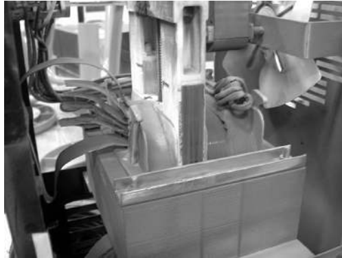
Figura 83. Transformador de soldadura por flujo de dispersión.
