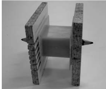
Figura 198. Núcleo de madera introducido en el carrete de plástico dispuesto para la bobinadora.
