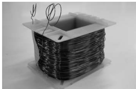
Figura 200. Carrete con el devanado secundario ya bobinado.
