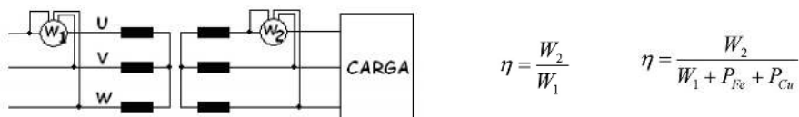
Figura 161. Circuito a realizar para calcular el rendimiento de un transformador trifásico.
