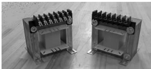
Figura 30. Chapas magnéticas introducidas en un carrete de plástico formando el Núcleo Magnético. Se puede observar que sólo faltan los devanados.
