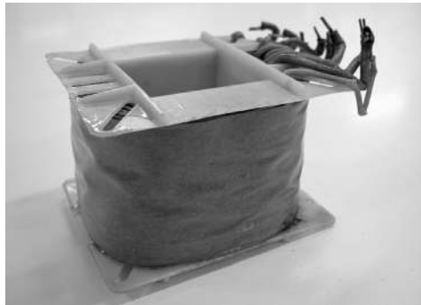
Figura 201. Carrete con los devanados ya bobinados, listos para introducir las chapas magnéticas.
