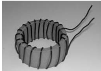
Figura 75. Transformador de intensidad sin la carcasa protectora.
