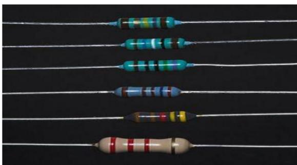
**Figura 2:** Diferentes resistencias todas ellas de empaquetado tipo axial.
