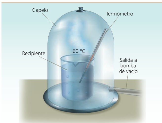
6.19 A una presión de una atmósfera o 760\text{ mm de Hg} , el agua hierve a 100\text{ }^{\circ}\text{C} , pero al disminuir la presión mediante una bomba de vacío, el agua hierve a menor temperatura.
