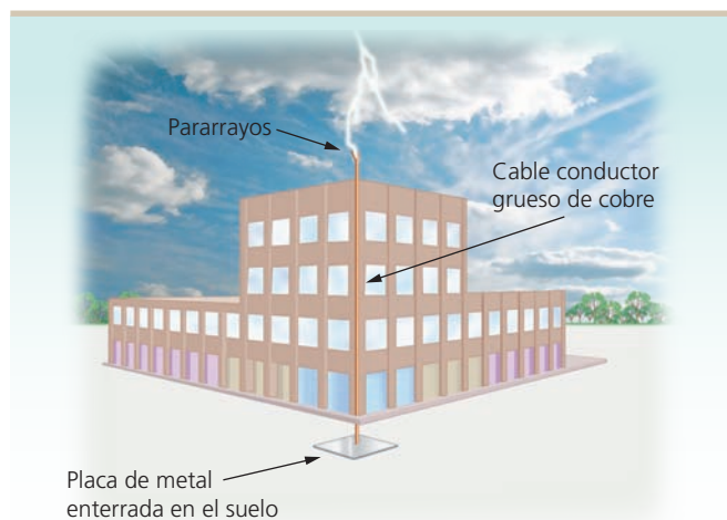
12.3 Por medio de un pararrayos, las descargas eléctricas (rayos), que se producen en la atmósfera, se disipan en el suelo.
