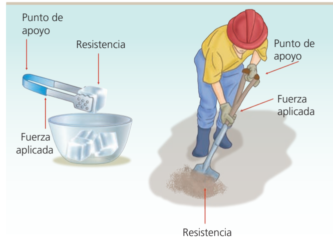
5.63 La pinza para hielo y la pala son palancas de tercer género.
