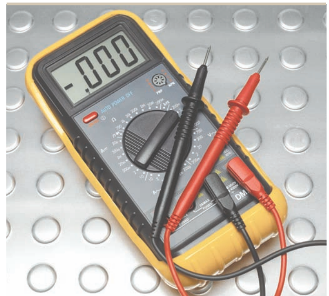
12.30 Con el voltímetro se puede medir la diferencia de potencial entre dos puntos.
