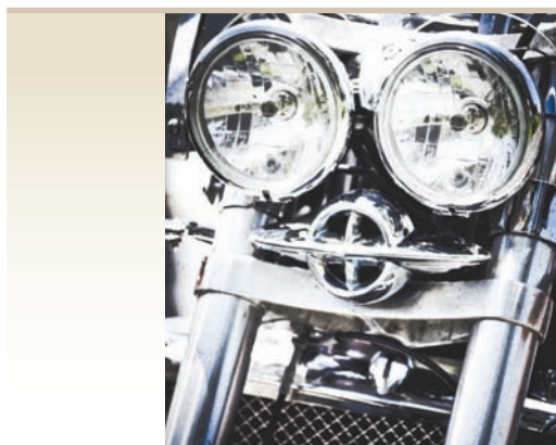
12.58 Las partes cromadas se obtienen a través de la galvanoplastia.
