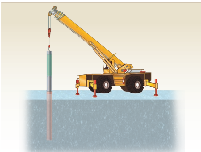
5.42 La energía potencial gravitacional que tiene el mazo se utiliza para introducir pilotes en suelos blandos, para reforzarlos y construir edificios más seguros.
