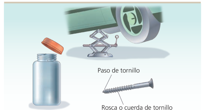
5.67 El tornillo, un frasco y su tapa con rosca, y el gato usado para levantar grandes pesos a poca altura, son aplicaciones del plano inclinado.
