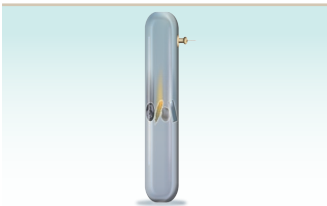
4.6 Al extraer casi totalmente el aire del interior del recipiente, se elimina la fricción y los cuerpos caen al mismo tiempo.
