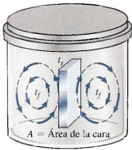
Figura 18.6 Cuando se coloca una placa caliente en un fluido frío, las corrientes de convección transfieren el calor lejos de la placa con una razón proporcional a la diferencia de temperaturas y al área de la misma placa.
