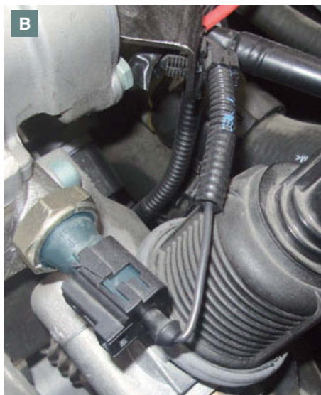
↑ Figura 2.21. A) Interruptor con accionamiento con presión. B) Interruptor por temperatura.
