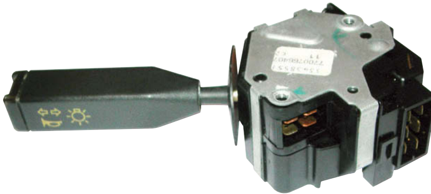
↑ Figura 8.20. Mando combinado y conexión eléctrica.
