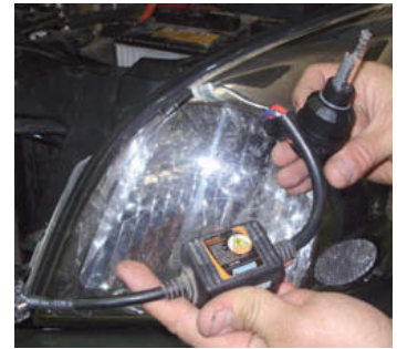
↑ Figura 5.13. Lámpara de xenón y reactancia.
