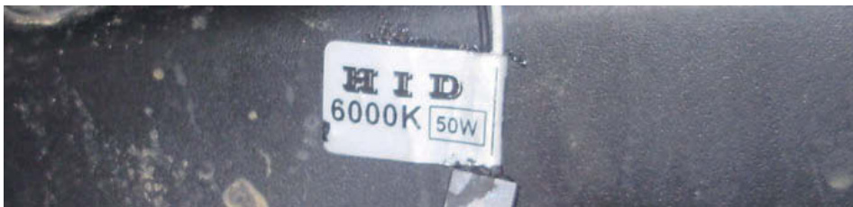
↑ Figura 5.6. Temperatura de color de una lámpara de xenón.
