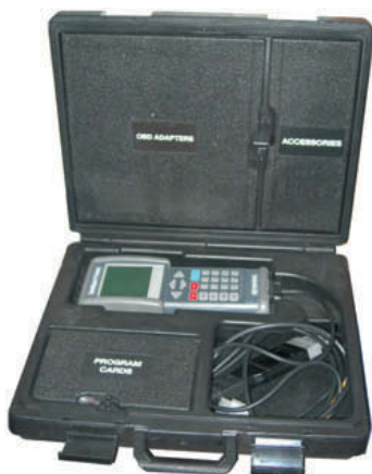
↑ Figura 7.27. Equipo de diagnóstico de circuitos electrónicos, tester de Toyota.
