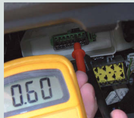
↑ Figura 3.69. Medición de la resistencia.
