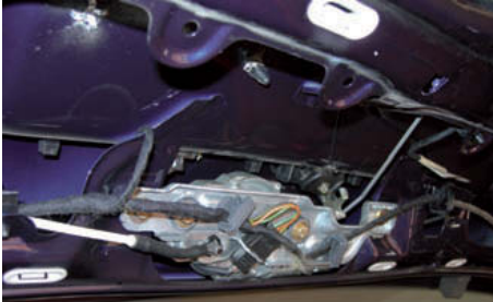
↑ Figura 10.25. Montaje del motor del limpiacristales trasero.
