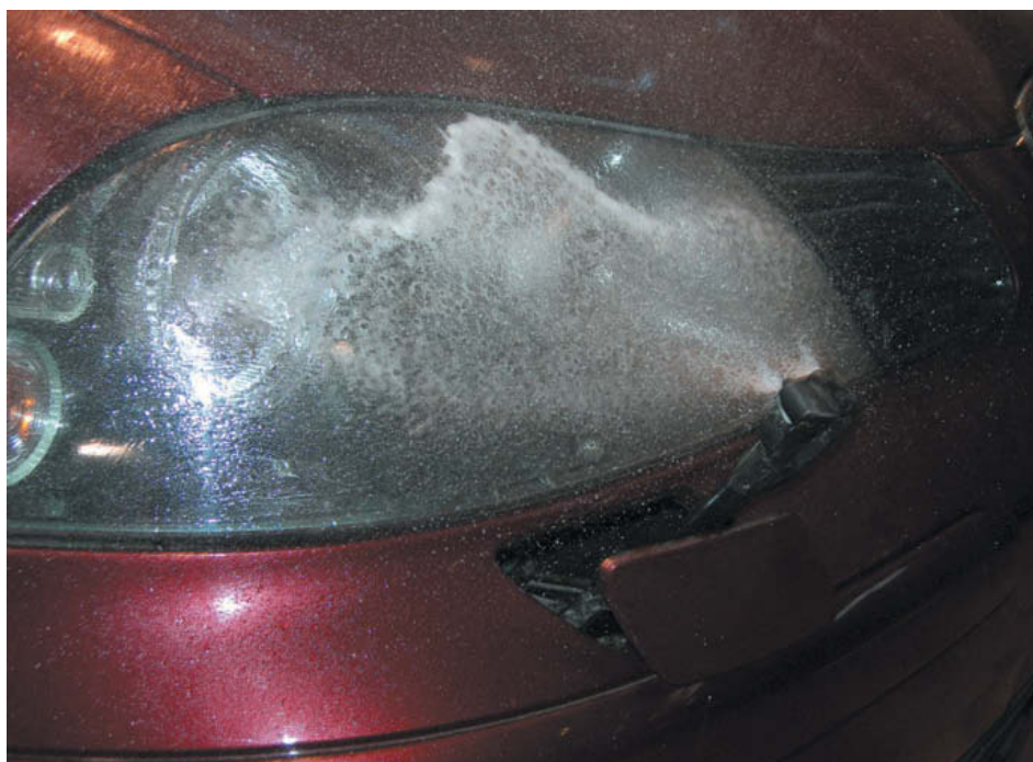
↑ Figura 10.24. Limpiafaros con chorro de lavado.
