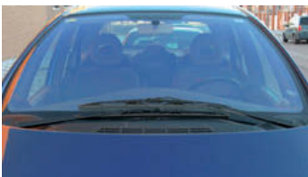
↑ Figura 10.10. Disposición de las escobillas en sentido contrario.
