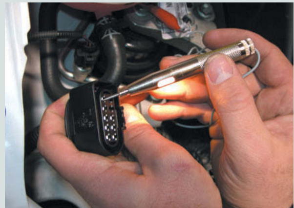
↑ Figura 6.72. Conector de faros y lámpara de pruebas.
