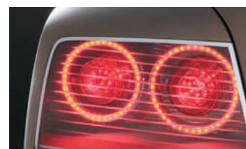
↑ Figura 7.19. Luz de frenos con diodos LED.
