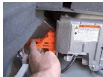
↑ Figura 1.42. Desconectador de alta tensión extraíble.
