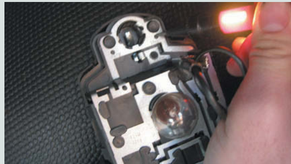
↑ Figura 7.36. Comprobar que llega corriente a la lámpara.
