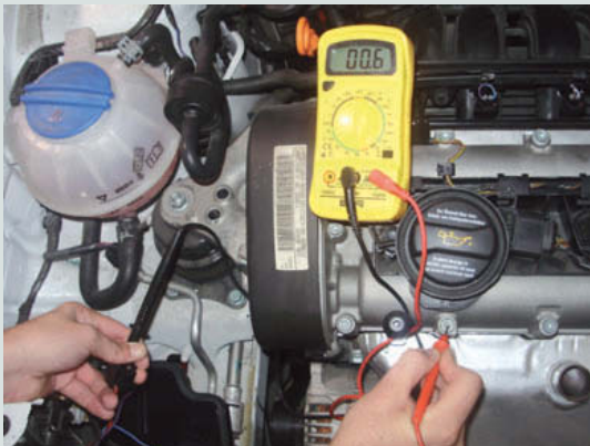
← Figura 1.50. Medida de la resistencia con el óhmetro.
