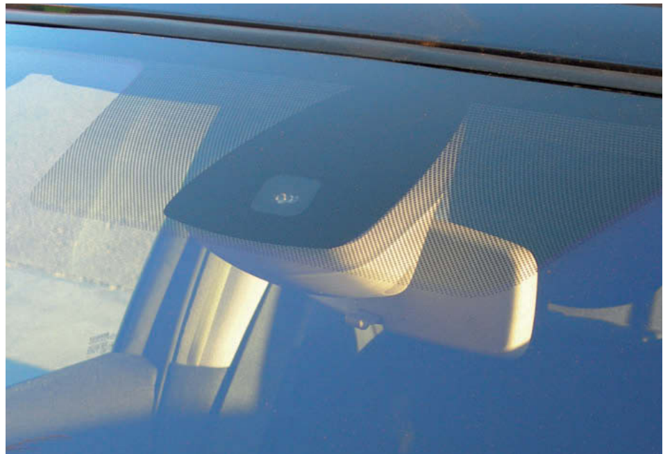
↑ Figura 10.20. Disposición del sensor de lluvia.
