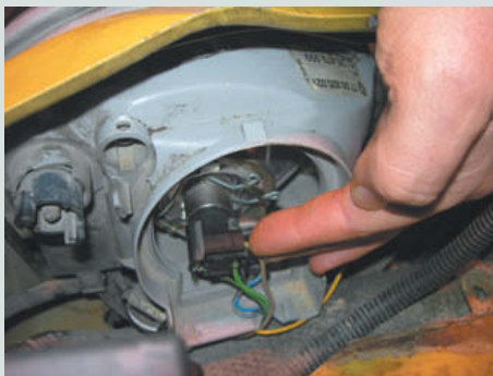
↑ Figura 5.23. Desconectar los cables.
