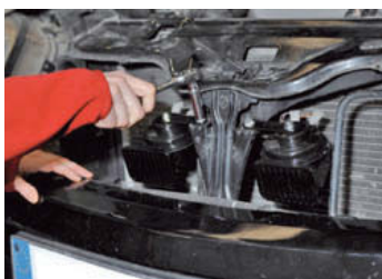
↑ Figura 8.25. Montaje de dos bocinas en un vehículo.
