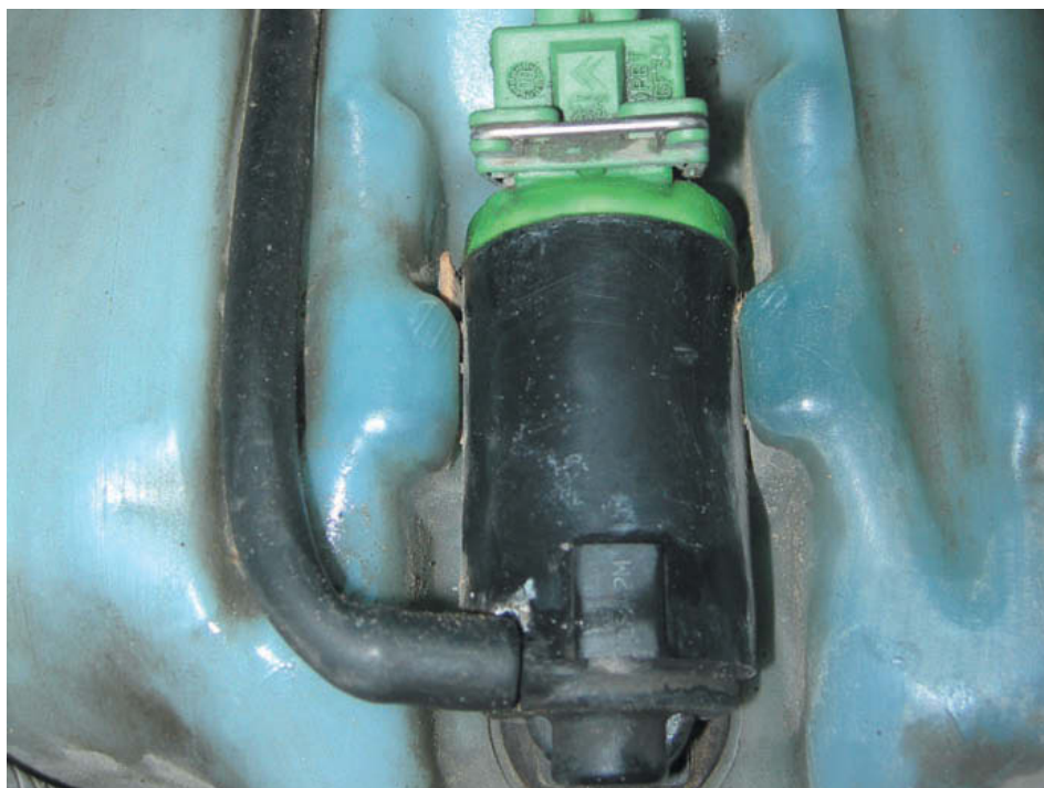
↑ Figura 10.17. Bomba de barrido del limpiacrystales.
