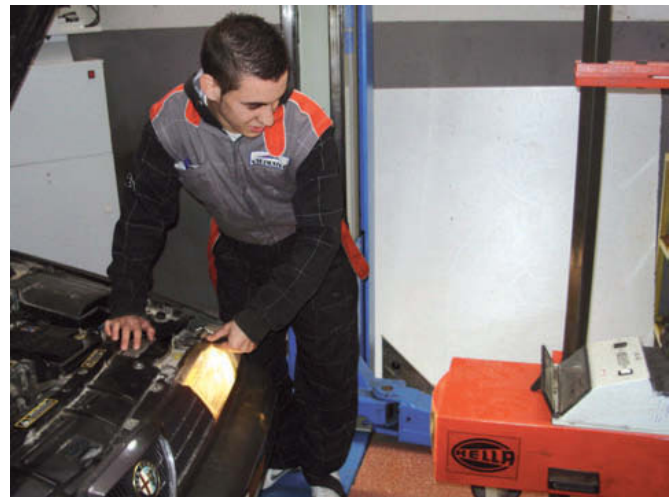
↑ Figura 6.54. Reglaje del faro.
