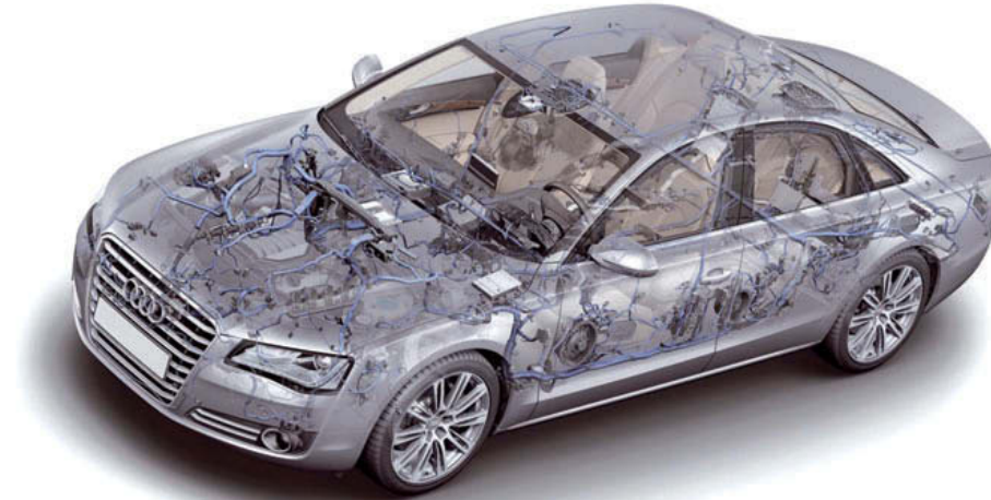
↑ Figura 3.19. Buses de datos en un vehículo de alta gama.
