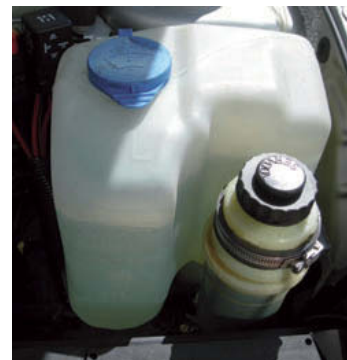
↑ Figura 10.12. Depósito del limpiaparabrisas junto al depósito de líquido para la dirección asistida.
