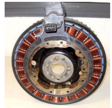
↑ Figura 2.35. Motor trifásico de corriente alterna sincrónico.
