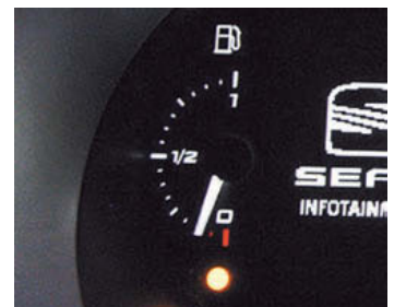
↑ Figura 9.35. Reloj indicador de nivel de combustible y testigo de reserva.
