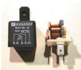
↑ Figura 2.24. Relé y esquemas internos y bornes de conexión de distintos relés.
