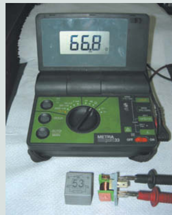
↑ Figura 8.29. Estado correcto de la bobina del relé.
