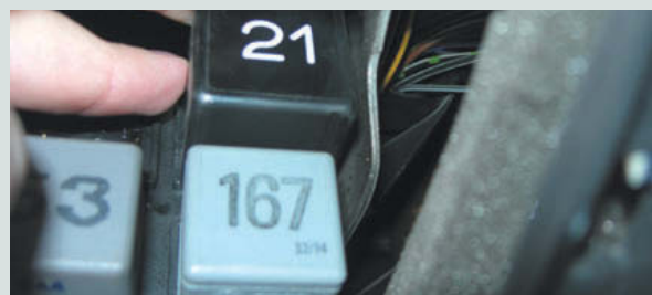
↑ Figura 7.32. Localización del relé de intermitencias.
