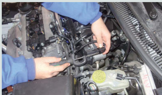
↑ Figura 2.49. Soltar el conector de alimentación.
