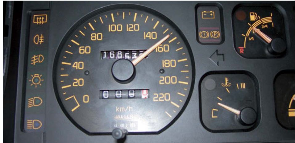
↑ Figura 9.9. Velocímetro mecánico.
