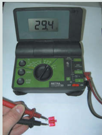
↑ Figura 8.28. Comprobación del fusible.
