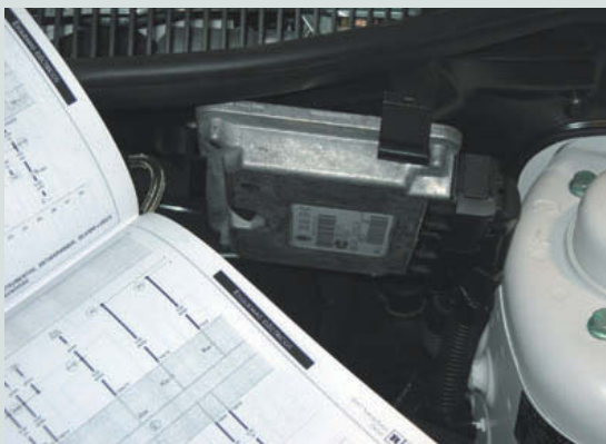
↑ Figura 2.44. Unidad de gestión del motor (centralita del motor).
