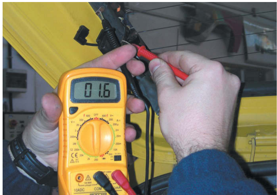
↑ Figura 10.34. Comprobación de la resistencia de la luneta térmica con el polímetro.
