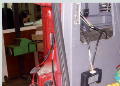
↑ Figura 7.44. Desmontar pilotos.
