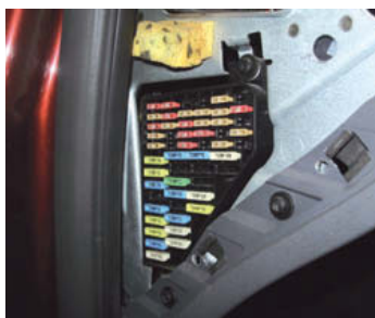
↑ Figura 1.21. Caja de fusibles colocada entre el lado del salpicadero y la puerta del conductor.
