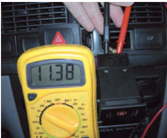
↑ Figura 10.33. Comprobación de la tensión de alimentación con el interruptor conectado.
