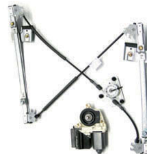
↑ Figura 10.53. Mecanismo de cable de tracción.
