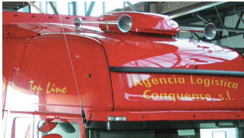
↑ Figura 8.17. Bocinas neumáticas montadas en un camión.
