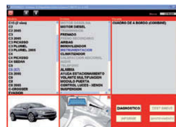
↑ Figura 4.6. Selección de la unidad de control con el equipo de diagnóstico Berton TDU.
