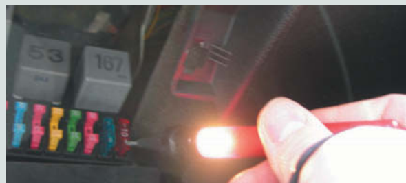
↑ Figura 7.30. Comprobación de la continuidad a través del fusible con la lámpara de prueba.
