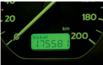
↑ Figura 9.19. Cuentakilómetros digital.
