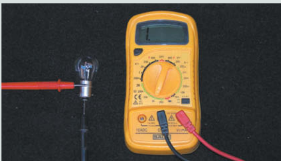
↑ Figura 7.37. Comprobación de la lámpara con el óhmetro.
