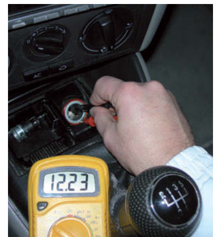
↑ Figura 10.51. Comprobación de la tensión de alimentación.
