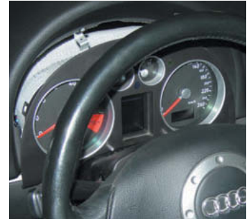
↑ Figura 9.38. Desmontaje de un cuadro de instrumentos.
