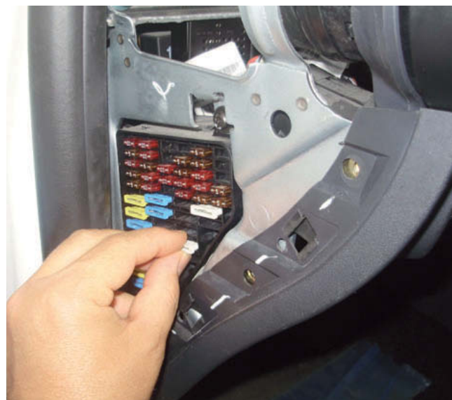
↑ Figura 1.32. Caja de fusibles del Seat Ibiza.
