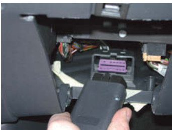
↑ Figura 4.1. Conexión del equipo de diagnóstico.
