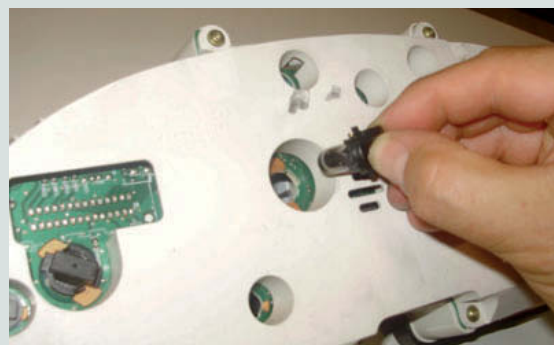
↑ Figura 5.31. Cambiar la lámpara fundida (ennegrecida).
