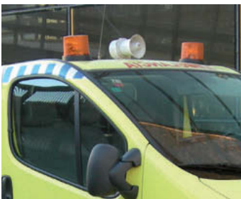
↑ Figura 8.2. Montaje de la sirena de un vehículo de transporte sanitario.
