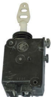
↑ Figura 10.61. Actuador de puerta electromecánico.
