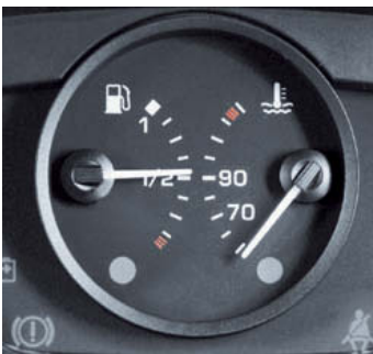
↑ Figura 9.32. Reloj de temperatura del motor (derecha) e indicador de nivel de combustible (izquierda).
