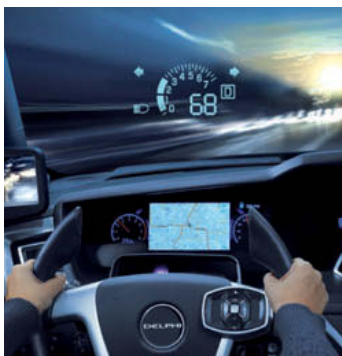
↑ Figura 9.1. Imagen virtual proyectada en el parabrisas.
