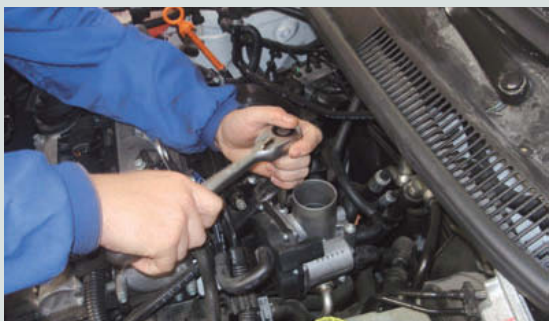
↑ Figura 2.50. Aflojar los tornillos de fijación.
