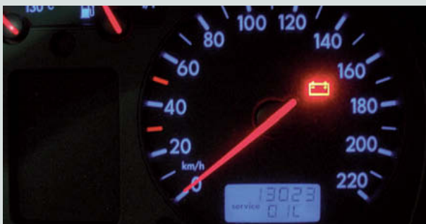
↑ Figura 9.57. Visualización «service INSP».
