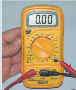
↑ Figura 1.48. Cambio de clavijas y selección de la escala.
