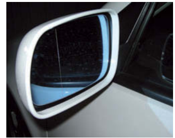
↑ Figura 10.35. Retrovisor térmico.
