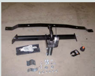
↑ Figura 7.39. Componentes mecánicos del gancho.
