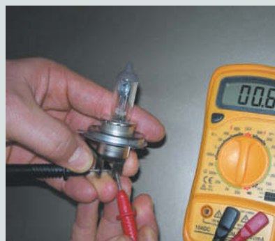
↑ Figura 5.26. Valor en ohmios de la resistencia.
