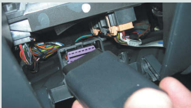
↑ Figura 4.33. Conexión del conector al vehículo.
