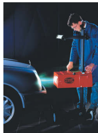
↑ Figura 6.52. Ajuste de altura del regloscopio.
