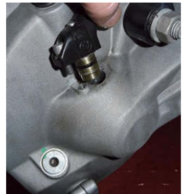
↑ Figura 9.15. Sensor para el velocímetro de un scooter.
