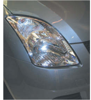
↑ Figura 6.26. Faro principal con difusor plástico, Suzuki Swift.
