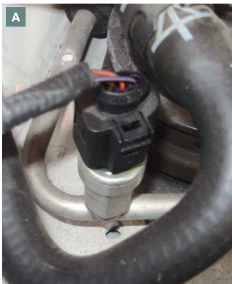
↑ Figura 2.21. A) Interruptor con accionamiento con presión. B) Interruptor por temperatura.
