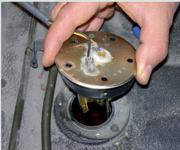
↑ Figura 9.53. Desmontaje del aforador del depósito de combustible.
