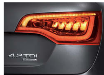
↑ Figura 5.20. Pilotos traseros con diodos LED.
