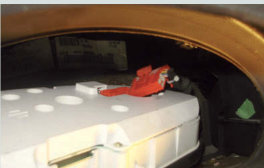
↑ Figura 5.30. Clema de conexión eléctrica del cuadro.
