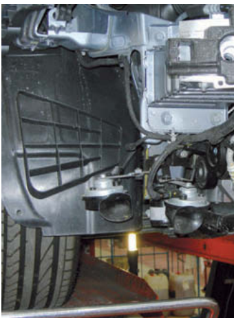
↑ Figura 8.6. Montaje de las bocinas de un automóvil.
