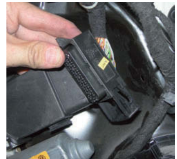
↑ Figura 10.56. Clavija de conexión de la unidad de control del elevallunas.
