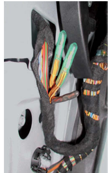
↑ Figura 3.38. Nudos del cableado.
