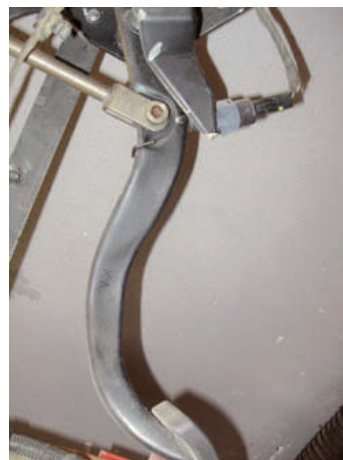
↑ Figura 2.20. Interruptor del pedal de frenos.
