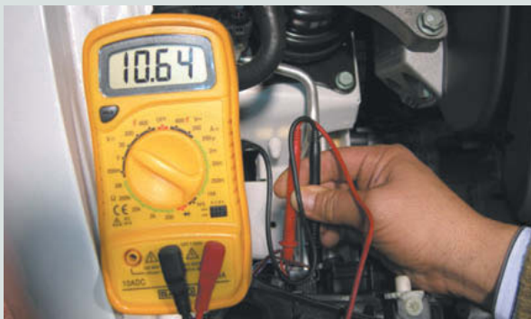
↑ Figura 6.75. Tensión de alimentación baja.
