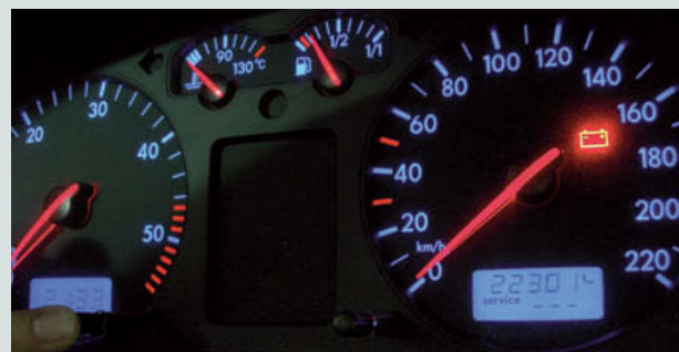
↑ Figura 9.58. Reposición del intervalo de servicio.
