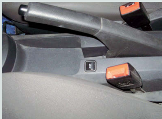
↑ Figura 2.47. Interruptor de anulación del ESP.
