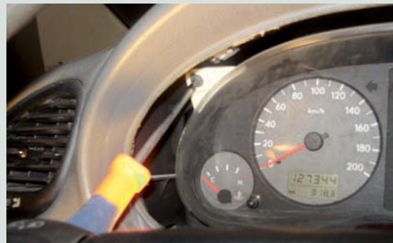
↑ Figura 5.29. Soltar el cuadro de la fijación atornillada.
