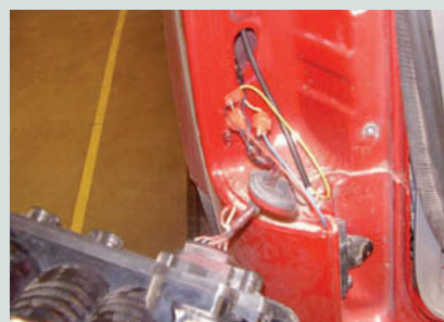
↑ Figura 7.45. Pinzar los cables de señal.
