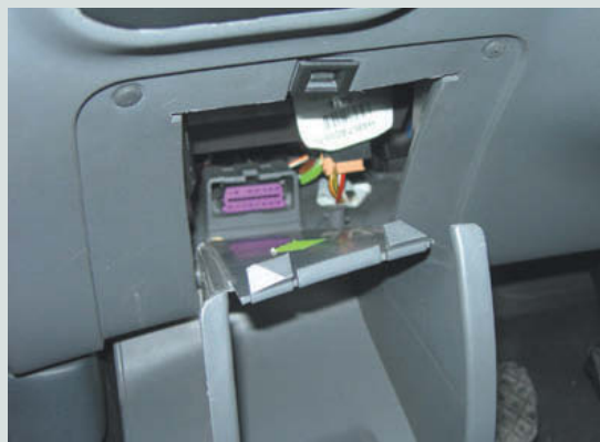
↑ Figura 2.45. Conexión OBD de diagnosis.
