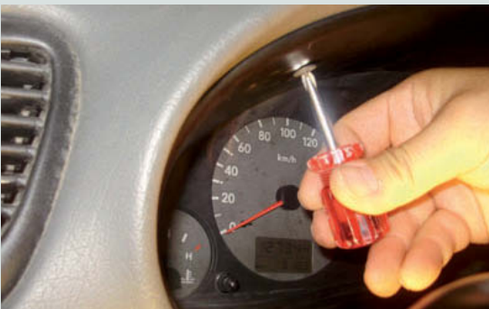
↑ Figura 5.28. Aflojar tornillos del embellecedor.
