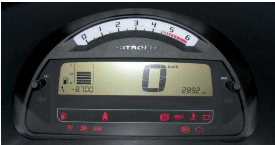
↑ Figura 9.16. Velocímetro digital.
