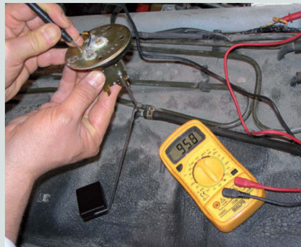
↑ Figura 9.54. Comprobación de la resistencia del aforador.
