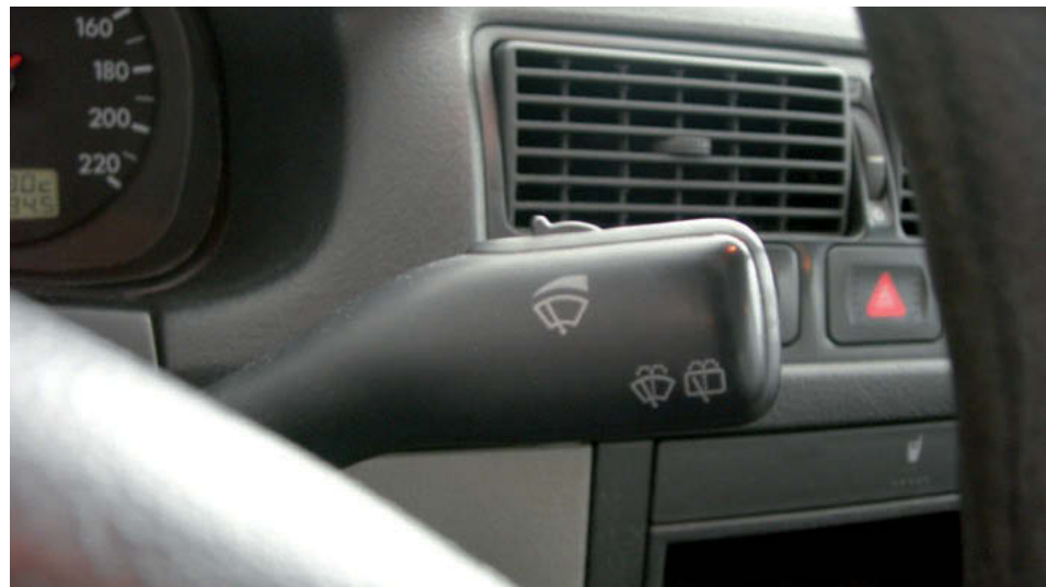
↑ Figura 10.18. Palanca del limpiaparabrisas y reóstato de regulación.
