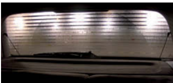
↑ Figura 10.29. Desempañado de la luneta trasera.
