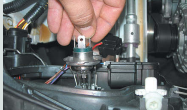
↑ Figura 6.74. Sustituir la lámpara fundida.
