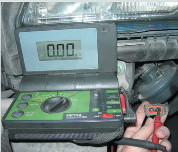
↑ Figura 8.32. Comprobación de la tensión de alimentación en la clema.
