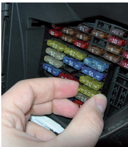
↑ Figura 10.49. Comprobación visual del fusible.
