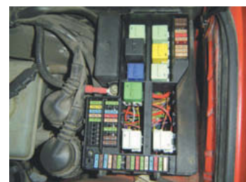
↑ Figura 2.25. Caja eléctrica colocada en el vano motor, BMW 318 tds.
