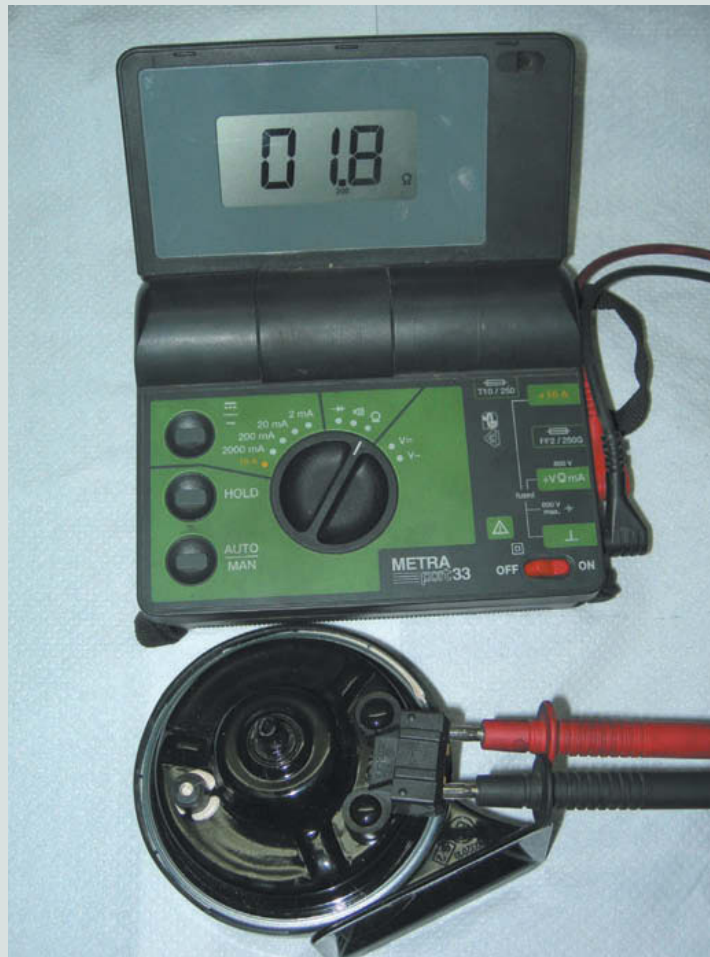
↑ Figura 8.31. Comprobación de la resistencia de la bobina.
