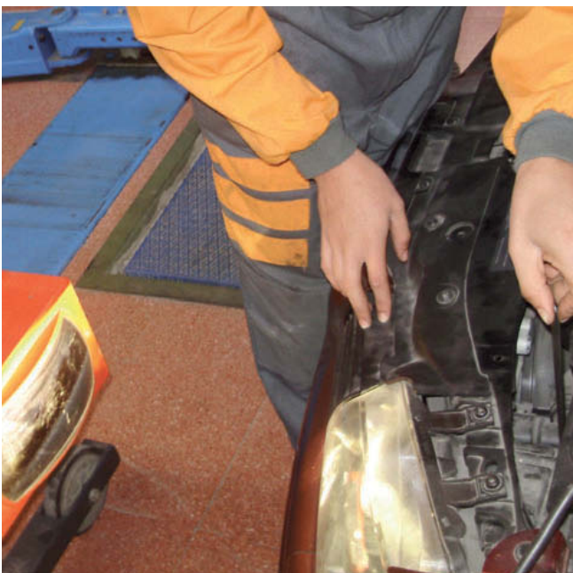
↑ Figura 6.63. Reglaje de faros actuando en el tornillo.
