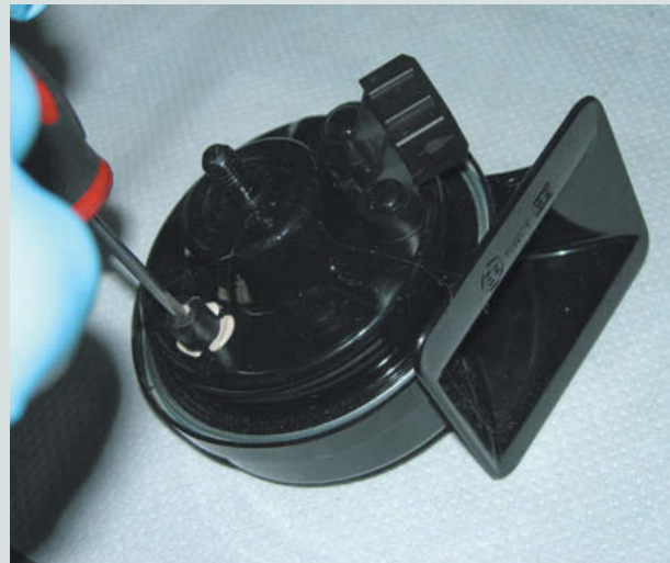
↑ Figura 8.33. Regulación del sonido de la bocina.
