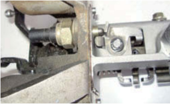
↑ Figura 7.22. Interruptor de luz de marcha atrás.
