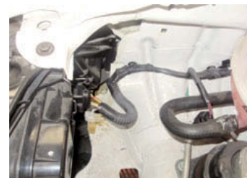
↑ Figura 1.17. Mazo de cables con abrazaderas.
