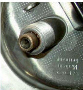
↑ Figura 9.11. Conexión del cable.
