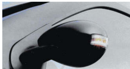
↑ Figura 7.11. Intermitente LED en retrovisor.
