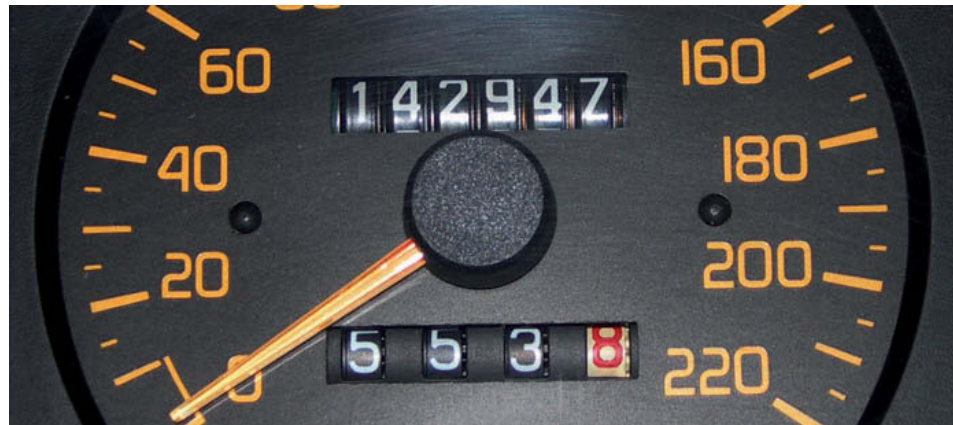
↑ Figura 9.18. Cuentakilómetros mecánico total y parcial.
