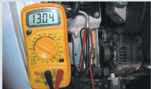
↑ Figura 6.76. Tensión de alimentación correcta.
