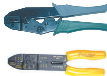
↑ Figura 1.28. Alicates para engatillar terminales faston.
