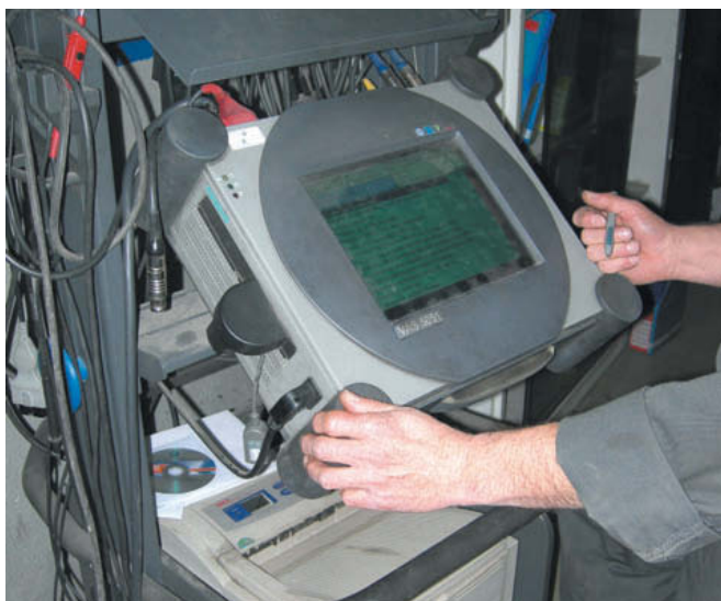
↑ Figura 4.11. Lectura y borrado de averías con el equipo de diagnóstico.
