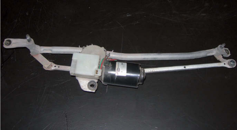
↑ Figura 10.6. Montaje del motor del limpiaparabrisas con el varillaje.
