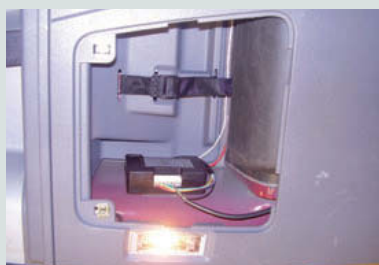
↑ Figura 7.47. Fijar la centralita.
