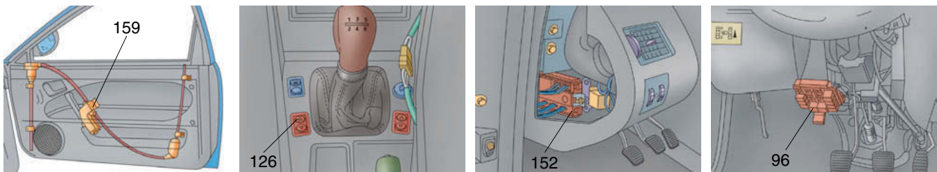
↑ Figura 1.9. Esquema de la situación de los componentes eléctricos en el vehículo.
