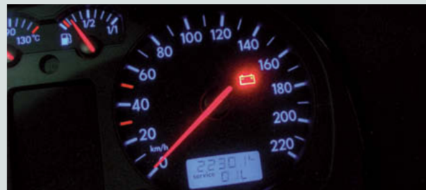
↑ Figura 9.56. Visualización «service OIL».
