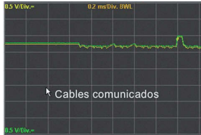
↑ Figura 3.56. Cables comunicados en el FlexRay.
