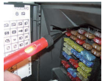
↑ Figura 10.43. Comprobación del fusible de la luz de cortesía.
