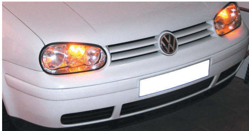
→ Figura 7.26. Intermitentes de emergencia.
