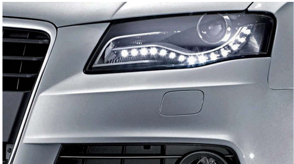
↑ Figura 6.70. Faro de luz día con diodos.
