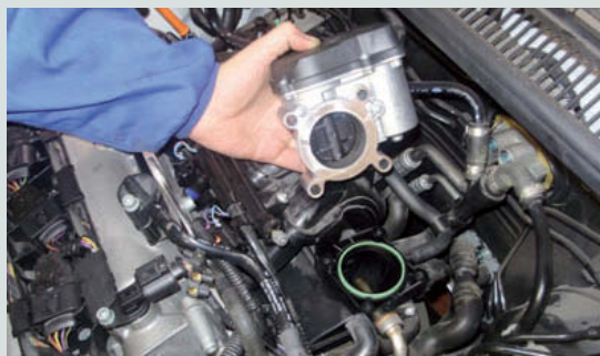
↑ Figura 2.51. Sustituir la caja dañada por una de recambio.
