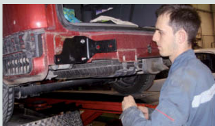
↑ Figura 7.41. Montar las fijaciones del gancho al chasis.
