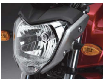
↑ Figura 6.28. Reflector multifocal de una motocicleta.
