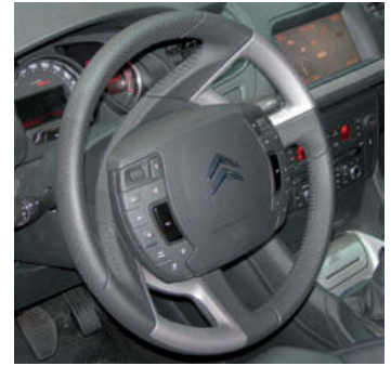
↑ Figura 8.19. Mando de accionamiento de la bocina en el volante.
