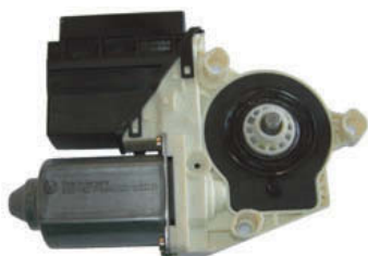
↑ Figura 10.55. Motor eléctrico con unidad de control integrada.
