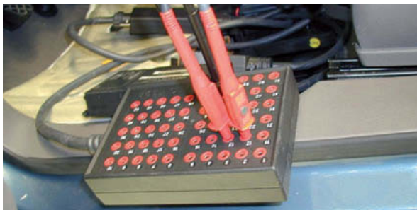
← Figura 3.39. Localización de averías en la red CAN con el equipo de diagnóstico y caja de conexiones.
