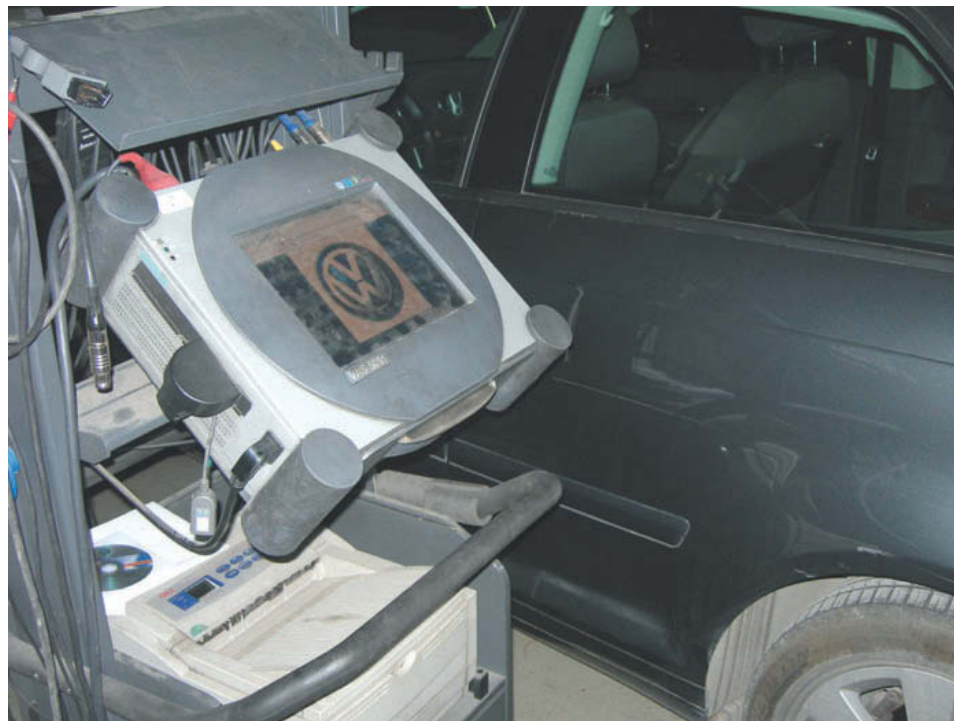
↑ Figura 4.2. Verificación de un vehículo con el equipo de diagnóstico del fabricante.
