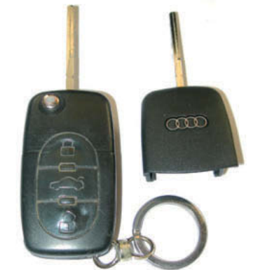
↑ Figura 10.65. Llave con sistema de control remoto.
