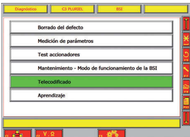
↑ Figura 4.23. Selecci3n de la funci3n de telecodificado en el equipo de diagnosis Lexia del grupo PSA.
