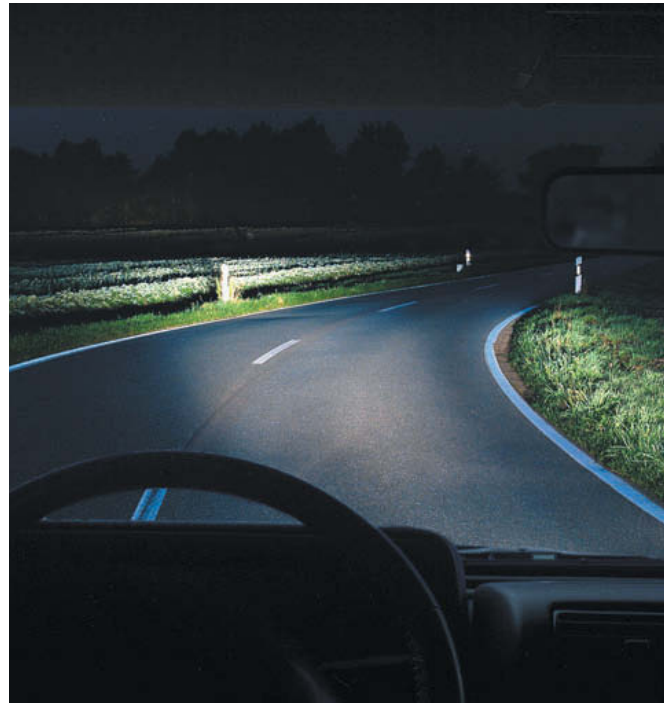
↑ Figura 6.43. Luz de curva o viraje estática.
