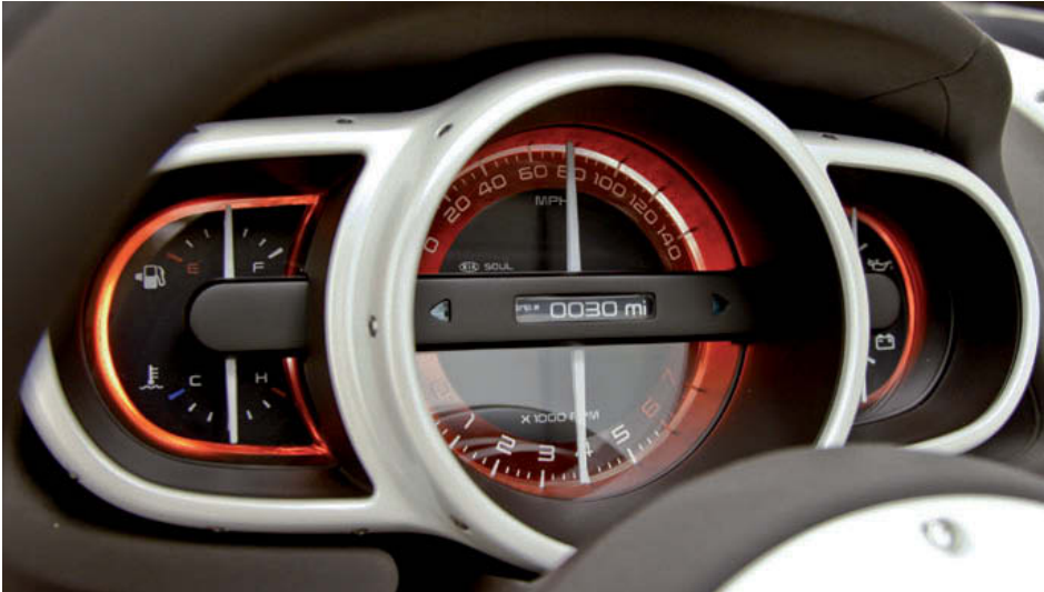
↑ Figura 9.22. Cuentarrevoluciones integrado con el velocímetro.
