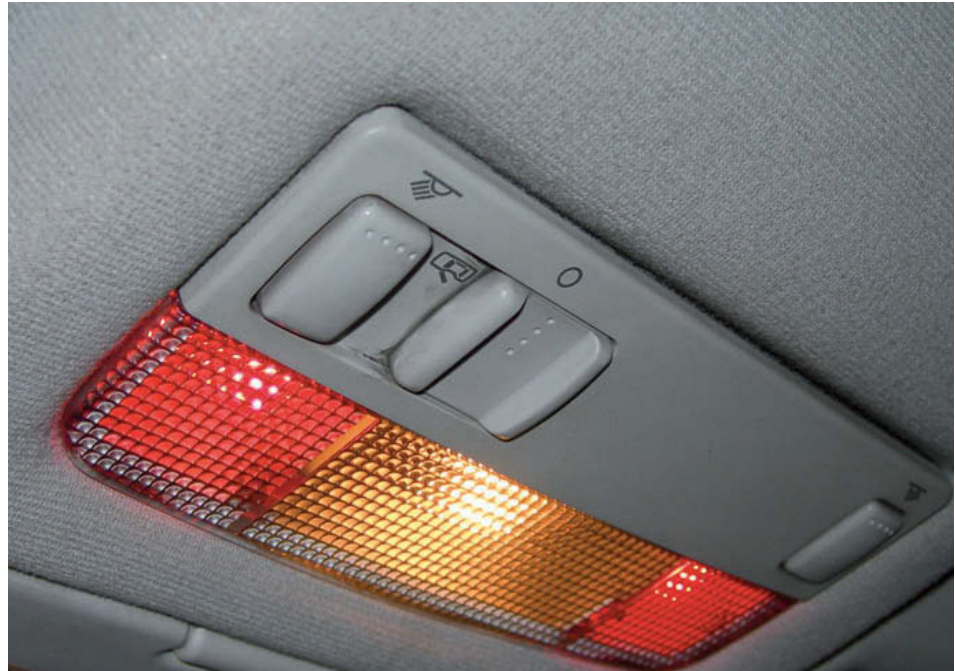
↑ Figura 10.39. Plafón central de techo con interruptores de accionamiento manual.
