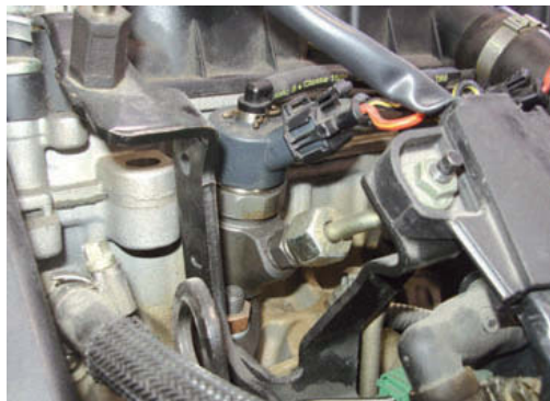
↑ Figura 2.42. Bobinado del inyector HDI.
