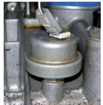
↑ Figura 9.29. Montaje del manocontacto en el motor.
