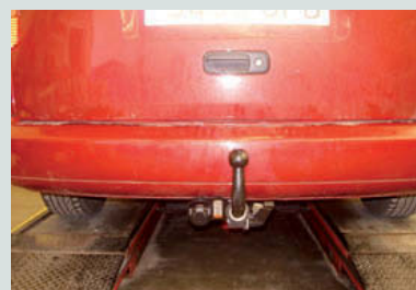
↑ Figura 7.48. Conector eléctrico y gancho montado.
