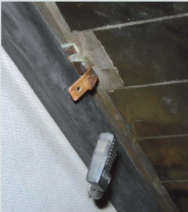
↑ Figura 10.66. Desconexión de la clema de la luneta térmica.
