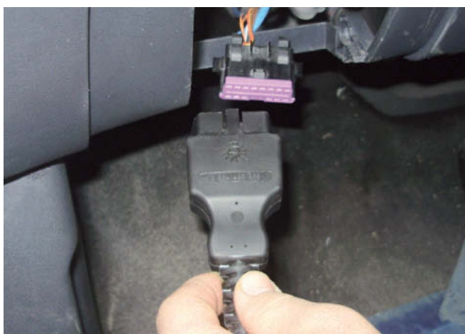
↑ Figura 6.58. Conectar el equipo al vehículo y seleccionar el modelo en el equipo de diagnóstico.
