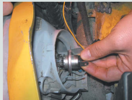
↑ Figura 5.24. Extraer la lámpara.
