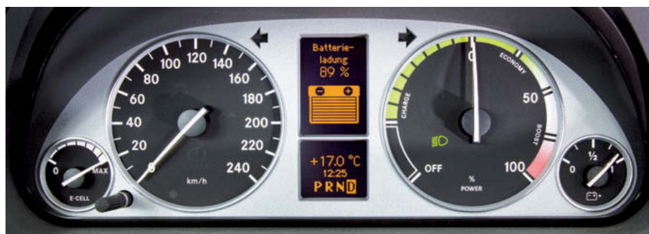
↑ Figura 9.37. Cuadro de instrumentos de un vehículo híbrido.
