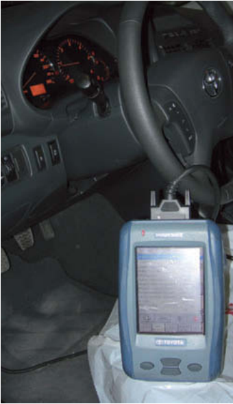
↑ Figura 4.25. Lector de averías téster de Toyota.
