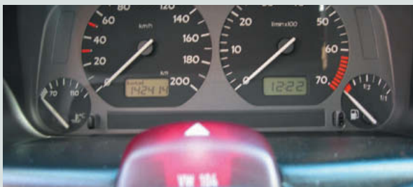
↑ Figura 7.29. Pulsando el interruptor, los intermitentes no funcionan (ni la lámpara ni el indicador óptico).
