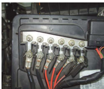
↑ Figura 1.20. Fusibles de lámina planos de gran intensidad.
