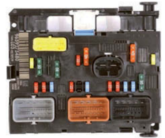
↑ Figura 3.25. Unidad de control central para la conexión de diferentes redes denominada BSI por el grupo Citroën.
