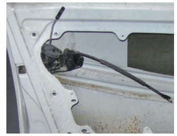
↑ Figura 10.62. Unidad de cerradura y cableado para el accionamiento manual.
