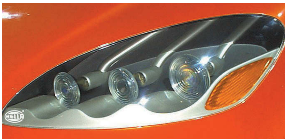
↑ Figura 2.38. Faro con fibra óptica (Volvo SCC).
