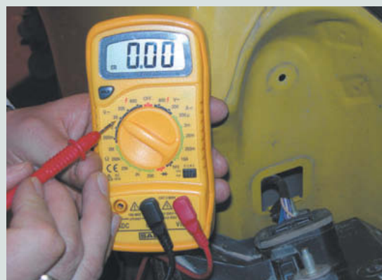
↑ Figura 1.44. Seleccionar la escala adecuada.
