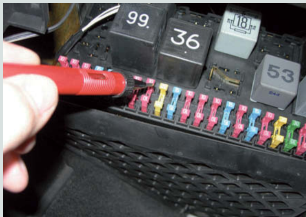
↑ Figura 10.69. Comprobación del fusible de alimentación.
