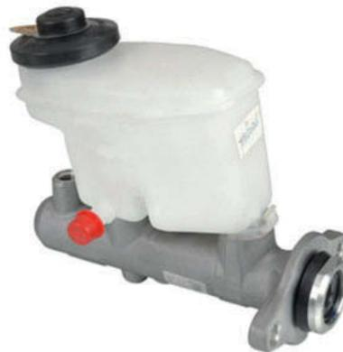
↑ **Figura 8.56.** Bomba de dos émbolos con depósito.
