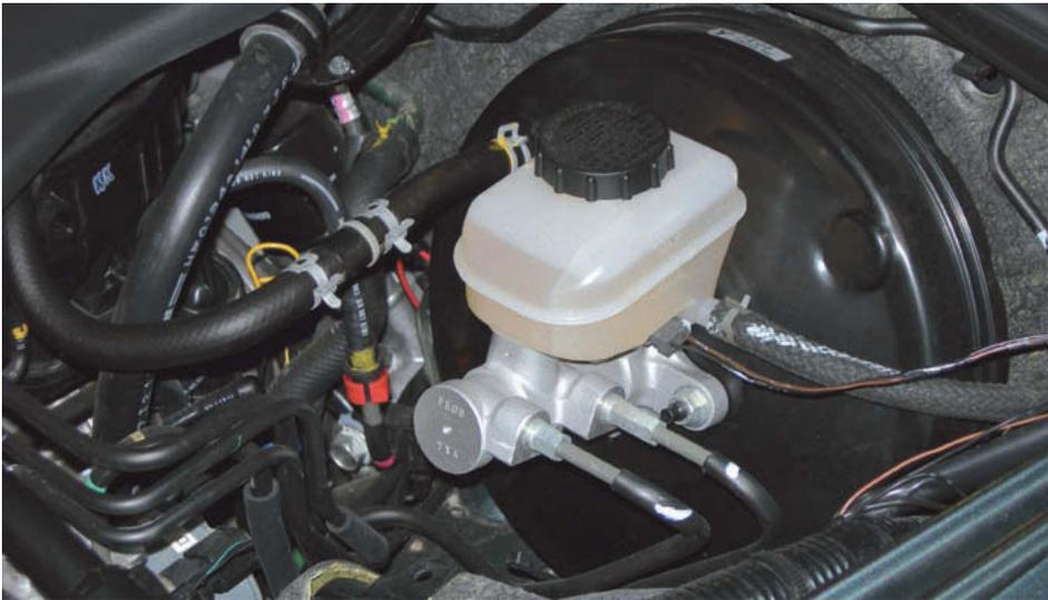
↑ Figura 8.64. Montaje del servofreno.
