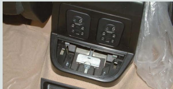
↑ Figura 12.44. Tornillo de ajuste de los cables de tensado de las zapatas.
