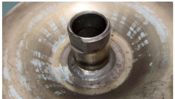
↑ **Figura 2.52.** Rebaje del eje del convertidor.
