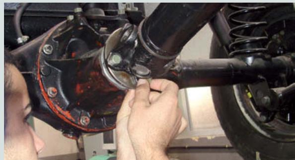
↑ **Figura 2.83.** Montar la transmisión trasera.
