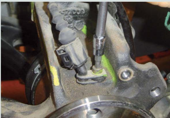
↑ **Figura 10.58.** Tornillo de fijación del captador.
