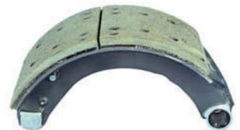
↑ **Figura 8.5.** Zapata de freno con forro remachado e intercambiable.
