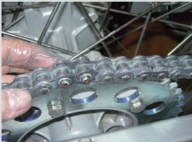
↑ **Figura 1.76.** Montaje del eslabón de la cadena.
