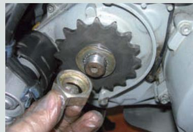
↑ **Figura 1.72.** Montaje de la chapa de retención de la tuerca de sujeción del piñón.
