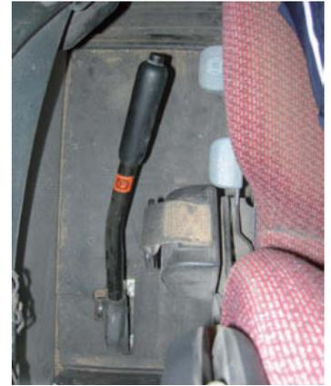
↑ **Figura 12.32.** Palanca del freno de estacionamiento de un vehículo agrícola.
