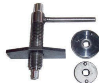
↑ **Figura 9.25.** Útil para el retroceso de los émbolos en pinzas con freno de mano.
