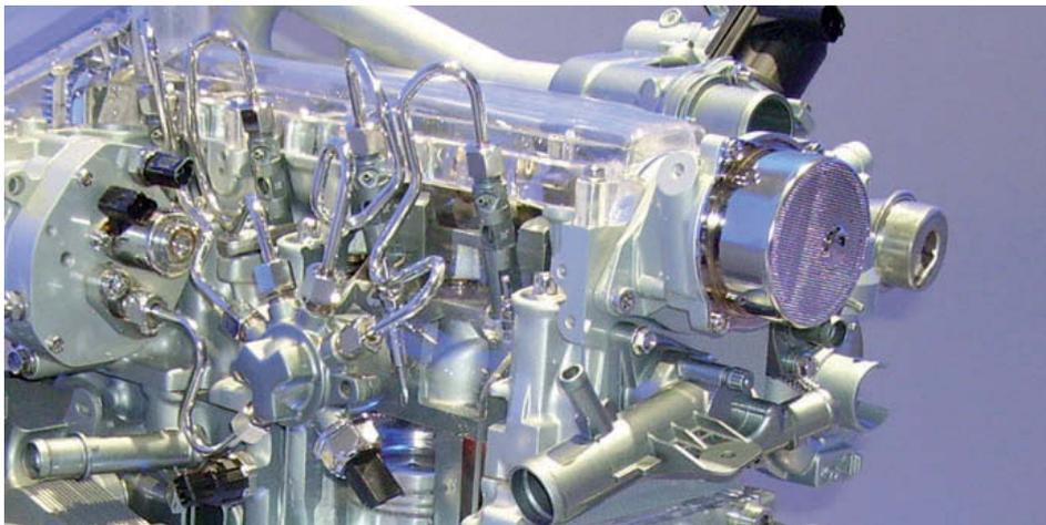
↑ **Figura 8.78.** Montaje de la bomba de vacío en el eje del árbol de levas de un motor diésel.
