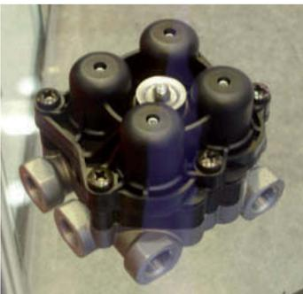
↑ Figura 11.12. Válvula de cuatro circuitos.
