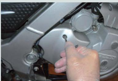
↑ **Figura 1.49.** Desmontaje de la tapa protectora del piñón.
