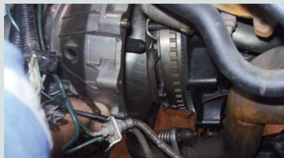
↑ **Figura 2.77.** Separar el cambio del motor.
