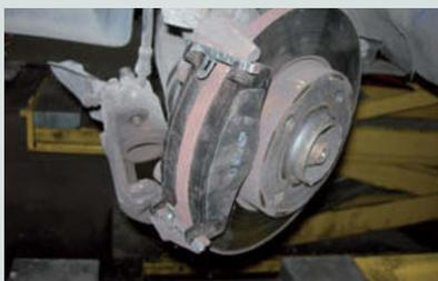
↑ Figura 9.58. Montaje de la pastilla interior y de las trabitas metálicas.
