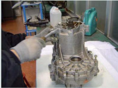
↑ **Figura 3.88.** Aflojar los tornillos de las carcasas.
