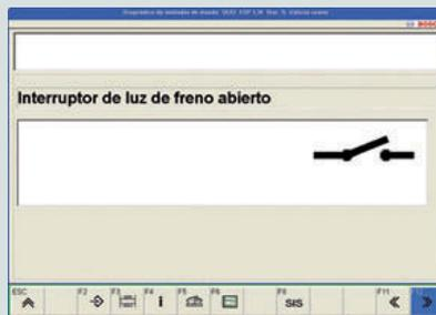
↑ **Figura 10.69.** Identificación de la posición del interruptor de luz de freno (abierto).
