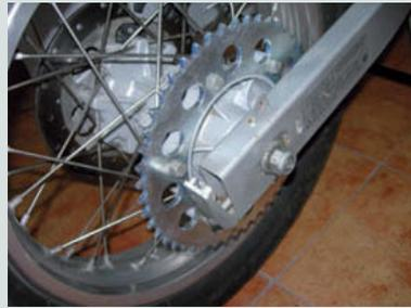
↑ **Figura 1.74.** Rueda montada sin fijar.
