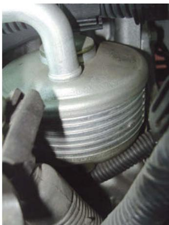
↑ **Figura 2.63.** Intercambiador refrigerante-aceite del cambio automático AG4.
