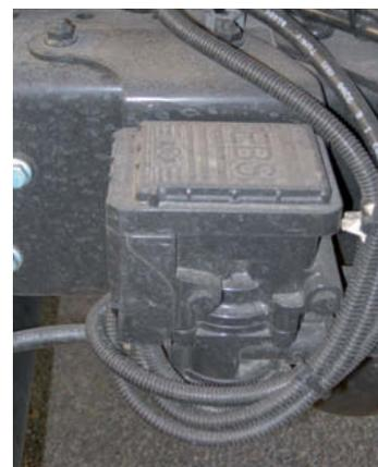
↑ **Figura 11.50.** Módulo EBS montado en el vehículo.
