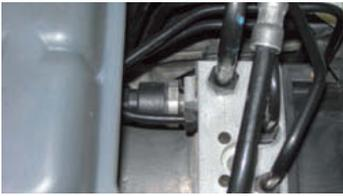
↑ **Figura 10.38.** Sensor de presión de frenado.
