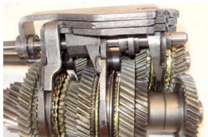
↑ **Figura 3.75.** Conjunto de varillas y horquillas.
