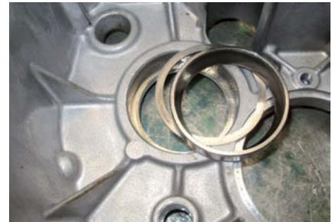
↑ **Figura 3.74.** Arandela de precarga del rodamiento de rodillos cónicos.
