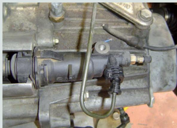
↑ **Figura 2.67.** Desconectar la canalización de entrada de líquido al bombín.
