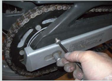
↑ **Figura 1.56.** Extracción de los tornillos del guardabarros trasero y protector de la cadena.
