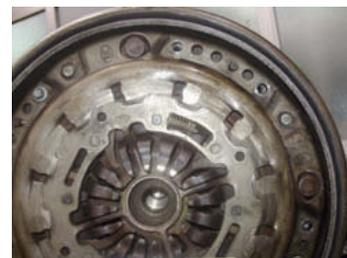
↑ **Figura 2.42.** Mecanismo corrector del desgaste del disco.
