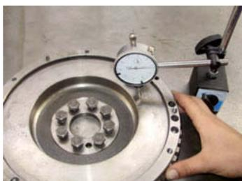
↑ **Figura 2.45.** Comprobación de la superficie de apoyo del volante de inercia.
