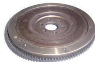
↑ Figura 2.18. Volante de inercia con corona dentada.
