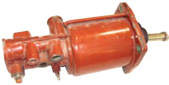
↑ **Figura 2.34.** Accionamiento hidroneumático de un embrague de camión.
