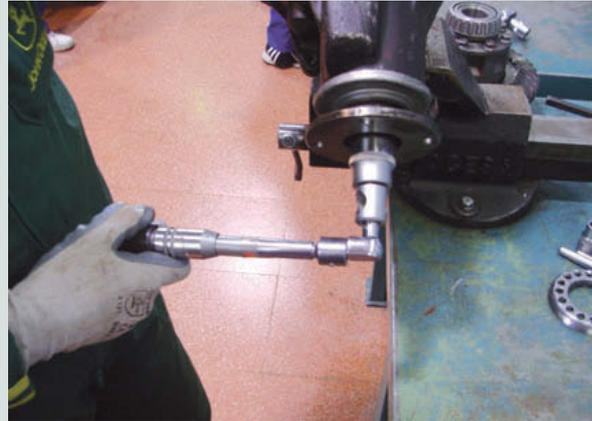
↑ **Figura 5.61.** Par de rodadura del piñón.
