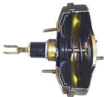
↑ **Figura 8.68.** Sección de un servofreno.
