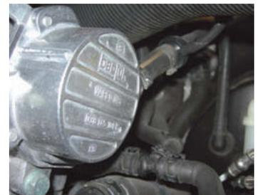
↑ Figura 8.67. Canalización para el vacío que une la bomba de vacío con el servofreno.
