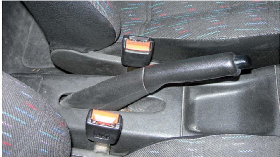
↑ **Figura 12.11.** Palanca para el freno de estacionamiento.
