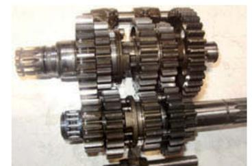
↑ **Figura 3.10.** Piñones de dentado recto y mecanismo selector de velocidad de una Kawasaki.
