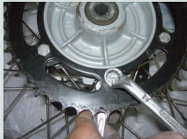
↑ **Figura 1.59.** Desmontaje de la corona de la rueda.
