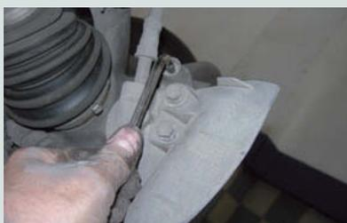
↑ Figura 9.50. Extracción de los tornillos de fijación de la pinza.
