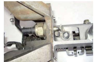
↑ **Figura 3.78.** Interruptor de marcha atrás de un cambio de un Mercedes clase A.
