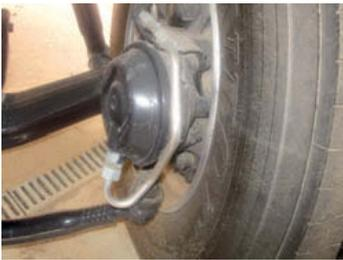
↑ **Figura 11.18.** Montaje del cilindro de membrana en la rueda delantera.
