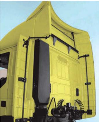
↑ **Figura 1.6.** Kit aerodinámico de una cabeza tractora.
