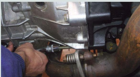
↑ **Figura 2.76.** Aflojar los tornillos de fijación.
