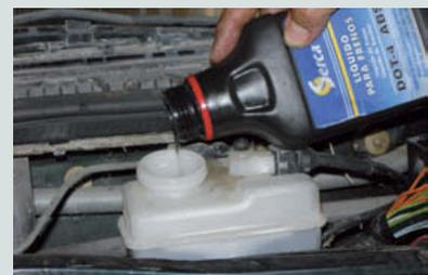
↑ **Figura 8.120.** Verter líquido de frenos al depósito.
