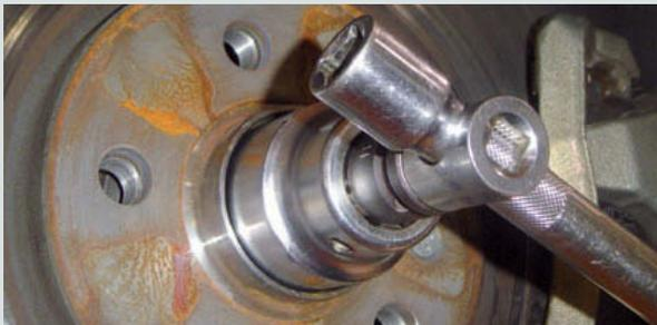
↑ **Figura 6.55.** Aflojar la tuerca de la transmisión.
