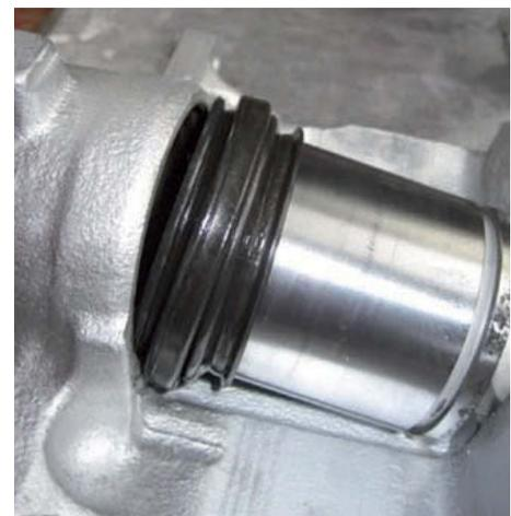
↑ **Figura 9.20.** Montaje del émbolo de la pinza.
