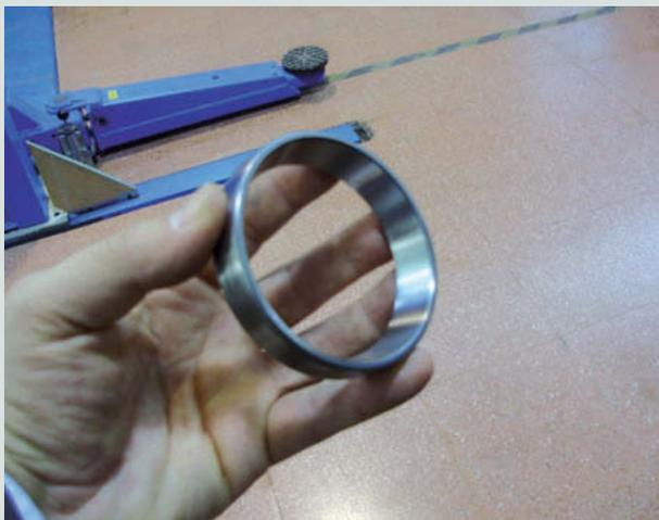
↑ **Figura 5.58.** Pista del rodamiento.
