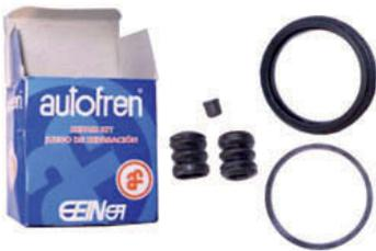
↑ **Figura 9.18.** Kit de reparación de la pinza de freno.
