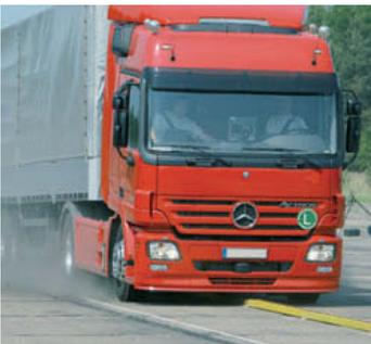
↑ **Figura 7.5.** Prueba dinámica de la eficacia de frenado de un vehículo industrial.
