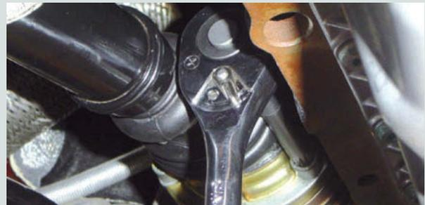
↑ **Figura 6.56.** Quitar los tornillos del acoplamiento en la salida del diferencial.
