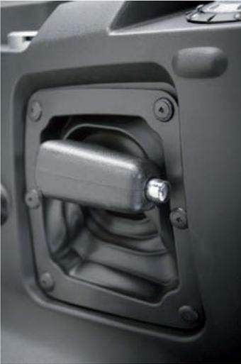
↑ **Figura 12.1.** Tirador para el freno de estacionamiento en una scooter.
