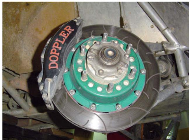
↑ Pinza de freno y disco montada en el vehículo.
