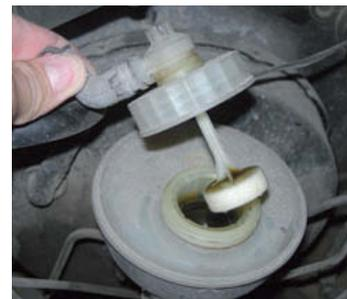
↑ **Figura 8.98.** Sensor de nivel del líquido de frenos.
