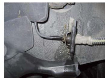
↑ **Figura 9.3.** Fuga de líquido de frenos por la unión entre una tubería y un latiguillo de freno.
