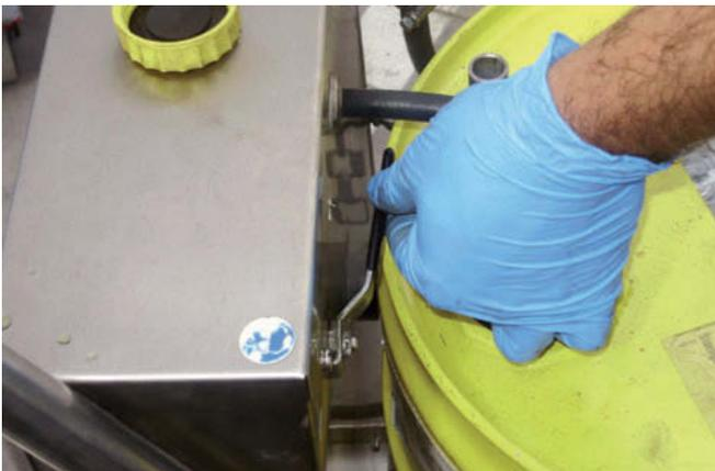
↑ **Figura 9.9.** Apertura de la llave de paso del equipo. Entrada de líquido a presión al circuito del vehículo.
