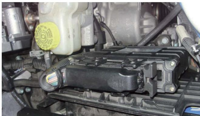
↑ Figura 4.36. Módulo electrónico del cambio independiente.
