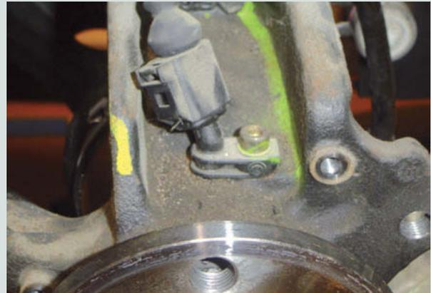
↑ **Figura 10.57.** Captador montado en la mangueta.
