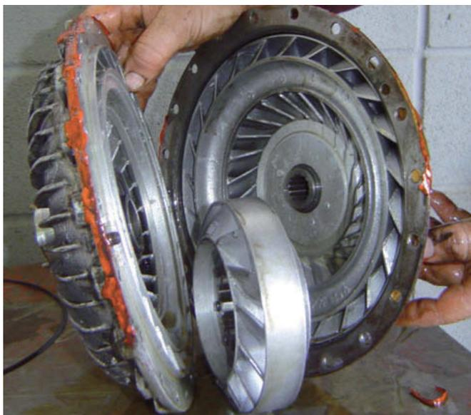
↑ Figura 2.53. Conjunto convertidor (turbina, reactor y bomba).
