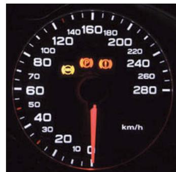
↑ **Figura 8.99.** Testigo de avería o desgaste de las pastillas de freno o nivel bajo de líquido de frenos, testigo de accionamiento del freno de estacionamiento y testigo de avería del ABS.
