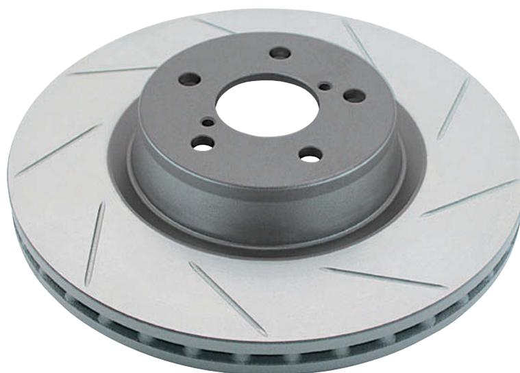
↑ **Figura 8.32.** Disco de freno ventilado y ranurado.
