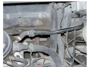
↑ Figura 8.65. Canalización para el vacío que une el colector con el servofreno.
