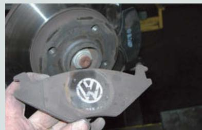
↑ Figura 9.54. Pastilla interior (muestra contacto con el émbolo)
