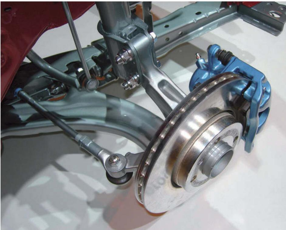
↑ **Figura 8.29.** Montaje de freno de disco.
