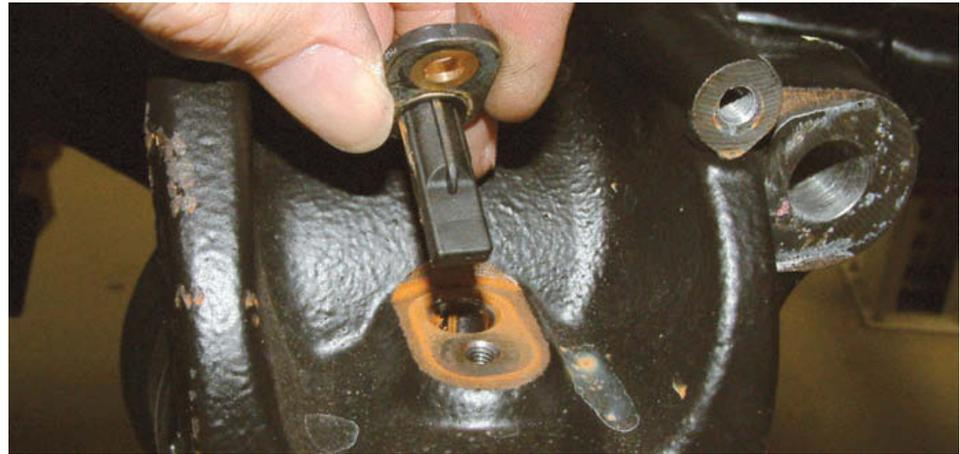
→ **Figura 10.9.** Montaje del sensor de ruedas en la mangueta.
