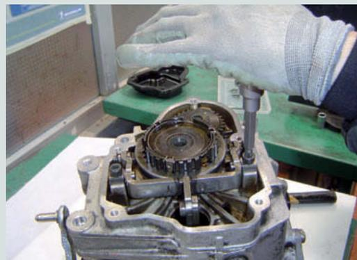
↑ **Figura 3.84.** Desmontar el mecanismo de accionamiento de 5ª velocidad.
