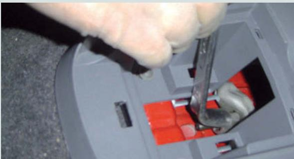
↑ **Figura 12.39.** Tensado de los cables del freno.
