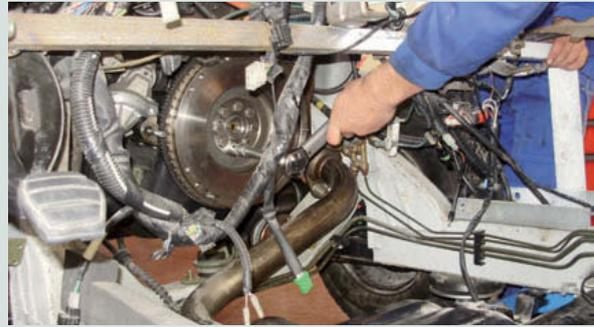
↑ **Figura 2.79.** Apretar al par los tornillos del volante.
