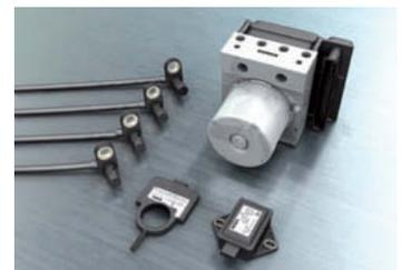
↑ Figura 10.31. Principales componentes del programa electrónico de estabilidad.
