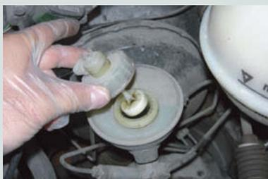
↑ **Figura 8.109.** Desmontaje del tapón con el sensor.
