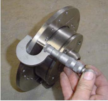
↑ **Figura 9.26.** Verificación del espesor del disco con un micrómetro.
