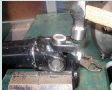
↑ Figura 6.60. Desmontar la junta cardán.
