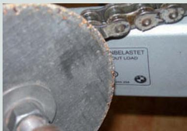
↑ **Figura 1.65.** Desbastado de un engranaje de la cadena.
