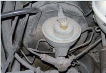
↑ **Figura 8.102.** Bomba de freno con depósito y sensor de nivel en el tapón, válvulas compensadoras y servofreno.
