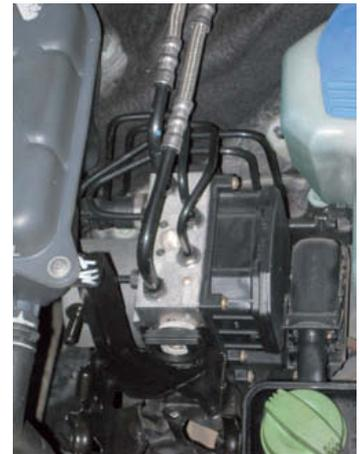
↑ **Figura 10.44.** ABS Bosch 5.7 con ESP de Bosch.
