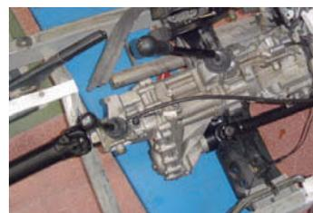
↑ **Figura 6.6.** Tracción delantera acoplable con palanca.
