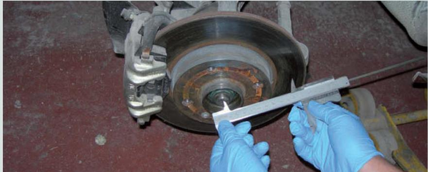
↑ **Figura 7.23.** Medición del radio del disco de freno.
