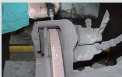
↑ Figura 9.49. Separación de las pastillas con el disco.
