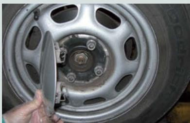
↑ Figura 9.47. Extracción del tapacubos.
