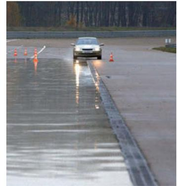
↑ **Figura 10.13.** Prueba de frenado del vehículo ante dos superficies con diferente coeficiente de fricción.
