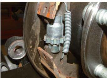
↑ **Figura 12.6.** Dispositivo de ajuste de las zapatas contra el disco de freno.
