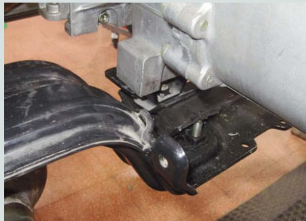
↑ Figura 2.73. Tornillo de fijación al taco elástico.
