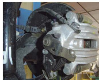
↑ **Figura 9.35.** Palanca de accionamiento de las pastillas del freno de estacionamiento.
