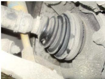
↑ **Figura 6.49.** Fuelle de transmisión con una rotura.
