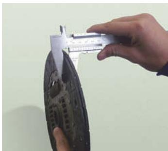
↑ **Figura 2.44.** Medida del espesor del disco con calibre.
