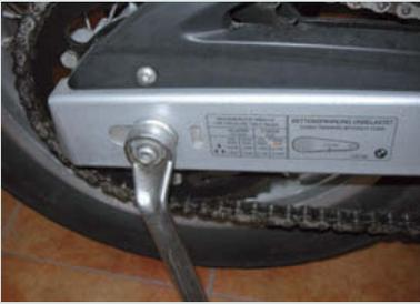
↑ **Figura 1.55.** Extracción de la tuerca del eje de la rueda trasera.
