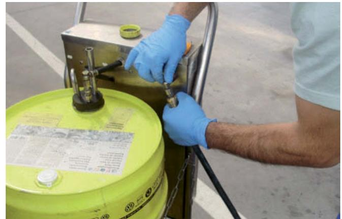
↑ **Figura 9.8.** Conexión con la manguera de aire a presión del taller.
