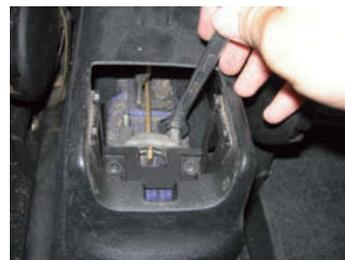
↑ **Figura 12.14.** Reglaje del freno de estacionamiento mecánico
