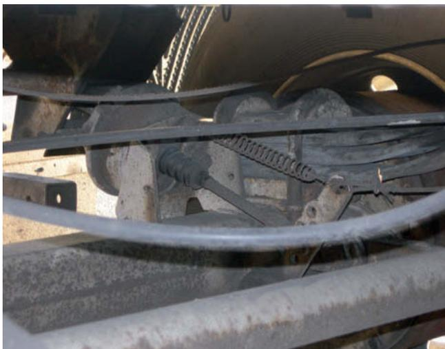
↑ Cabeza tractora y elementos del sistema de freno de la plataforma corridos.
