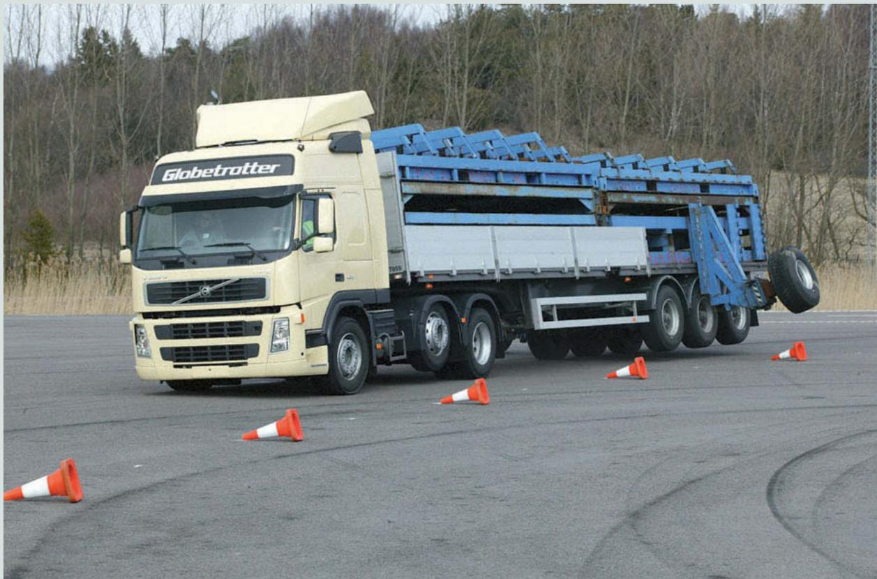
↑ **Figura 11.63.** Prueba del sistema ESP montado en un tráiler en un circuito de pruebas.
