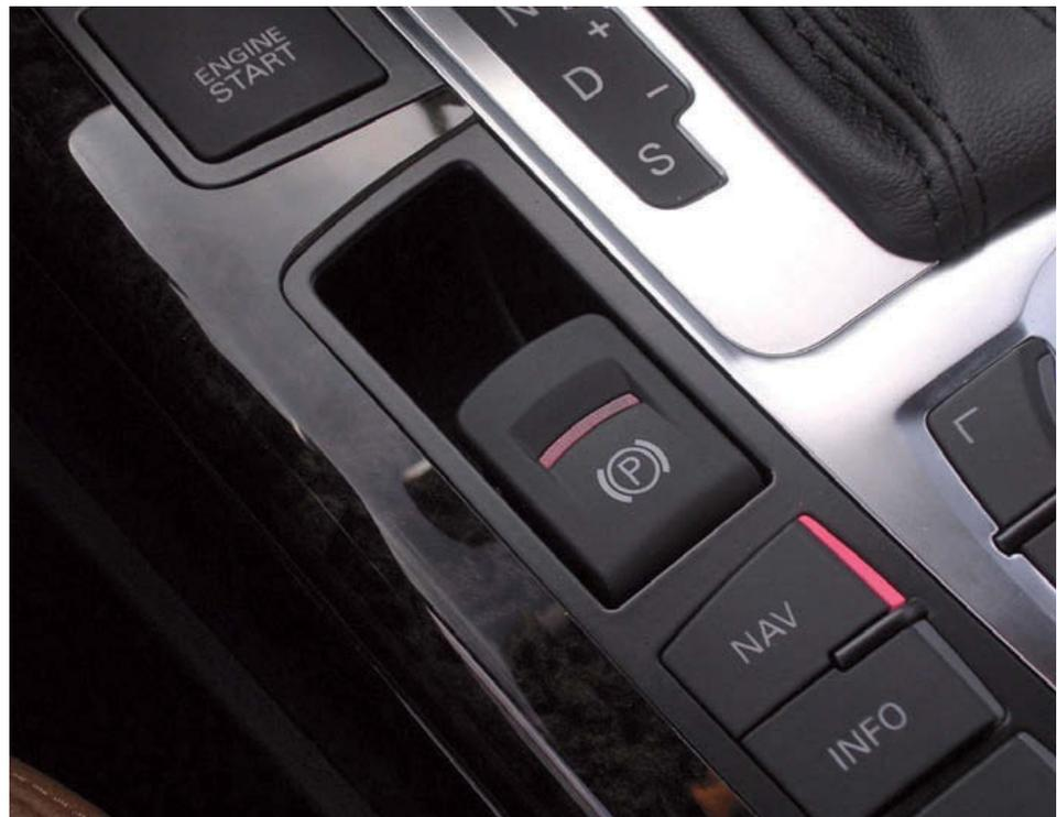
↑ **Figura 12.2.** Botón de accionamiento del freno de estacionamiento eléctrico.
