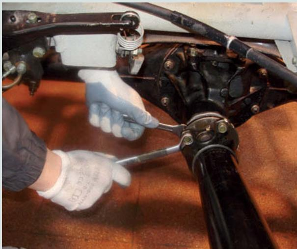
↑ **Figura 5.50.** Desmontar el árbol de transmisión del puente.
