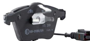
↑ **Figura 9.23.** Pastilla de freno nueva con testigo de desgaste.
