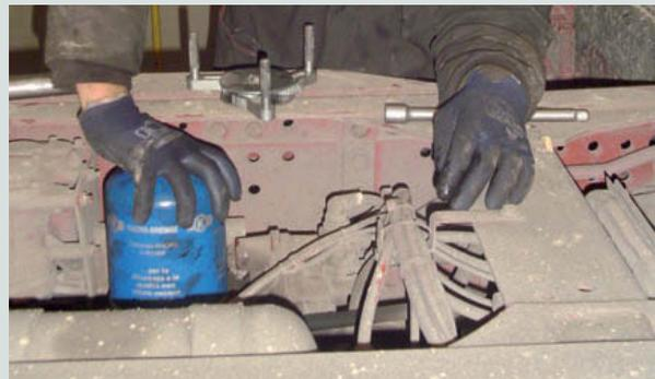
↑ Figura 11.60. Desmontaje del filtro.
