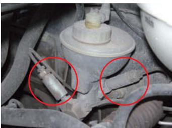
↑ **Figura 8.90.** Válvulas compensadoras en función de la presión montadas a la salida de la bomba.
