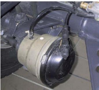
↑ **Figura 11.25.** Convertidor neumohidráulico.
