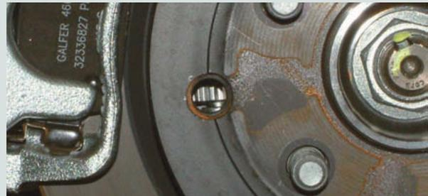
↑ Figura 12.42. Dispositivo de ajuste de las zapatas.
