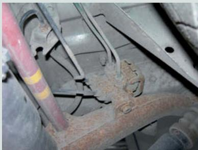
↑ **Figura 7.28.** Corrector de frenado para el eje trasero.
