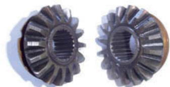
↑ **Figura 5.16.** Piñones planetarios con eje ranurado.
