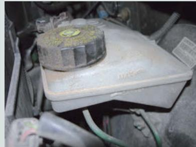
↑ **Figura 7.26.** Bomba de freno con depósito de líquido.
