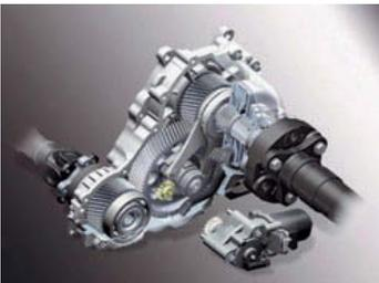
↑ Figura 6.12. Acoplamiento tipo X-Drive con piñones.
