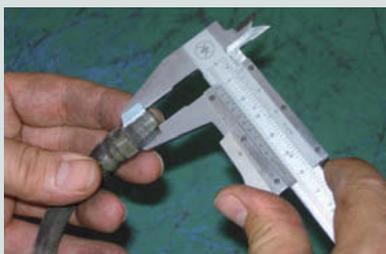
↑ **Figura 8.118.** Analizar el tipo de rosca del latiguillo.
