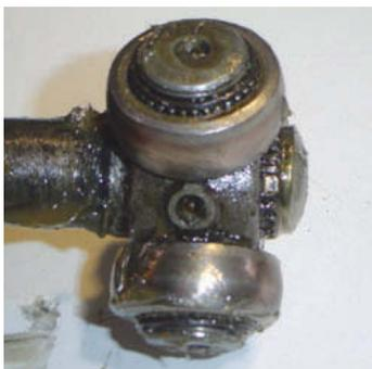
↑ **Figura 6.45.** Junta deslizante de trípode.
