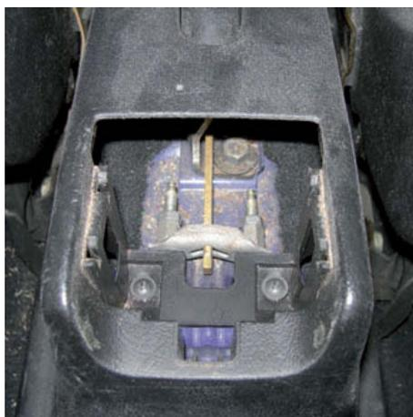
↑ **Figura 9.37.** Mecanismo de tensado del cable del freno de estacionamiento.
