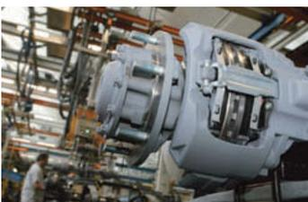
↑ **Figura 11.2.** Freno de disco de un camión.
