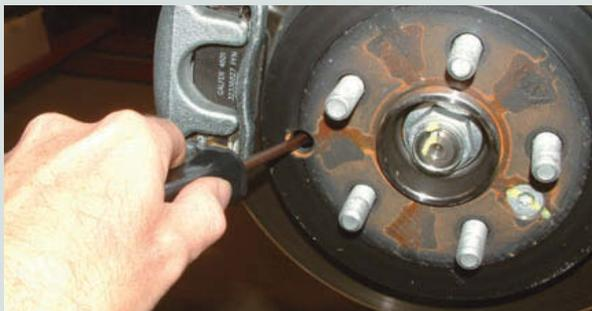
↑ Figura 12.43. Ajuste de las zapatas con el destornillador.
