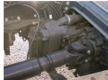
↑ **Figura 11.34.** Montaje del retardador hidrodinámico en el vehículo.
