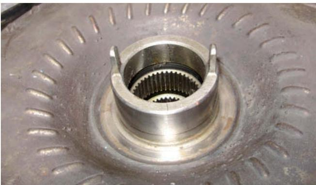
↑ **Figura 2.51.** Orejetas de accionamiento de la bomba.
