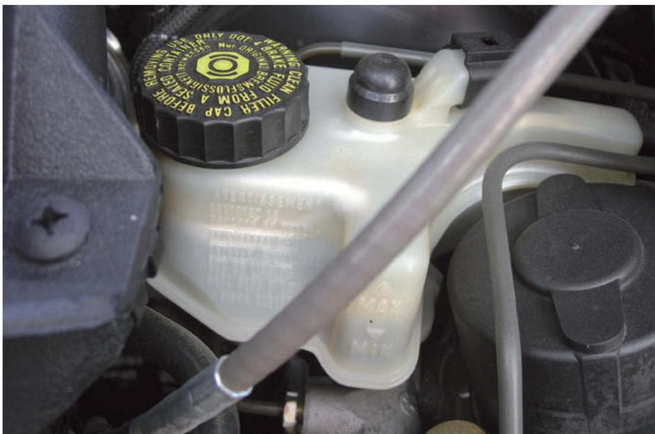
↑ **Figura 9.2.** Depósito de líquido de frenos. Nivel máximo (MAX) y mínimo (MIN).
