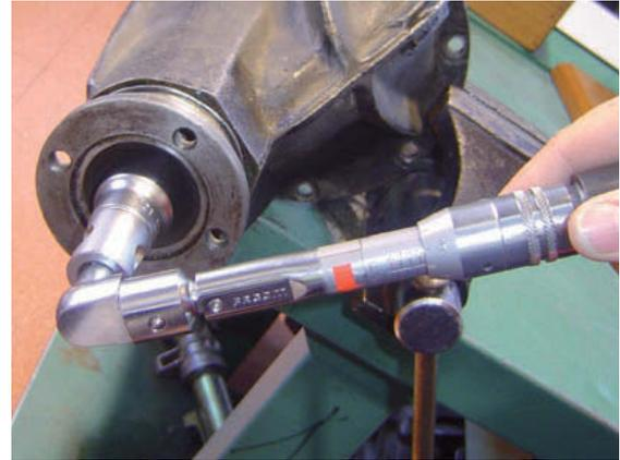
↑ Figura 5.41. Verificación del esfuerzo de rotación del piñón de ataque.
