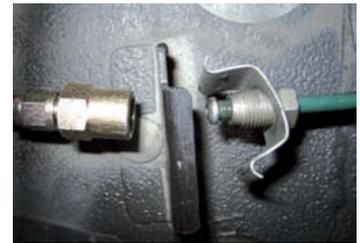
↑ Figura 8.91. Unión entre canalización flexible y rígida.
