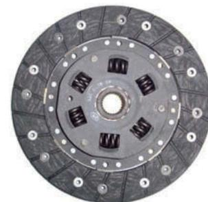
↑ **Figura 2.11.** Disco de embrague con muelles de progresión y ferodo remachado.
