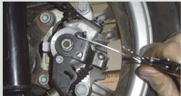
↑ **Figura 12.40.** Medición de la cota de ajuste.
