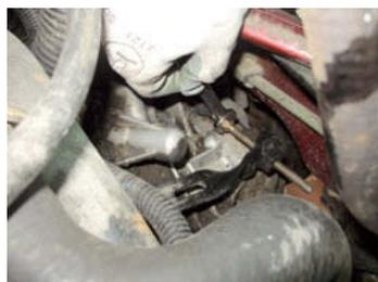
↑ **Figura 2.40.** Reglaje del cable de embrague.
