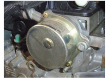
↑ **Figura 8.77.** Bomba de vacío para motores diésel.
