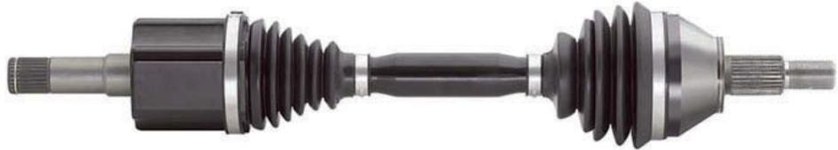
↑ **Figura 6.41.** Transmisión delantera con trípode en el lado motor y Rzeppa en rueda.
