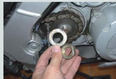
↑ **Figura 1.54.** Extracción de la tuerca y de la chapa de retención.
