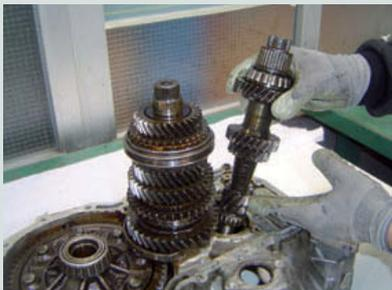
↑ **Figura 3.92.** Desmontaje de los ejes.
