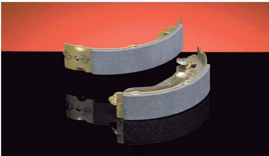
↑ **Figura 8.6.** Zapatas de freno con forro pegado.
