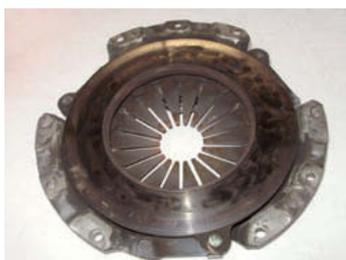
↑ **Figura 2.47.** Maza de presión con zonas desgastadas y recalentadas.
