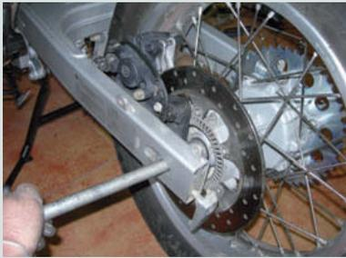
↑ **Figura 1.73.** Montaje del eje de la rueda.
