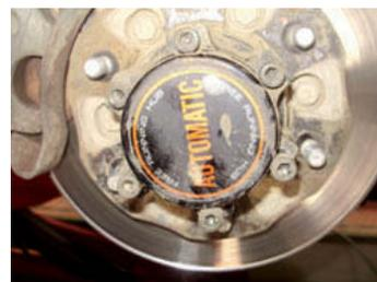
↑ **Figura 6.7.** Acoplamiento 4x4 en las ruedas delanteras.
