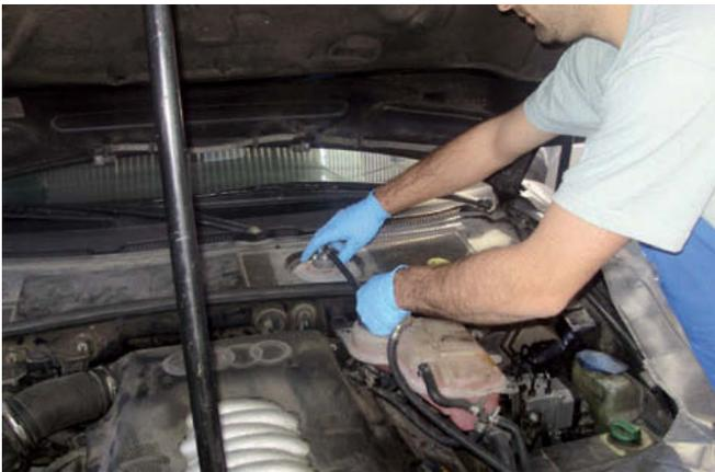
↑ **Figura 9.7.** Montaje del tapón del equipo en el depósito de líquido del vehículo.
