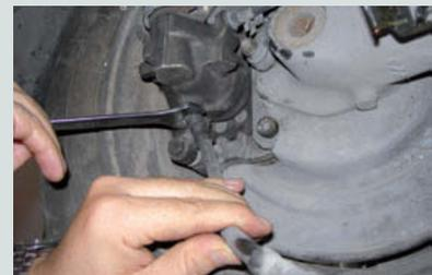
↑ **Figura 8.117.** Aflojar el extremo opuesto del latiguillo.
