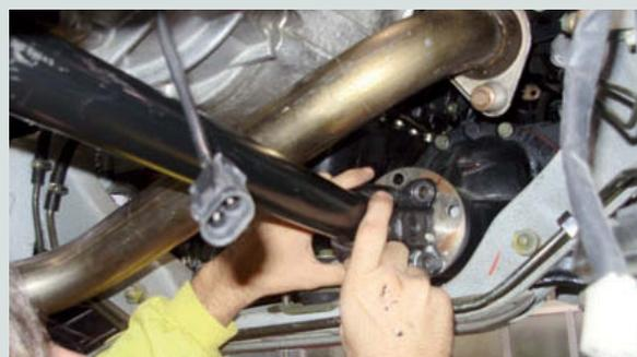
↑ **Figura 2.75.** Desmontar la transmisión delantera.
