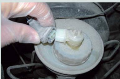
↑ **Figura 8.105.** Extracción de la conexión eléctrica.
