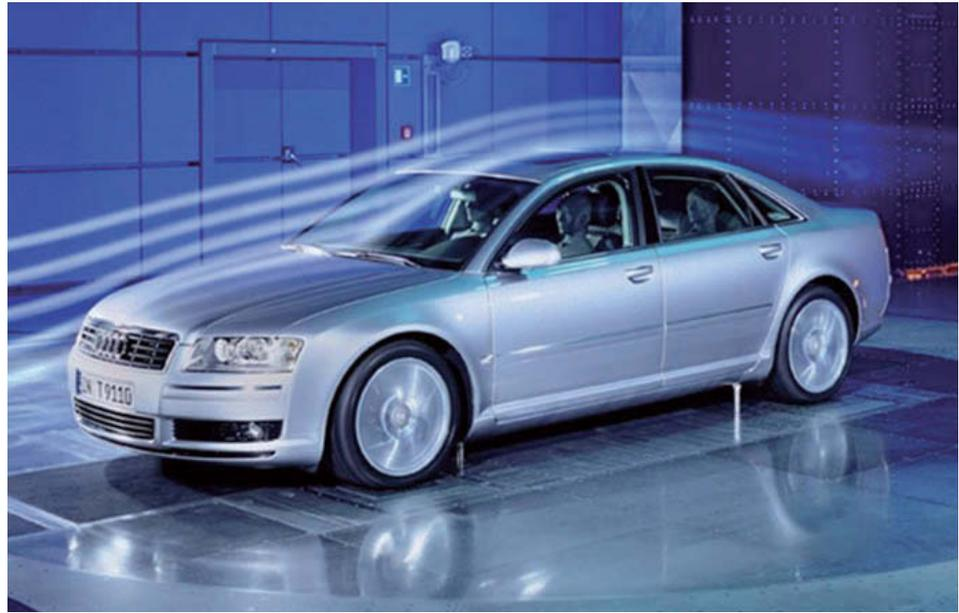
↑ **Figura 1.5.** Prueba en túnel de viento del  $c_x$  de un Audi A8.
