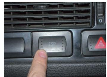
↑ **Figura 10.45.** Botón de desconexión del ESP
