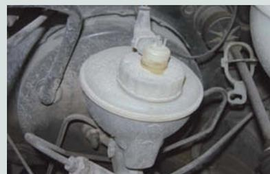
↑ Figura 9.60. Verificado del nivel del líquido de frenos.
