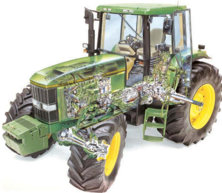
↑ **Figura 1.24.** Transmisión 4x4 de un tractor agrícola.
