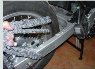
↑ **Figura 1.75.** Montaje de la cadena nueva.
