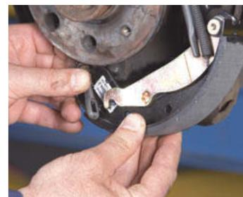
↑ **Figura 12.3.** Conexión del cable del freno de estacionamiento con la palanca de accionamiento de la zapata.
