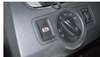
↑ **Figura 12.17.** Pulsador del freno de estacionamiento electromecánico.
