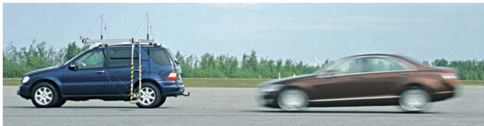
↑ **Figura 7.11.** Basculación del vehículo en una frenada de emergencia.
