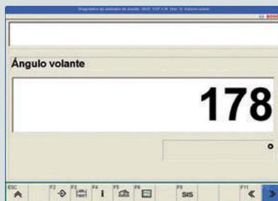
↑ **Figura 10.72.** Posición del volante (girado a 178°).
