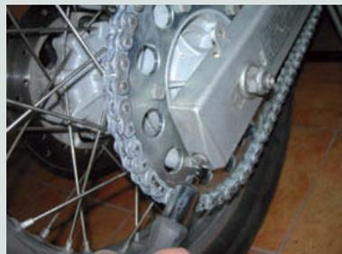
↑ **Figura 1.80.** Centrado de la rueda y tensado de la cadena.
