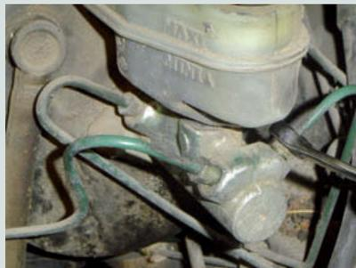
↑ **Figura 8.111.** Aflojar los rácores de conexión.
