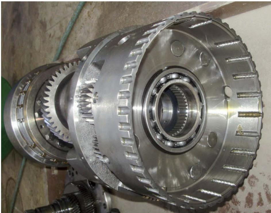
↑ **Figura 4.72.** Componentes mecánicos de un cambio automático.
