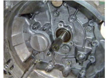
↑ **Figura 3.51.** Retén del eje primario.
