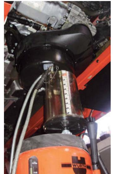
↑ Figura 3.69. Vaciado del aceite del cambio.
