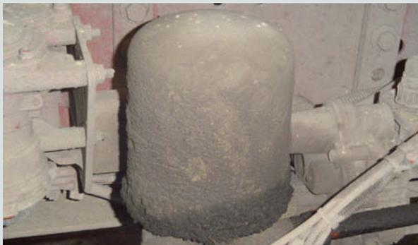
↑ Figura 11.59. Filtro secador a sustituir
