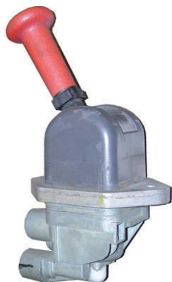
↑ **Figura 12.30.** Válvula de freno de estacionamiento.
