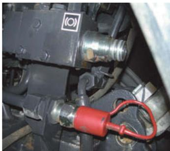
↑ **Figura 11.53.** Salida de presión para el freno de remolque.
