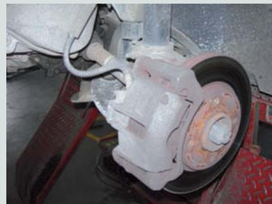
↑ **Figura 7.29.** Pinza de freno con pastillas.
