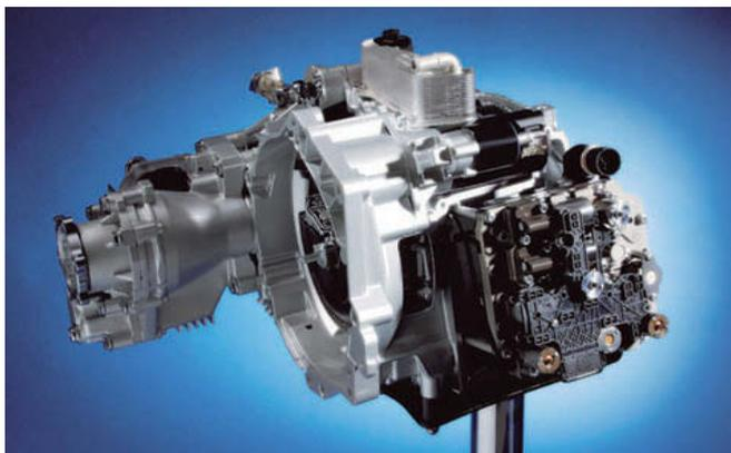
↑ **Figura 3.23.** Caja de cambios para tracción delantera.
