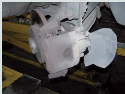
↑ **Figura 8.103.** Freno de disco: Pinza con pastillas.
