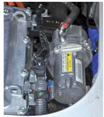
↑ **Figura 8.79.** Bomba de vacío eléctrica.
