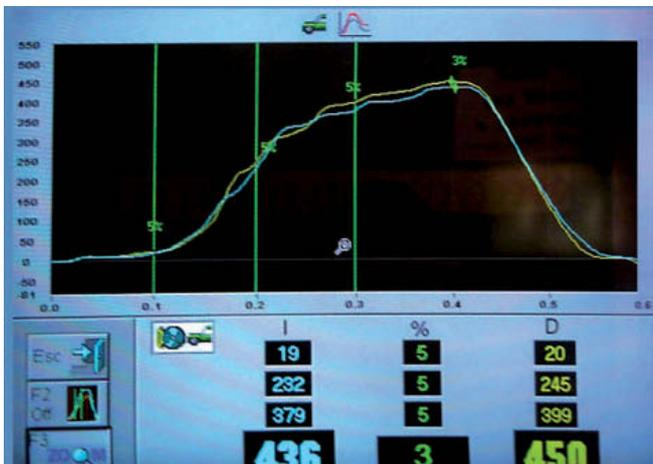
↑ **Figura 9.42.** Gráfica de frenado con diferencia entre ruedas de un mismo eje.
