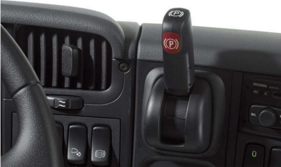
↑ **Figura 12.27.** Palanca de accionamiento del freno de estacionamiento en el panel de mandos.
