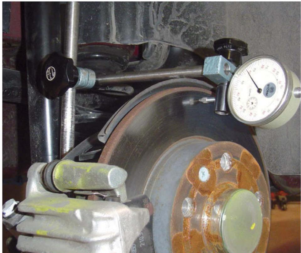
↑ **Figura 9.28.** Verificación del alabeo del disco con reloj comparador.
