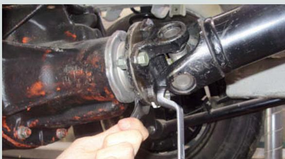
↑ **Figura 2.74.** Aflojar los tornillos de la junta al grupo.
