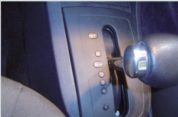
↑ Figura 4.74. Palanca selectora.
