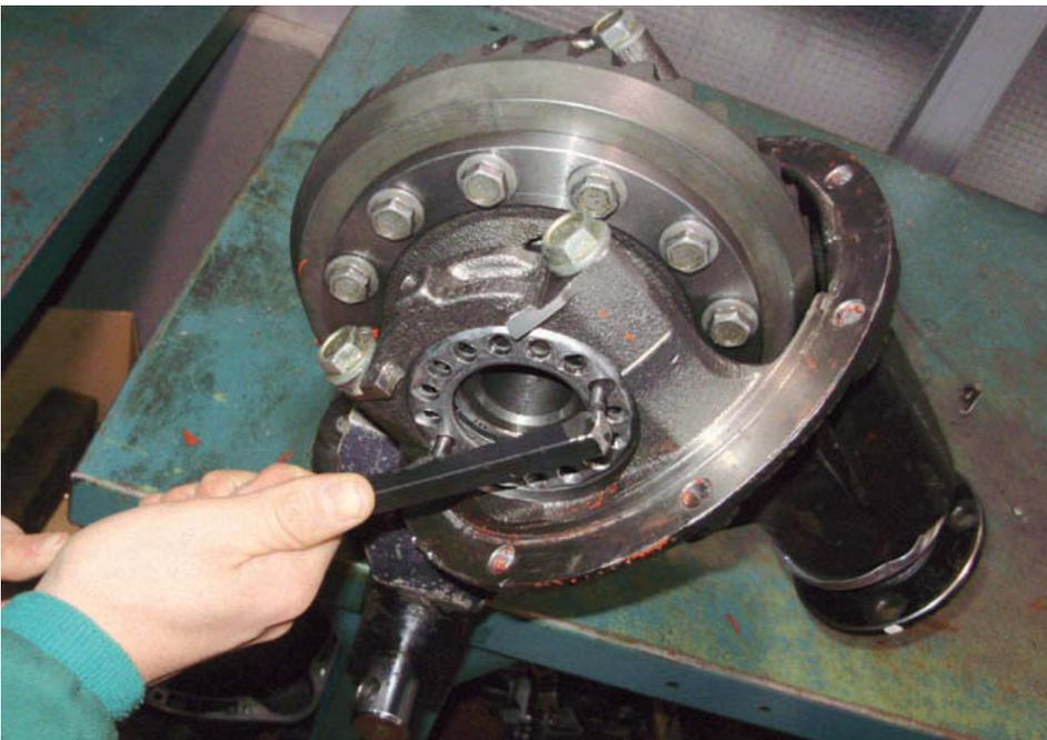
↑ **Figura 5.45.** Tuerca perforada para el empleo del útil de apriete.
