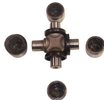
↑ **Figura 6.38.** Despiece de una cruceta de una junta cardán.
