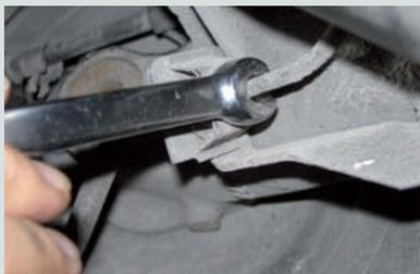
↑ **Figura 8.115.** Aflojar la tuerca de fijación del latiguillo.
