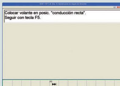
↑ **Figura 10.91.** Colocación del volante en posición de línea recta.
