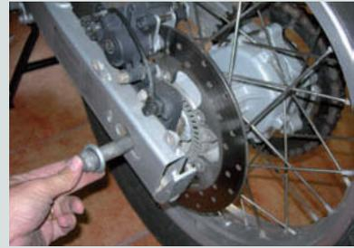
↑ **Figura 1.57.** Extracción del eje de la rueda.
