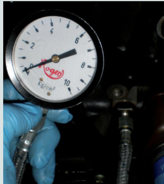
↑ Figura 15.17. Manómetro conectado.
