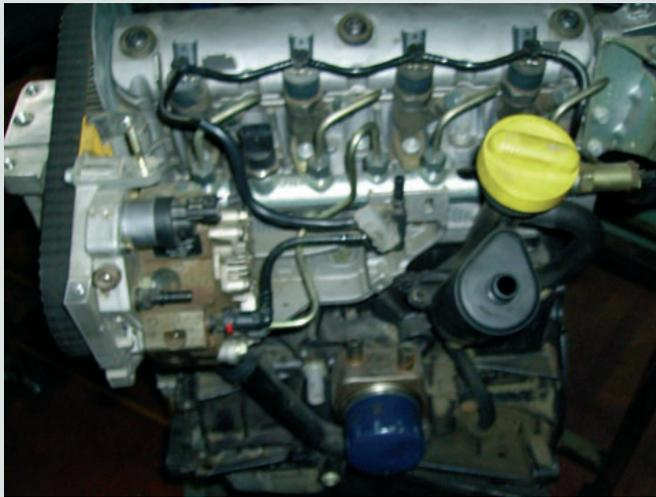
↑ Figura 3.30. Elementos del sistema de inyección.
