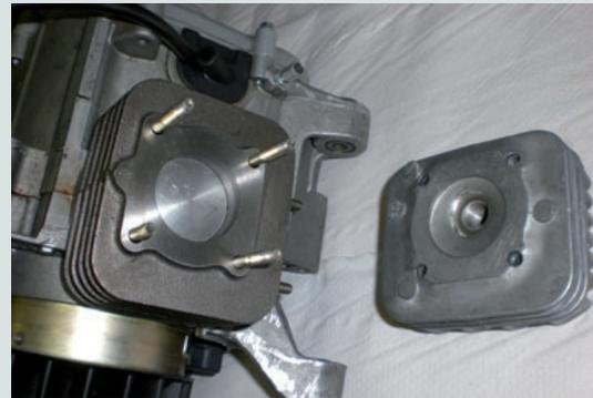
↑ **Figura 18.32.** Desmontaje de la culata.
