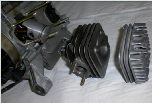
↑ **Figura 18.33.** Desmontaje del cilindro.
