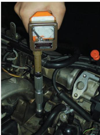
↑ **Figura 13.3.** Aplicación del compresógrafo.
