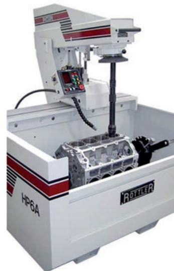
↑ Figura 13.43. Rectificadora de cilindros.
