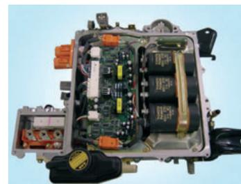
↑ Figura 20.5. Inversor convertidor.
