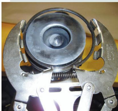
↑ **Figura 12.49.** Desmontaje de segmentos.
