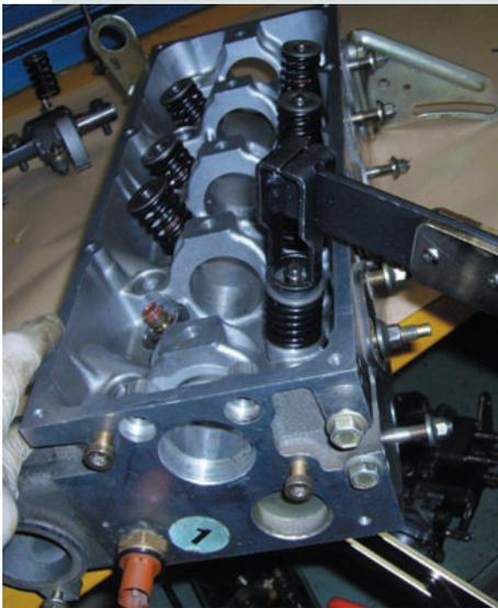
↑ Figura 10.44. Desmontaje de válvulas.
