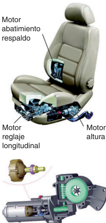
↑ Figura 9.51. Sección de asiento eléctrico y motor de accionamiento.
