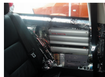
↑ Figura 6.13. Insonorización de la parte trasera de un vehículo y refuerzo de la chapa.
