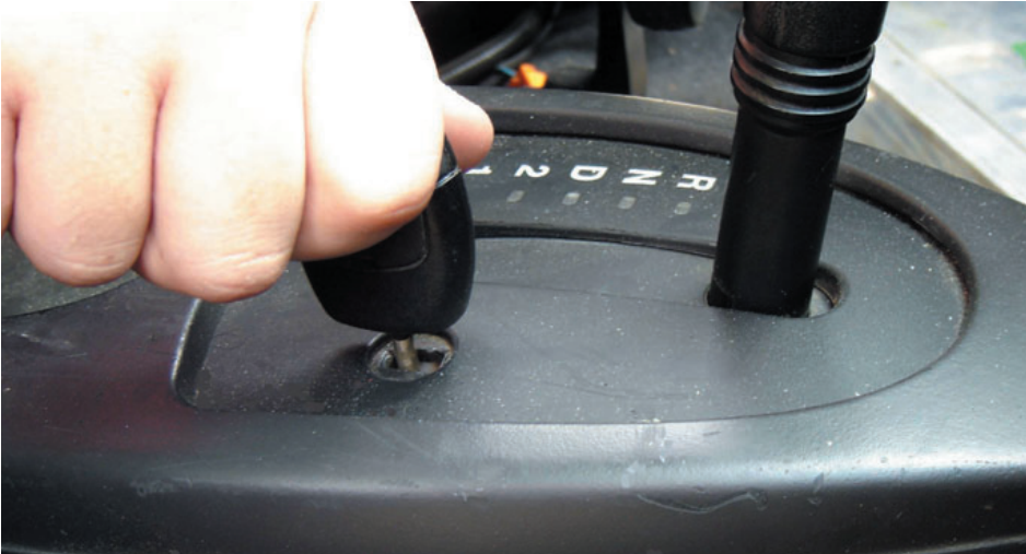
↑ Figura 7.16. Desconexión mediante llave.
