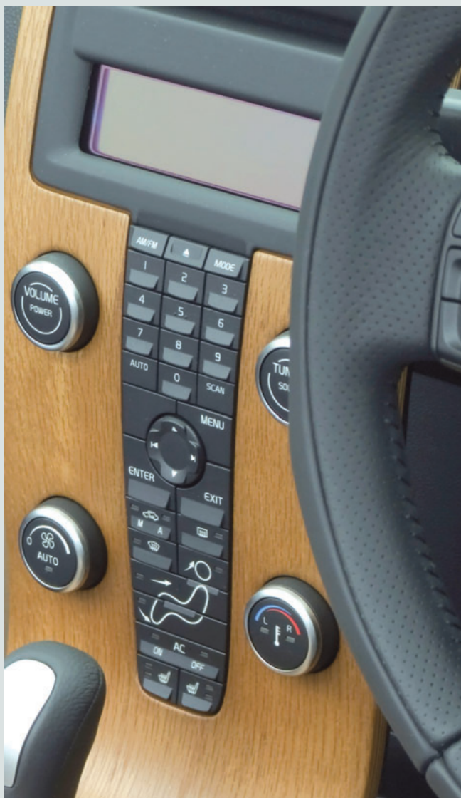
↑ Figura 4.27. Panel de mandos de climatizador.
