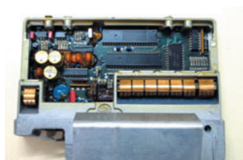
↑ Figura 4.7. Interior de unidad de control.
