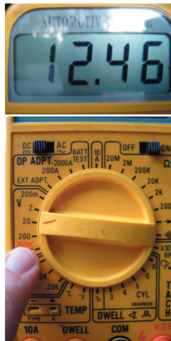
↑ Figura 6.24. Polímetro en posición de voltios. Tensión de batería.
