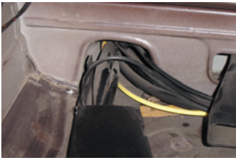
↑ Figura 6.5. Trazado de los cables por el interior del vehículo.
