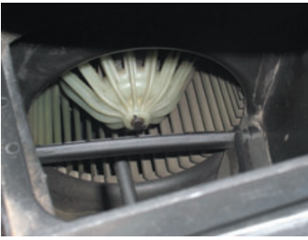
↑ Figura 1.6. Ventilador de turbina.
