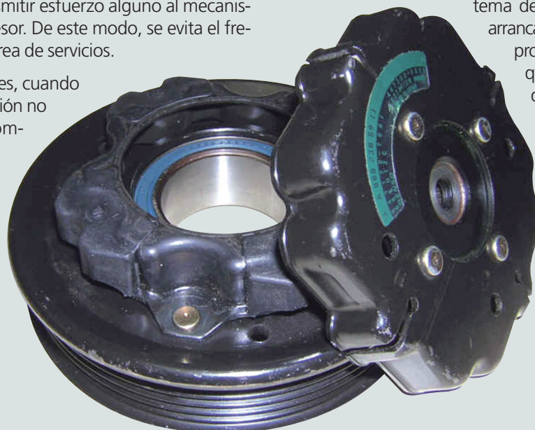
↑ Figura 2.48. Elemento de goma deformable.
