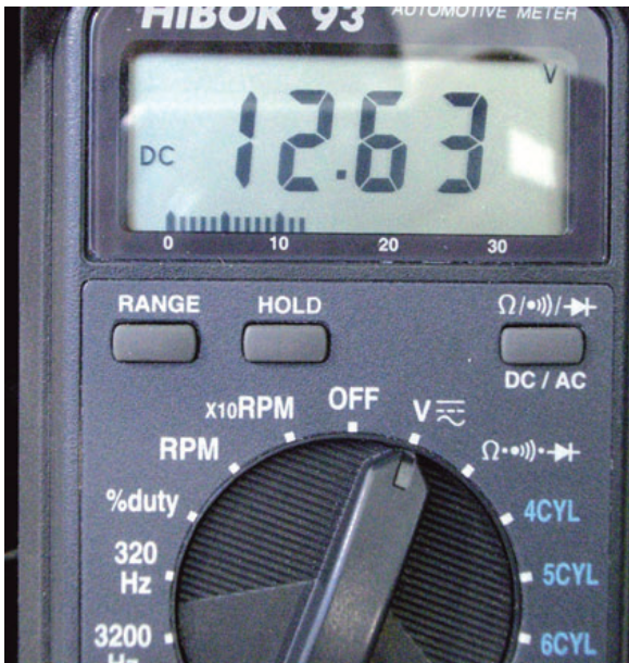
↑ Figura 3.22. Tensión de alimentación del compresor.
